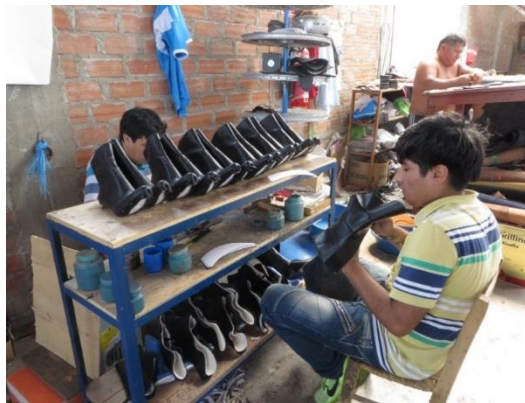
Figura N° 08: Etapa de perfilado y armado
