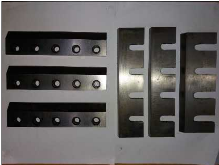
Figura n°. 3-15. Cuchillas de molinos de bordes con filo desgastado debido a recalentamiento.
