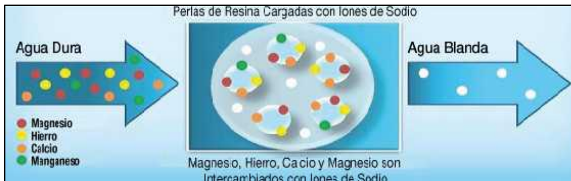
Figura nº. 2-1. Descalsificador de intercambio iónico.
