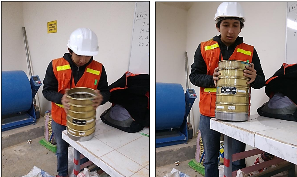
Fotografía 04: Análisis Granulometría del Agregado Grueso
