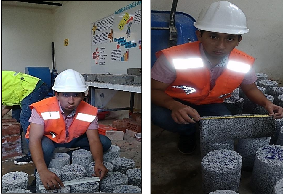
Fotografía 13: Toma de datos de las dimensiones de los especímenes.
