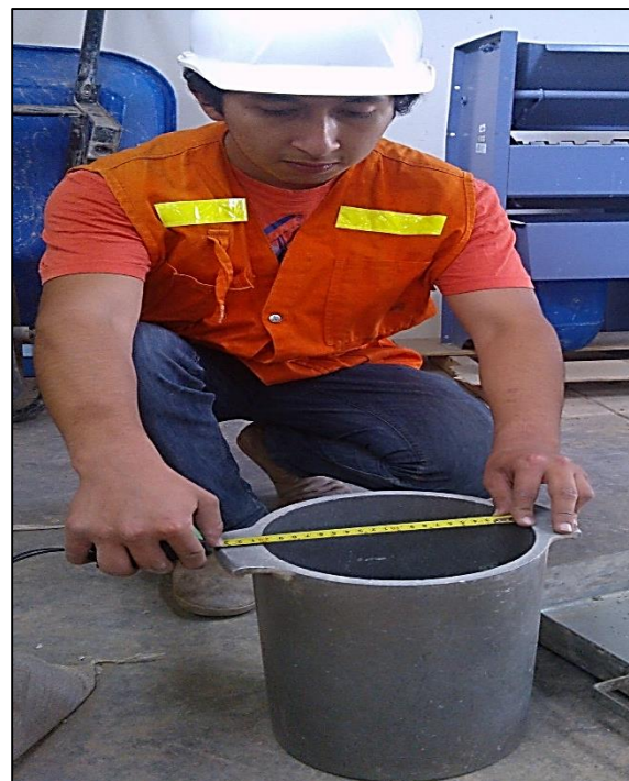
Fotografía 06: Ensayo para el Peso Unitario Compactado del Agregado Grueso
