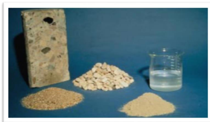
Figura N° 01: Componentes del concreto
