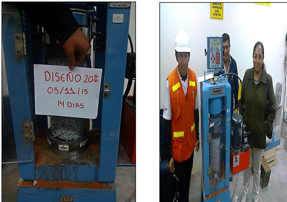
Fotografía 14: Ensayo a la resistencia a la compresión del concreto permeable.
