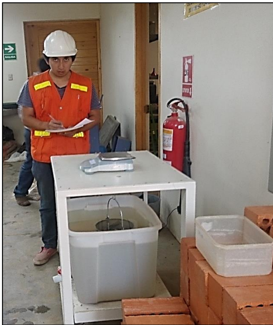
Fotografía 05: Ensayo para el Peso Específico del Agregado Grueso
