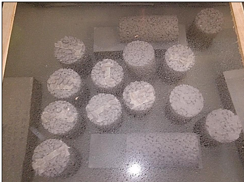
Fotografía 12: Curado de especímenes en la poza.
