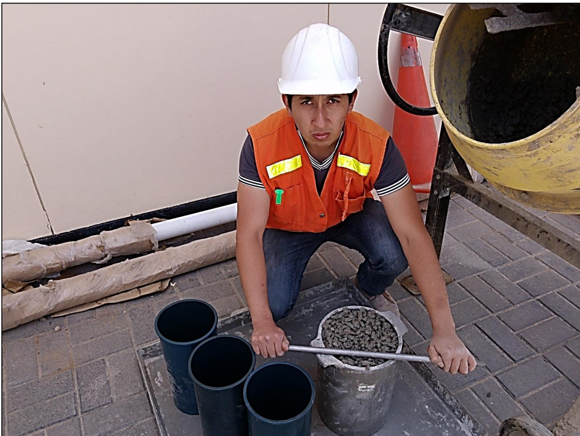
Fotografía 10: Ensayo Peso Unitario y Contenido de Aire
