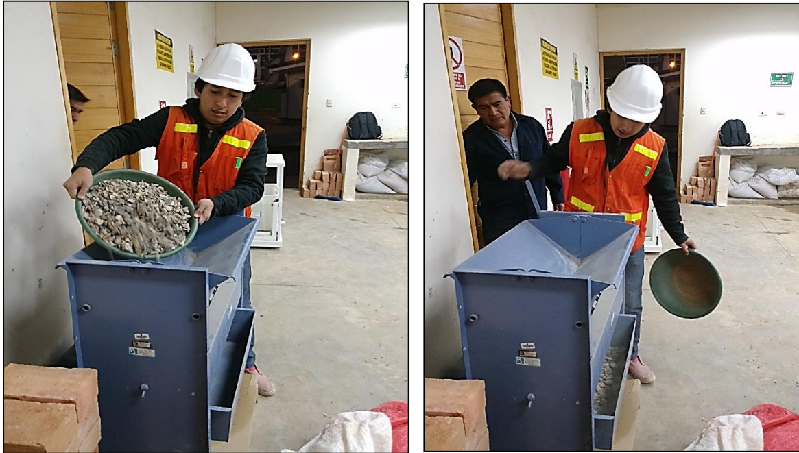
Fotografía 03: Cuarteando el material extraído de las canteras
