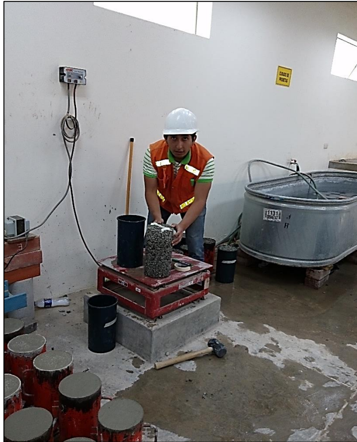
Fotografía 11: Desencofrado de los especímenes.
