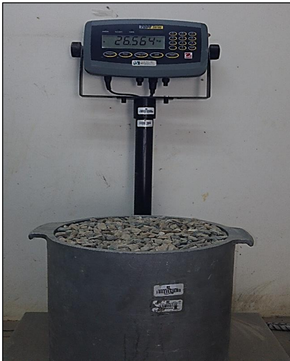
Fotografía 06: Ensayo para el Peso Unitario Compactado del Agregado Grueso
