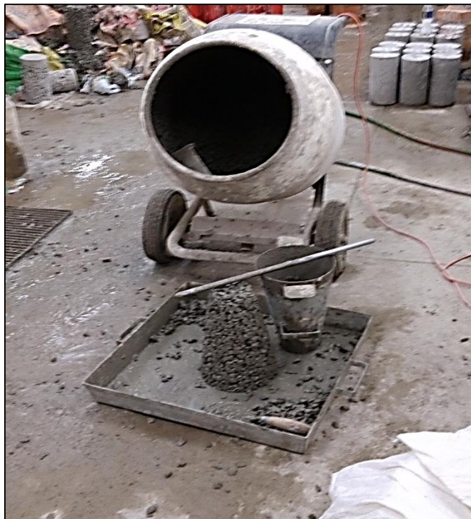
Fotografía 08: Ensayo para medir el asentamiento del concreto o slump.
