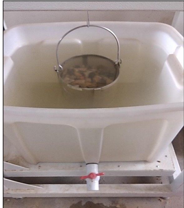
Fotografía 05: Ensayo para el Peso Específico del Agregado Grueso
