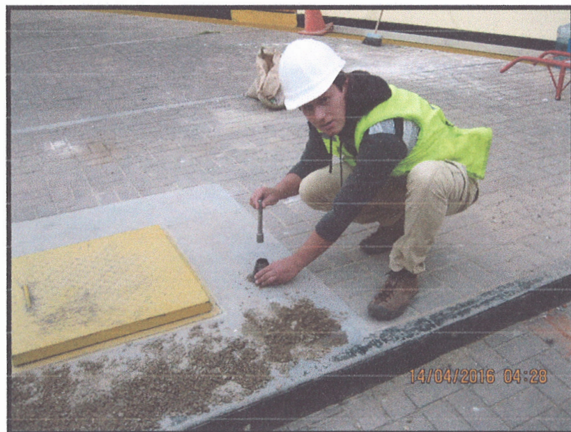
Foto n°10: Ensayo de peso específico – comprobación del material para estar en el estado superficialmente seco.
