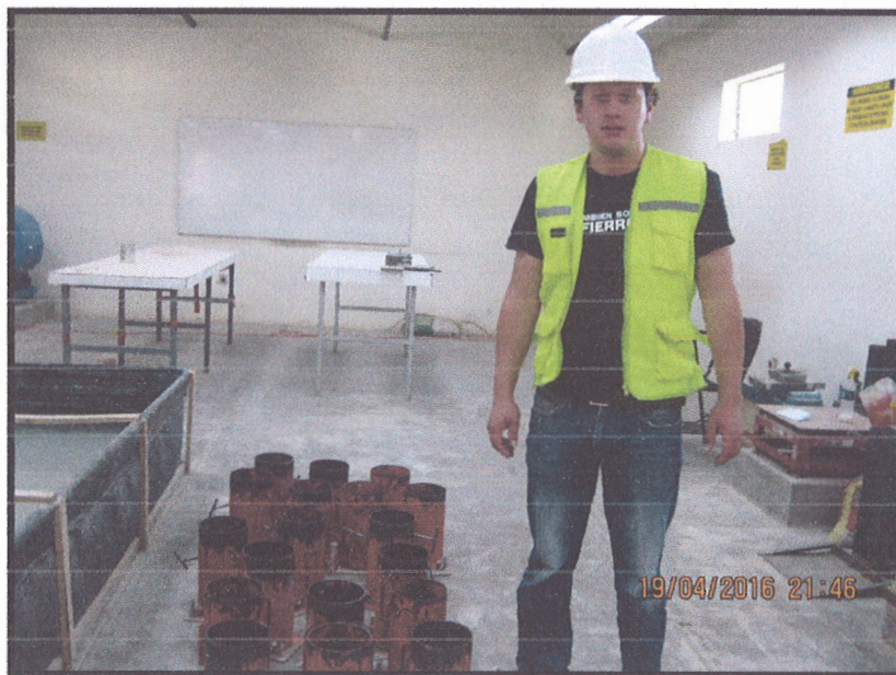
Foto n°22: Moldes listos para empezar muestreo de especímenes de concreto en laboratorio, con los distintos tipos de agua seleccionados en tesis.
