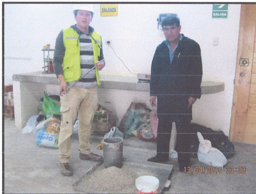
Foto n°04: Técnico en laboratorio de la Universidad privada del norte, realizando el ensayo de peso unitario seco compactado del agregado fino.
