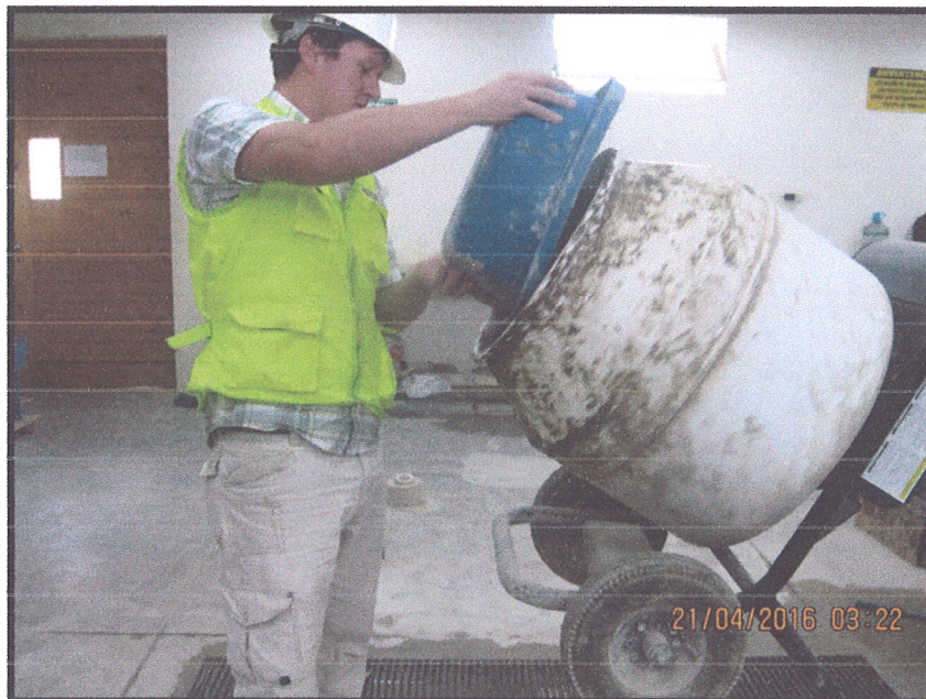
Foto n°28: Mezclado de concreto para, elaboración de concreto de especímenes.
