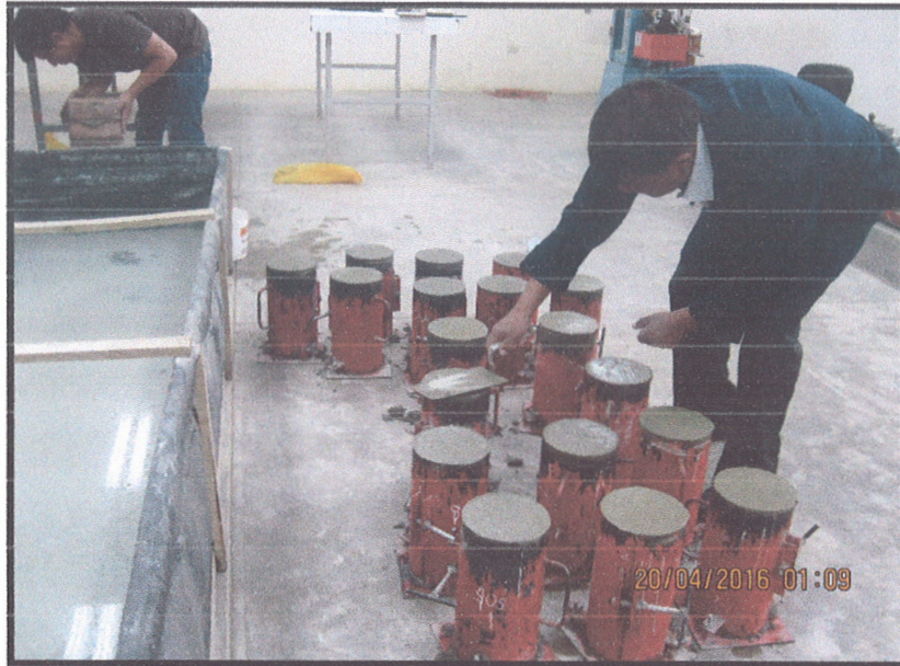
Foto n°25: Terminado de probetas de concreto en laboratorio.
