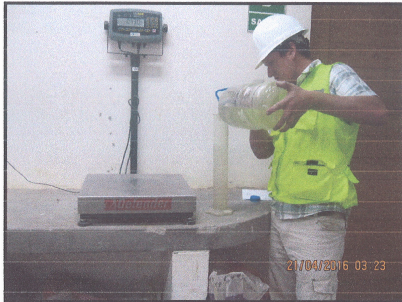
Foto n°29: Medición de agua para elaboración de especímenes.
