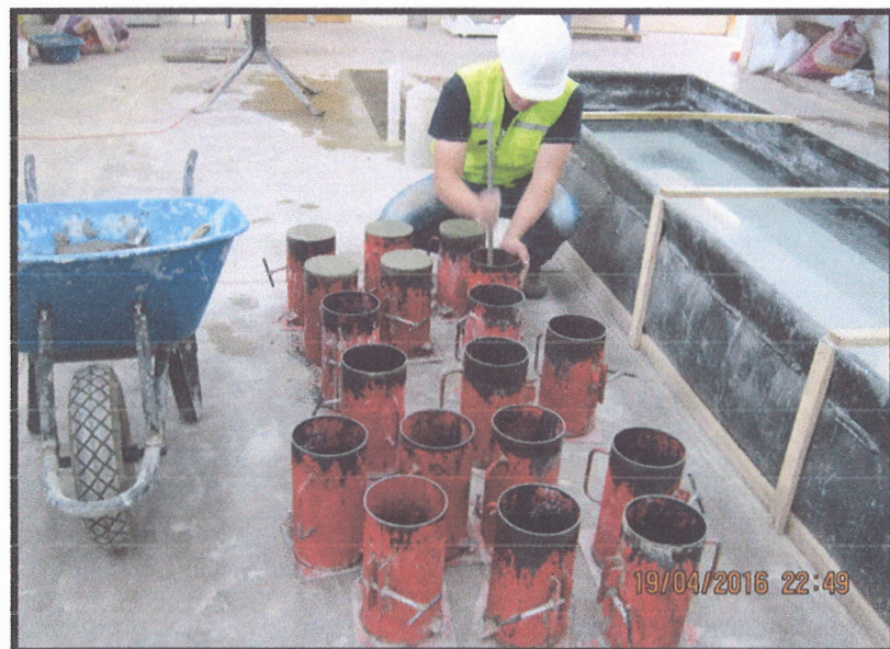
Foto n°24: Elaboración de especímenes para de concreto en laboratorio.
