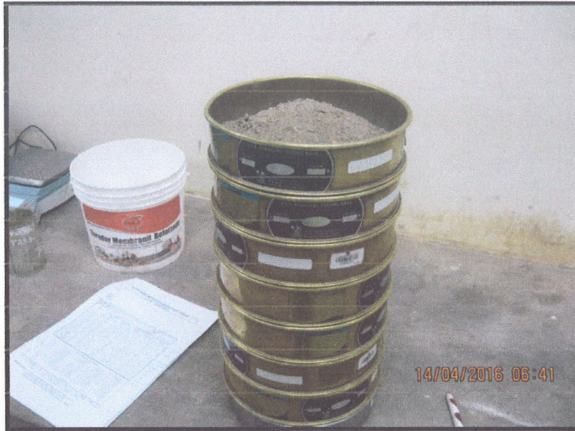
Foto n°15: Análisis granulométrico del agregado fino
