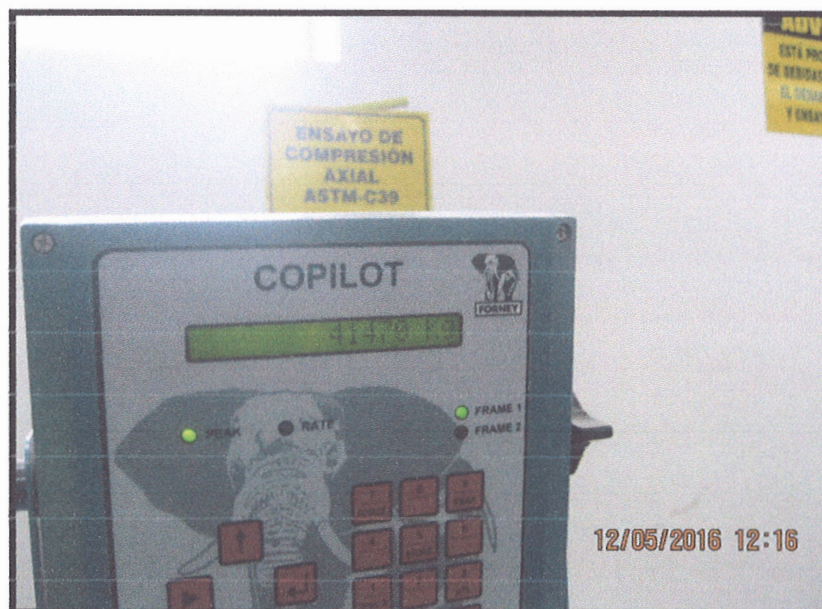
Foto n°38: Ruptura de probetas a los 14 días.
