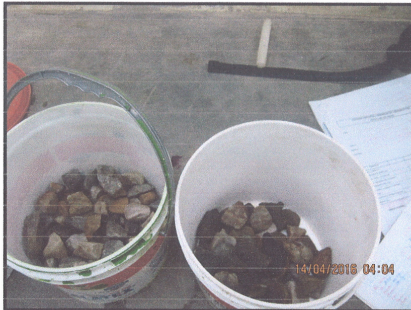
Foto n°07: Secado del agregado grueso, después de 24 horas de saturación para ensayo de peso específico (sss). Estado superficialmente seco.
