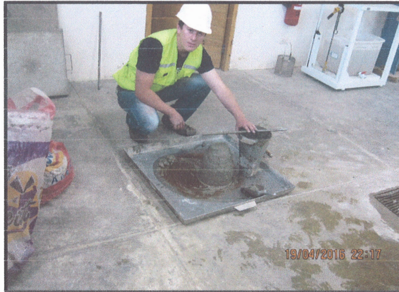
Foto n°23: Ensayo de asentamiento del concreto para verificar diseño realizado.
