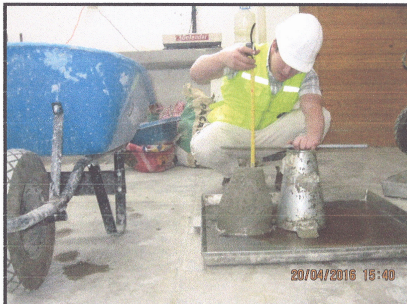
Foto n°32: Medida del asentamiento.
