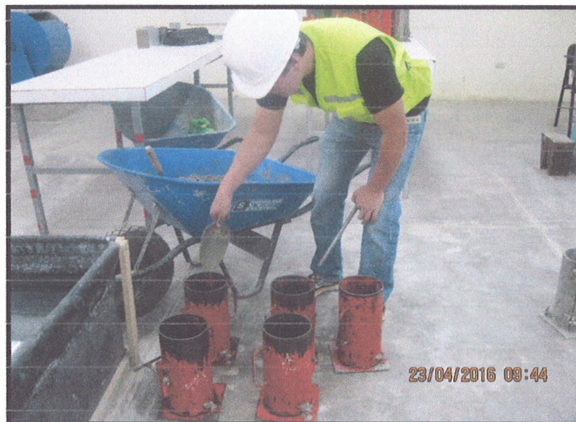
Foto n°36: Elaboración de especímenes para 28 días.
