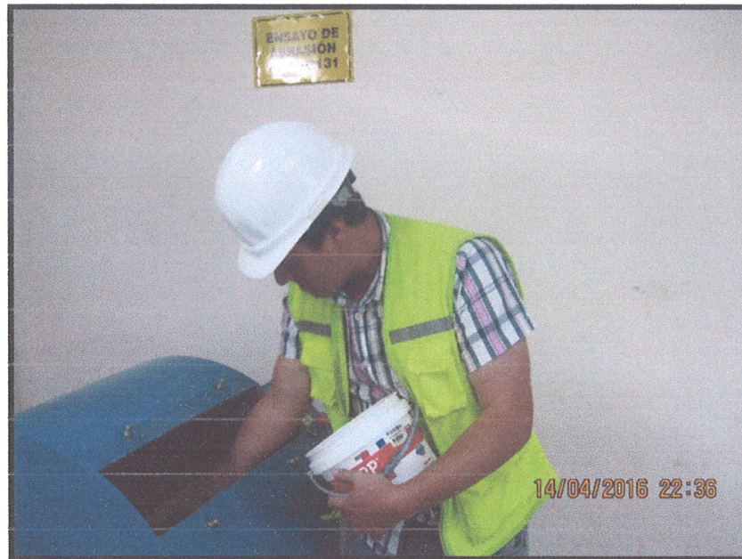
Foto n°17: Ensayo de abrasión del agregado grueso en la máquina de los ángeles de la universidad privada del norte
