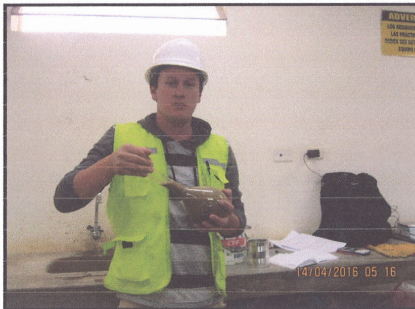
Foto n°12: Ensayo de peso específico en fiola, en el cual calculamos la cantidad de materia orgánica con la muestra que se tiene, secando la muestra en el horno.
