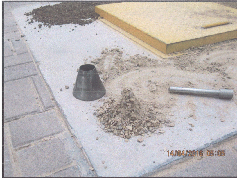
Foto n°11: Estado superficialmente seco – para peso específico del material fino.
