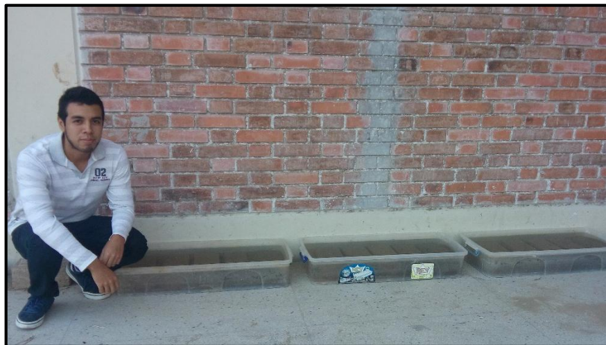
Figura 6.13: Adobes bajo agua durante 7 días Fuente: Elaboración propia
