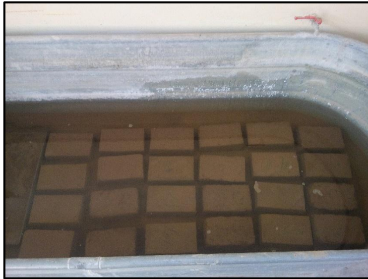
Figura 6.12: Adobes en estado de saturación en agua Fuente: Elaboración propia
