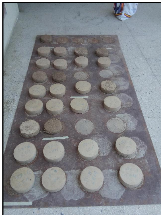
Figura 6.9: Elaboración de discos de suelo con cemento a diferentes porcentajes Fuente: Elaboración propia
