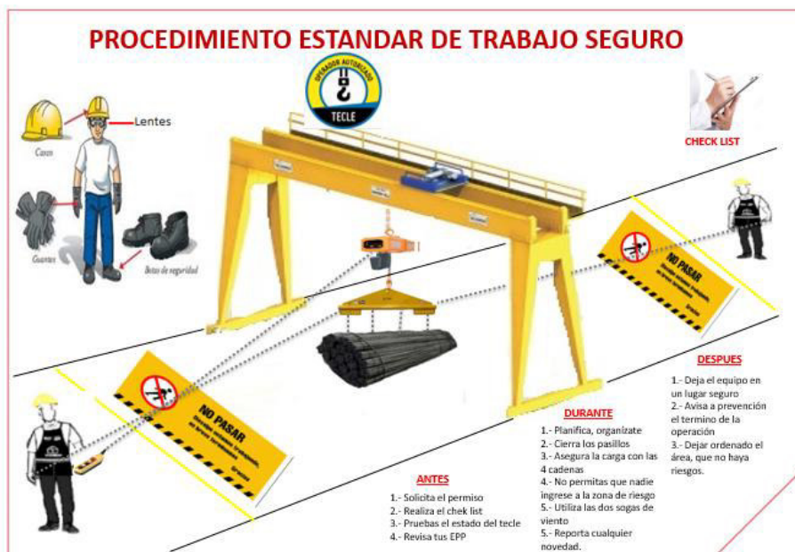
Figura n.º 3-15. Ilustración de los trabajos y las medidas de seguridad con el tecele eléctrico
