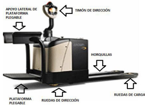
Figura n.º 3-10. Imagen de Transpaleta eléctrica P20/LPE 200 con mención de sus principales partes.
