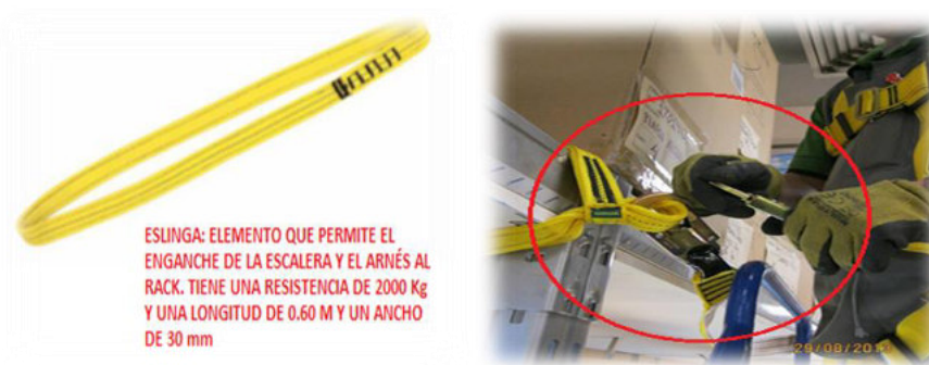
Figura n.º 3-6. Imagen de modelo de eslinga de enganche y forma de usarla en operaciones con escalera tipo avión.
