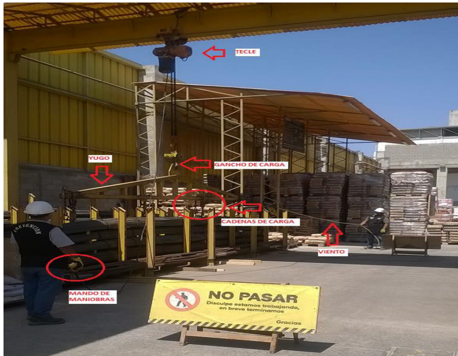
Figura n.º 3-14. Imagen del tecele eléctrico y sus partes importantes.
