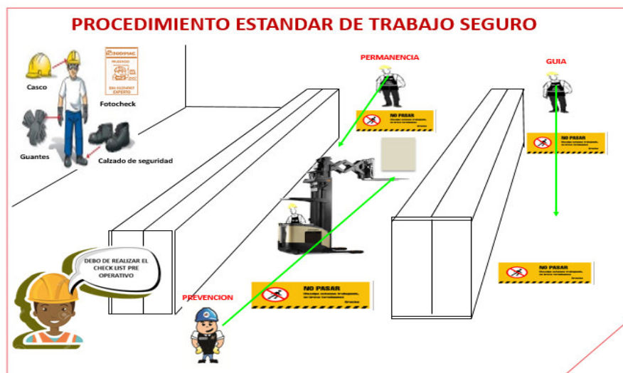
Figura n.º 3-12. Ilustración de los trabajos y las medidas de seguridad con equipos logísticos motorizados en sala de ventas.
