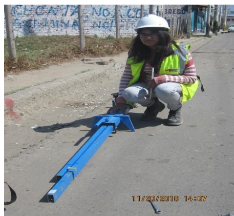
Figura N°. 6: Viga Benkelman (Laboratorio U.T.P.L)
