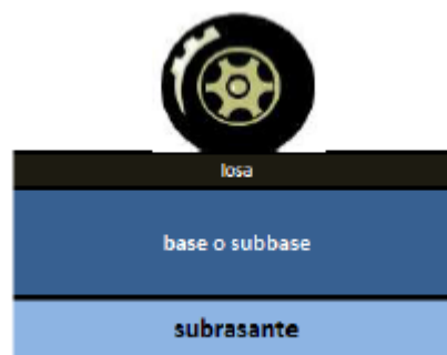
Figura N°. 2: Esquema típico del paquete estructural de un pavimento
