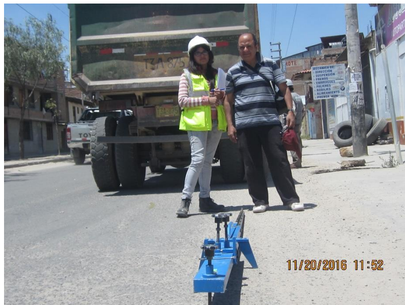
Figura N°. 46: Realizando la medida de un punto de la carretera con la Viga Benkelman
