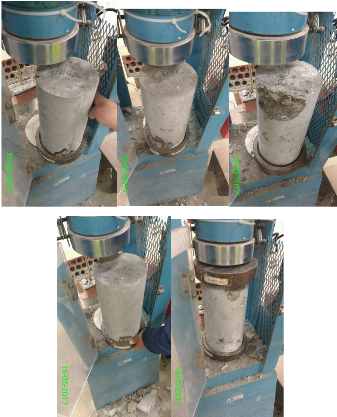
Fotografía N° 38: Probetas cilíndricas ensayadas a compresión axial
