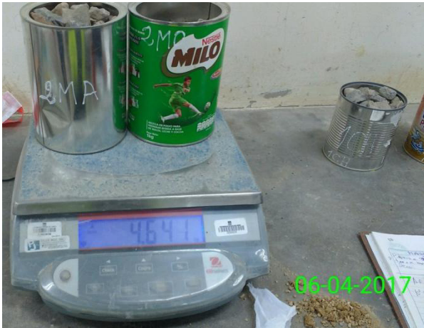
Fotografía N°8: Contenido de humedad agregado grueso, cantera Mashcón - Peso de la muestra seca
