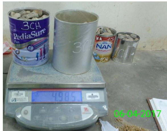
Fotografía N°6: Contenido de humedad agregado grueso, cantera Chonta - Peso de la muestra seca
