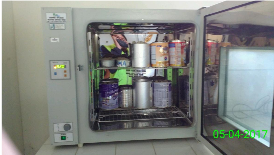
Fotografía N°5: Contenido de humedad agregado grueso, cantera Chonta- Muestra húmeda colocada en el horno
