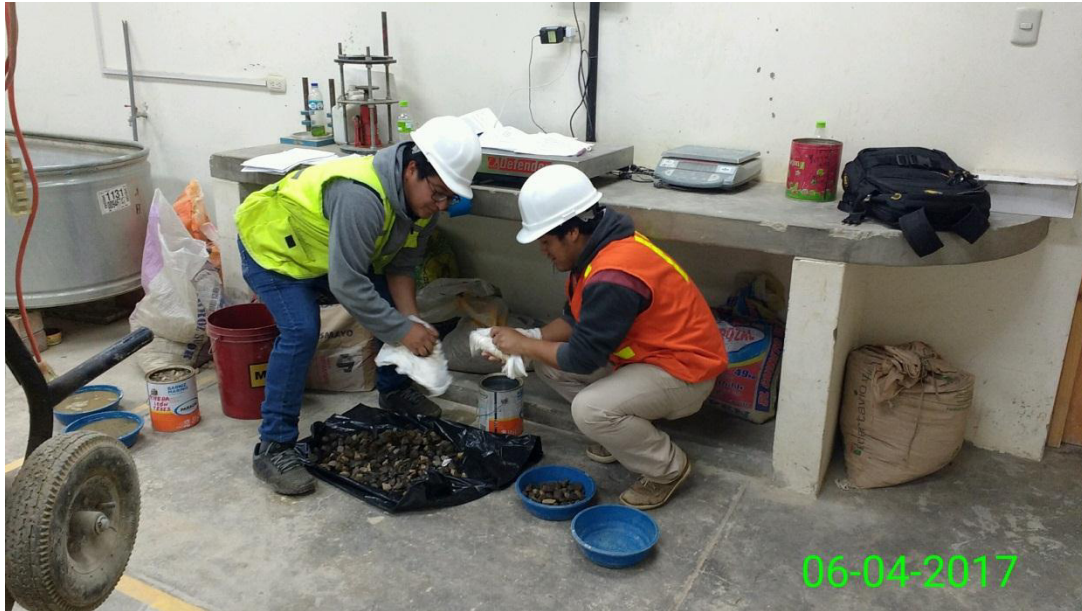
Fotografía N° 12: Peso específico de agregados grueso- Pesando la muestra en estado saturado superficialmente seco
