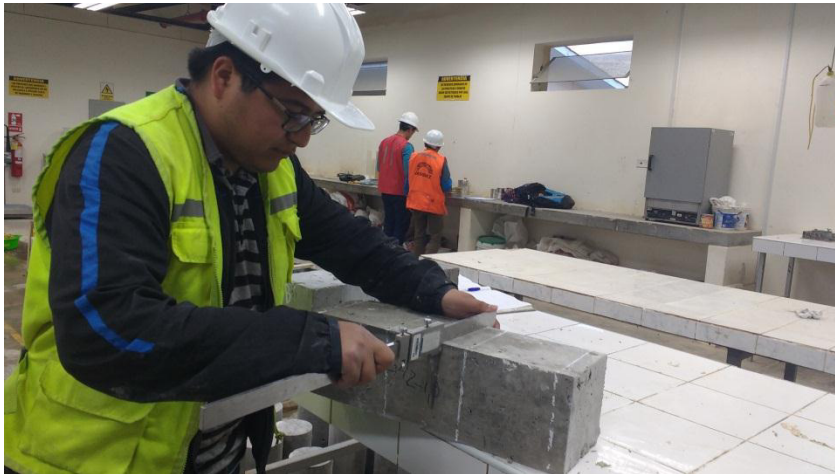
Fotografía N° 36: Medición de probetas prismáticas para ser ensayados a flexión
