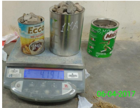
Fotografía N°8: Contenido de humedad agregado grueso, cantera Mashcón - Peso de la muestra seca
