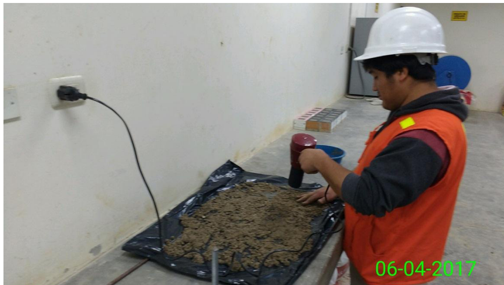
Fotografía N° 14: Peso específico de agregados fino – Secado con una suave corriente de aire caliente, hasta que las partículas puedan fluir libremente.
