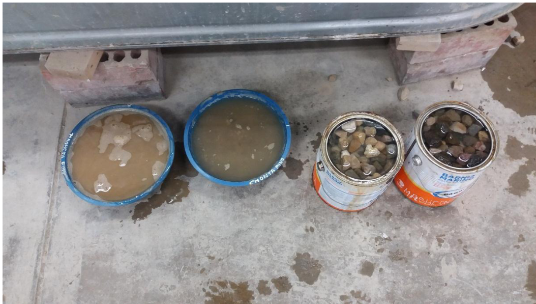
Fotografía N° 10: Peso específico de agregados- Sumergiendo muestras por 24 horas
