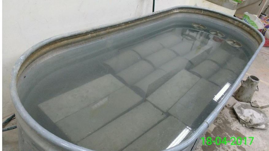
Fotografía N° 32: Curado de probetas prismáticas y cilíndricas cantera Chonta
