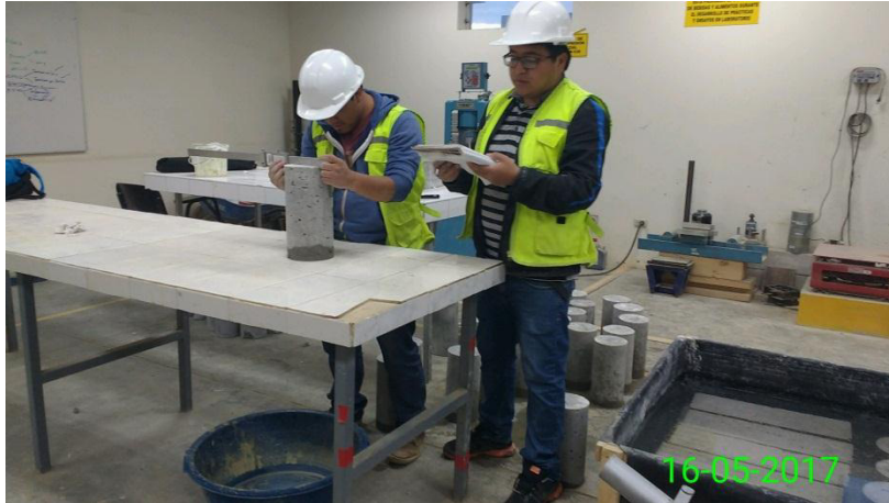
Fotografía N° 35: Medición de probetas cilíndricas para ser ensayados a compresión axial
