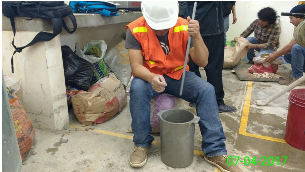
Fotografía N° 18: Peso unitario del agregado grueso – Compactando muestra
