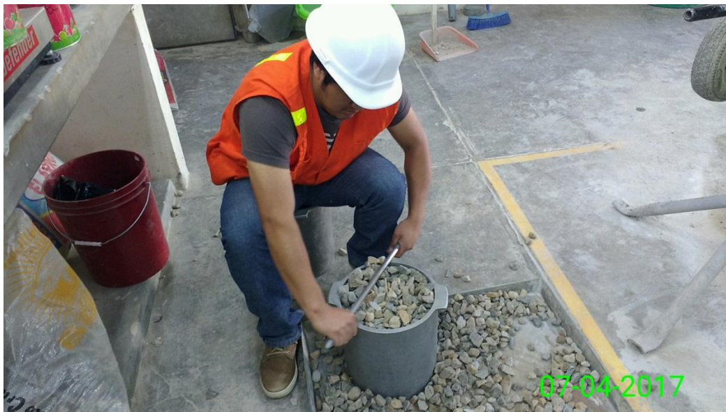
Fotografía N° 20: Peso unitario del agregado grueso – Enrasando la parte superior.
