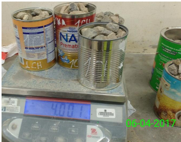
Fotografía N°6: Contenido de humedad agregado grueso, cantera Chonta - Peso de la muestra seca
