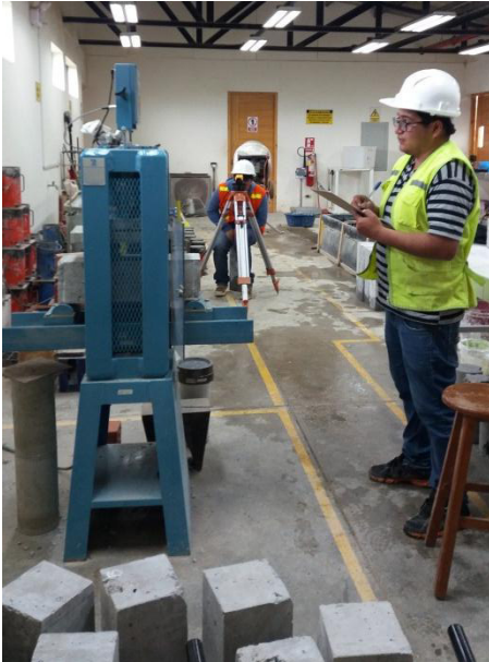
Fotografía N° 39: Realizando el ensayo a flexión de probetas prismáticas
