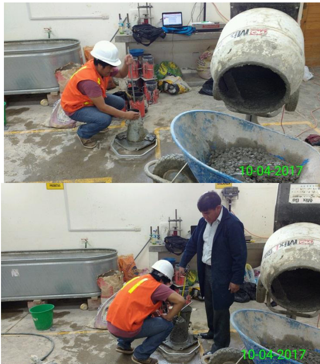
Fotografía N° 24: Consistencia del concreto, ensayo cono de Abrams
