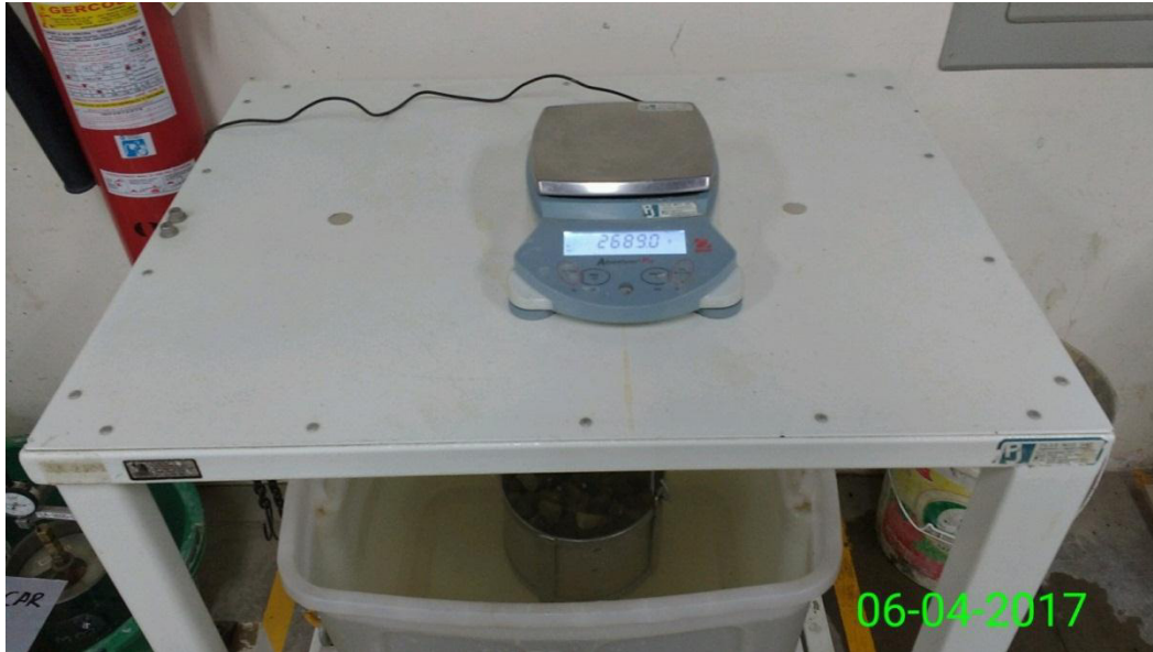
Fotografía N° 13: Peso específico de agregados grueso- Peso sumergido en estado saturado superficialmente seco
