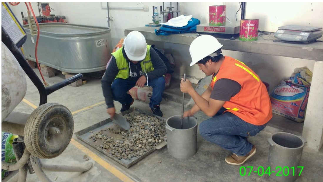
Fotografía N° 18: Peso unitario del agregado grueso – Compactando muestra
