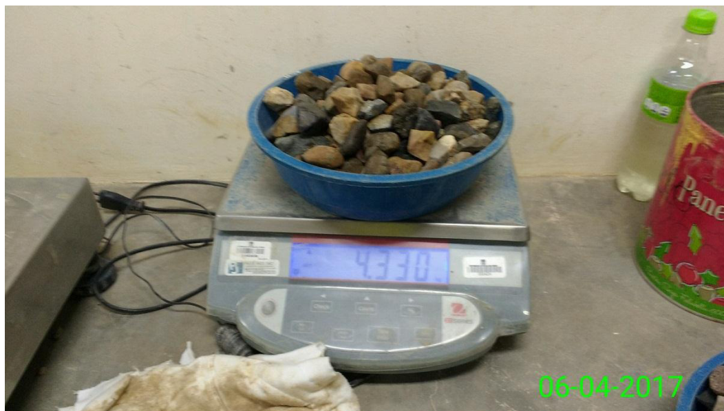
Fotografía N° 12: Peso específico de agregados grueso- Pesando la muestra en estado saturado superficialmente seco
