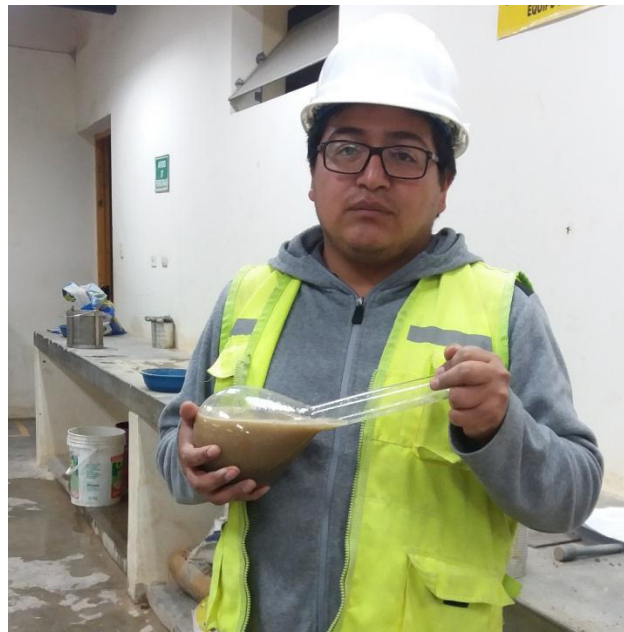
Fotografía N° 16: Peso específico de agregados fino – Agitando fiola para la eliminación de burbujas
