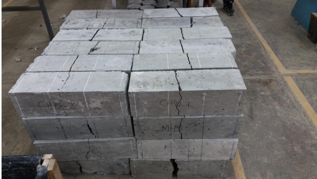
Fotografía N° 41: Probetas ensayadas a flexión se puede observar falla en el tercio central de las vigas
