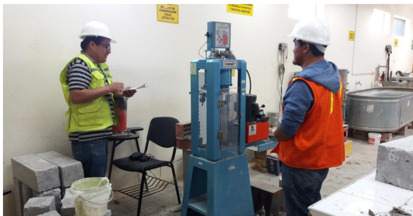
Fotografía N° 37: Realizando el ensayo a compresión axial de probetas cilíndricas.
