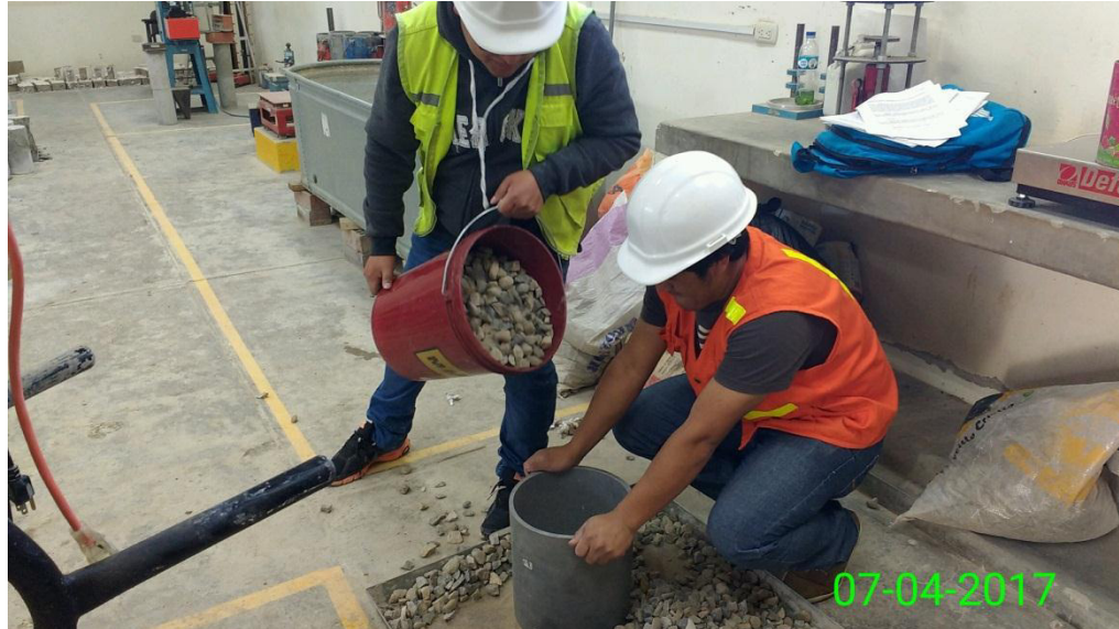
Fotografía N° 21: Peso unitario del agregado grueso – Realizando ensayo peso unitario suelto del agregado
