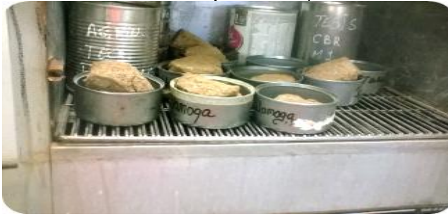
Figura 33. Muestras obtenidas del ensayo Proctor después de 24 horas en el horno
