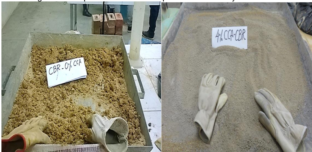
Figura 35. Preparación de muestra para CBR con 0% y 4% de CCA.
