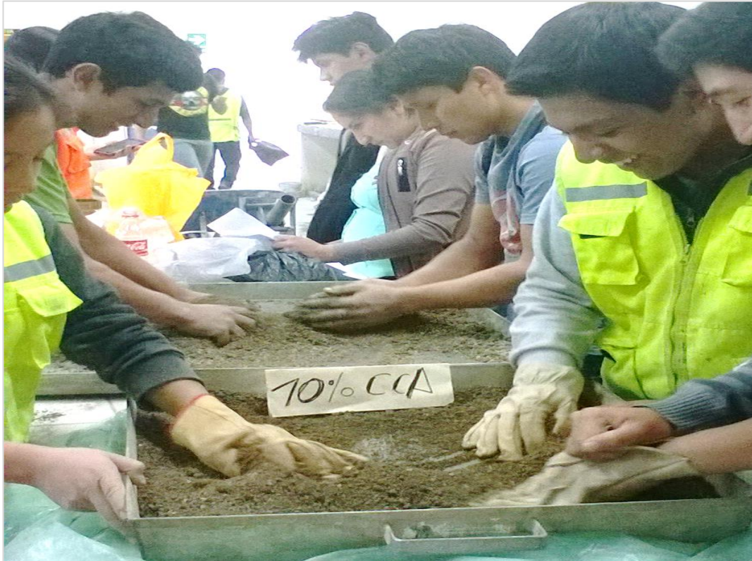
Figura 36. Realización del ensayo CBR, para la muestra de 10% de CCA.
