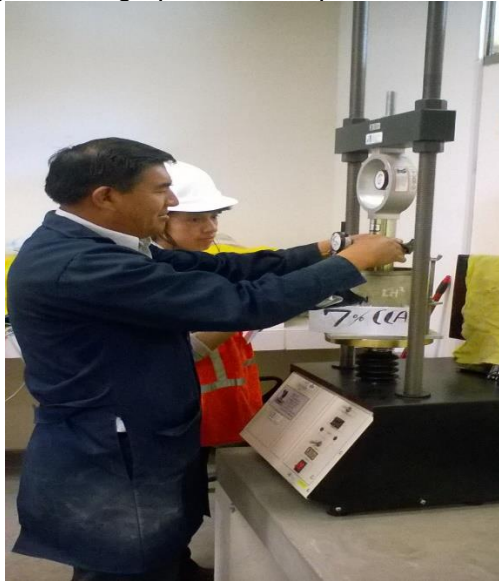
Figura 42. Ensayo de carga penetración para la muestra de 7% de CCA
