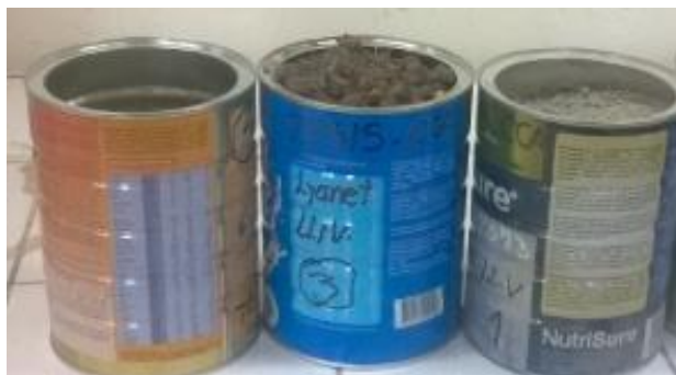
Figura 16. Muestras de suelo para análisis granulométrico
