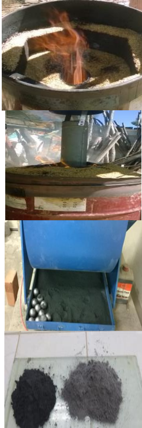
Figura 14. Quemado y molienda para obtener la ceniza
