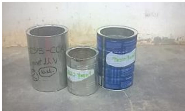
Figura 15. Muestras de suelo para determinación de humedad
