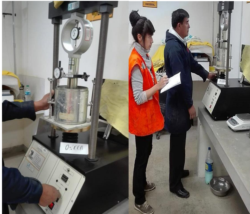
Figura 40. Ensayo de carga penetración para la muestra de 0% de CCA
