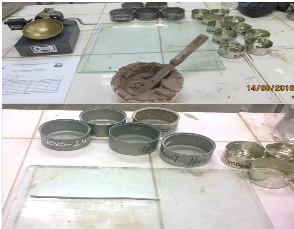
Figura 29. Preparación de muestras para límites de Atterberg
