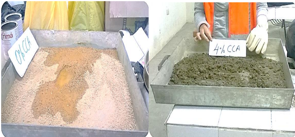
Figura 31. Preparación de suelo para ensayo Proctor con 0% y 4% de CCA
