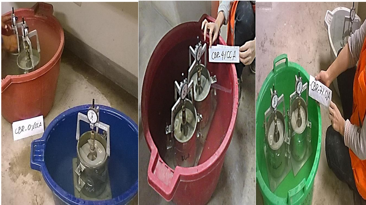
Figura 38. Sumergido de moldes después de compactado de ensayo CBR
