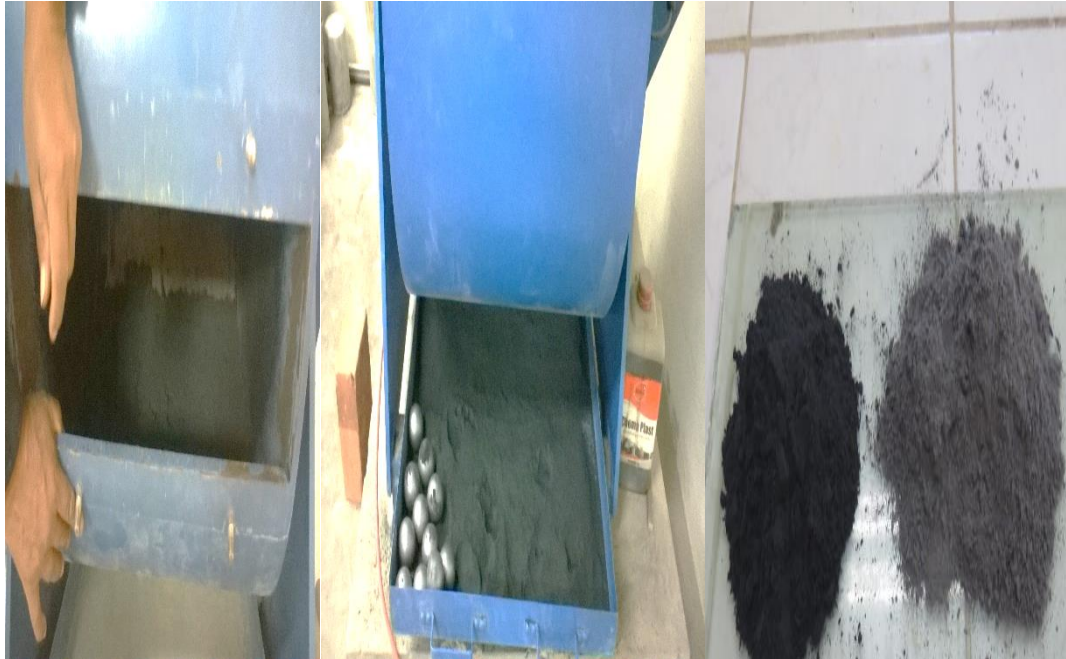
Figura 28. Molido de la CCA para activar sus propiedades
