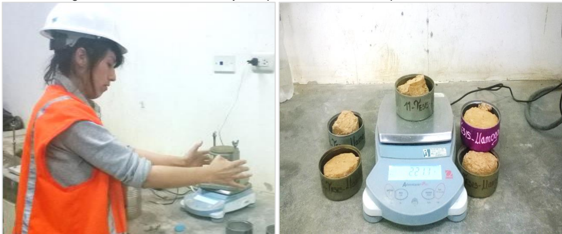
Figura 34. Muestras antes y después del horno después de 24 horas
