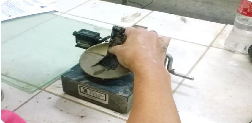
Figura 30. Realizando ensayo de límite plástico con 10%CCA
