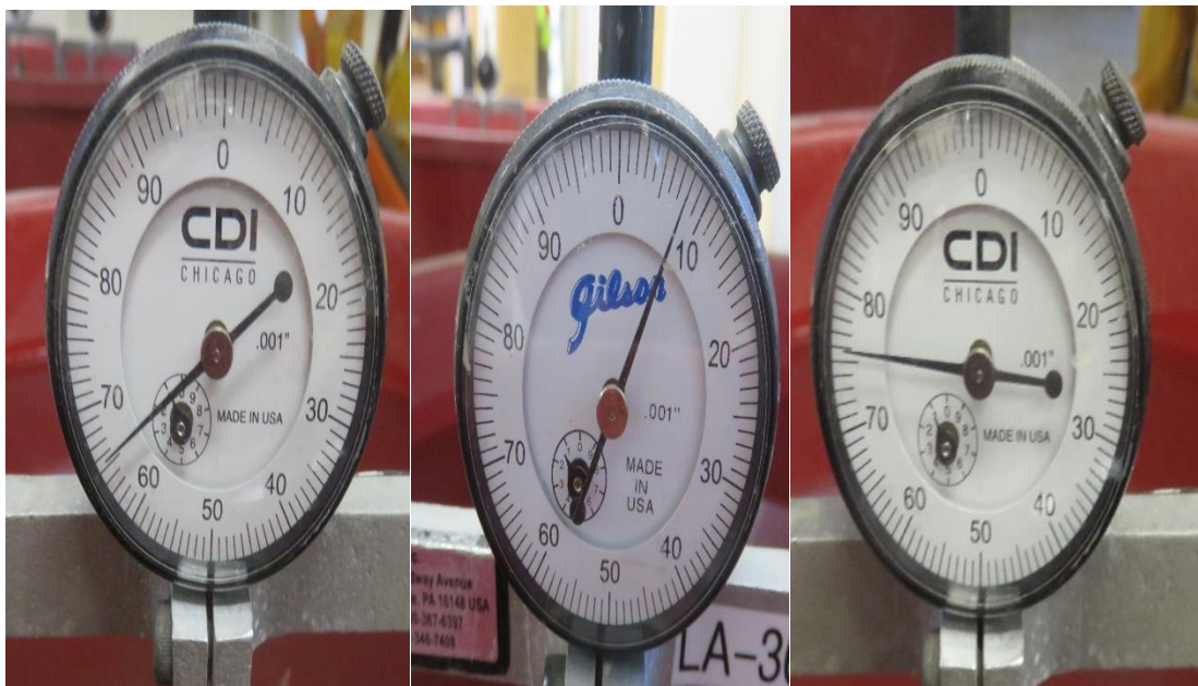
Figura 39. Registro del hinchamiento de las muestras sumergidas por 4 días
