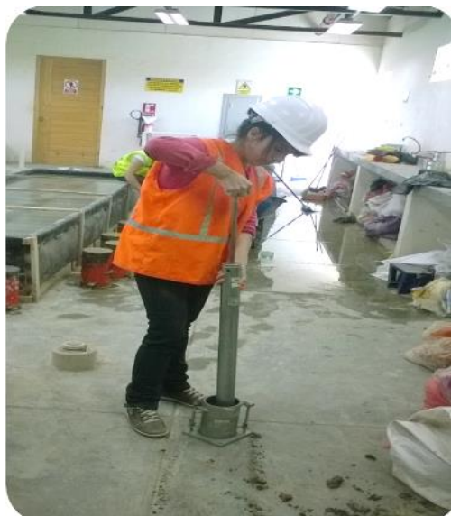
Figura 32. Realizando en ensayo Proctor con 7% de CCA
