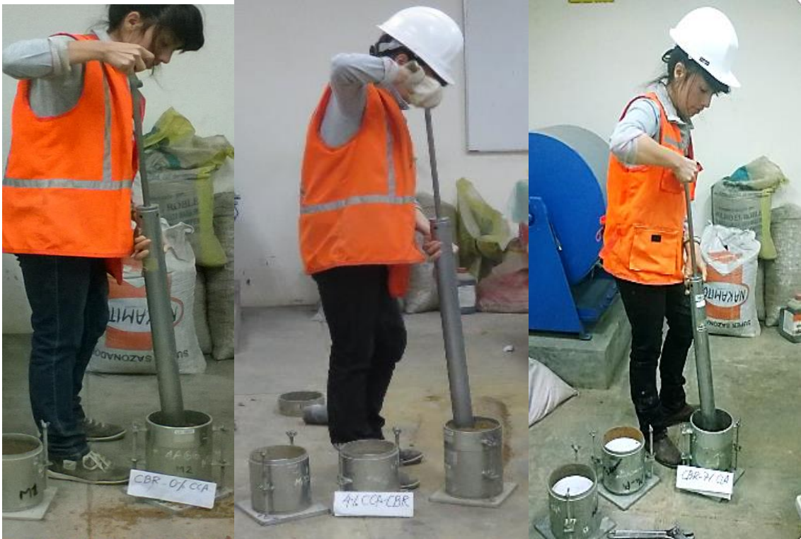
Figura 37. Compactado de muestra para CBR con 0% ,4% y 7% de CCA.
