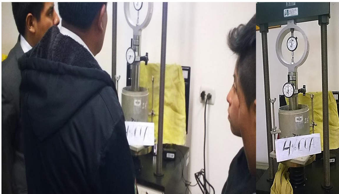
Figura 41. Ensayo de carga penetración con el Ing. Iván Mejía y sus alumnos de mecánica de suelos, para la muestra de 4% de CCA
