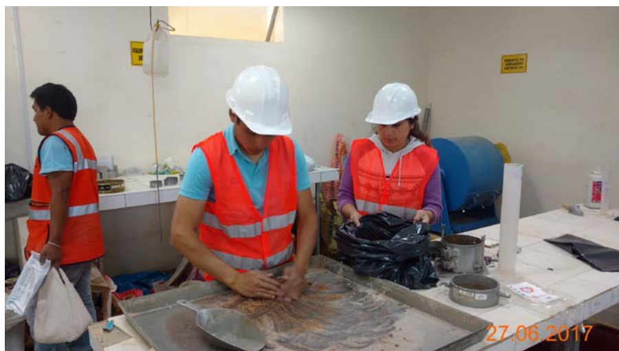
Foto 12. Preparación de muestra para ensayo de compactación.
