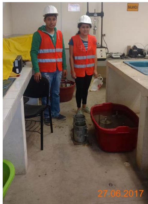
Foto 14. Moldes sumergidos para ensayo de CBR.
