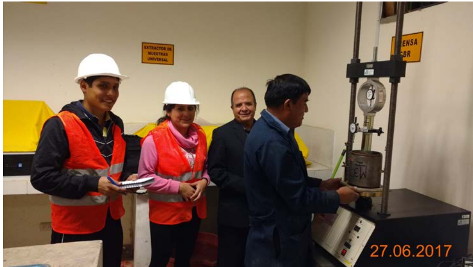
Foto 15. Ensayo de CBR.
