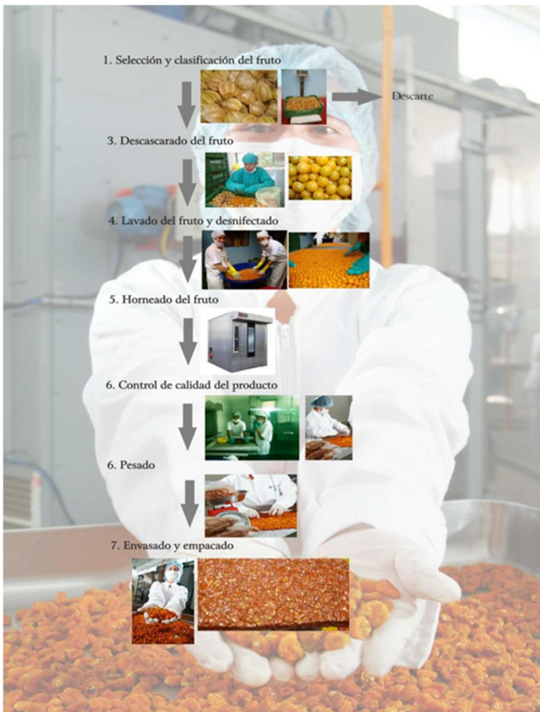
Figura N° 03 Flujo del proceso de transformación del Aguaymanto Orgánico Deshidratado
