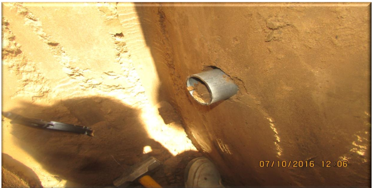
Figura n° 3: Extracción de muestras para la densidad natural del suelo de la C7.
