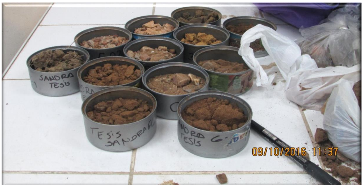
Figura n° 5: Muestras para secado en horno, durante 24 h. (Contenido de humedad)
