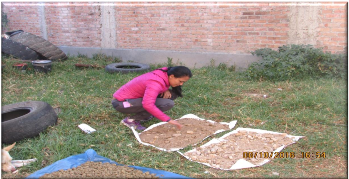
Figura n° 4: Secado de muestra a la intemperie.
