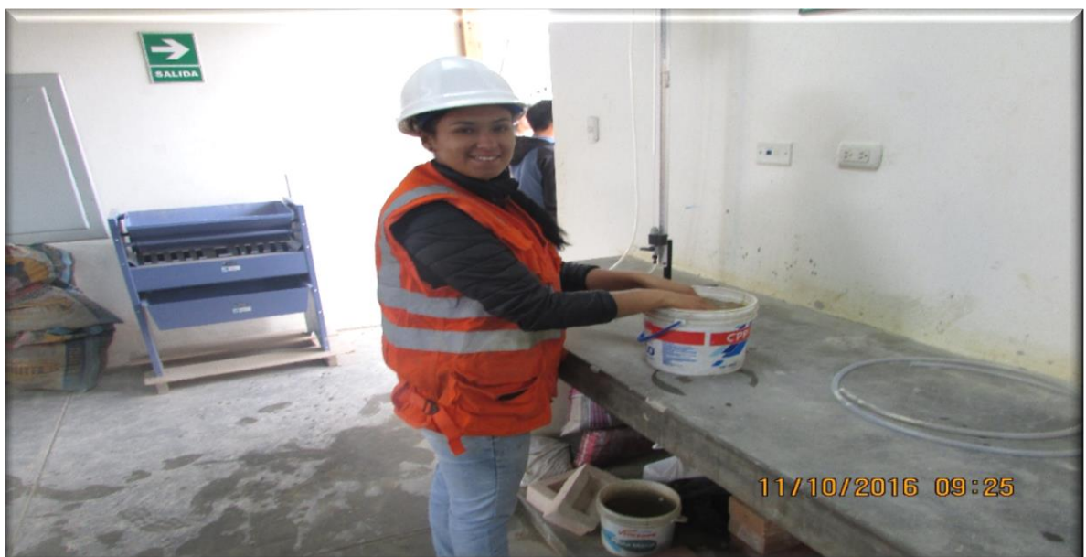
Figura n° 9: Lavado del suelo fino. (Granulometría)
