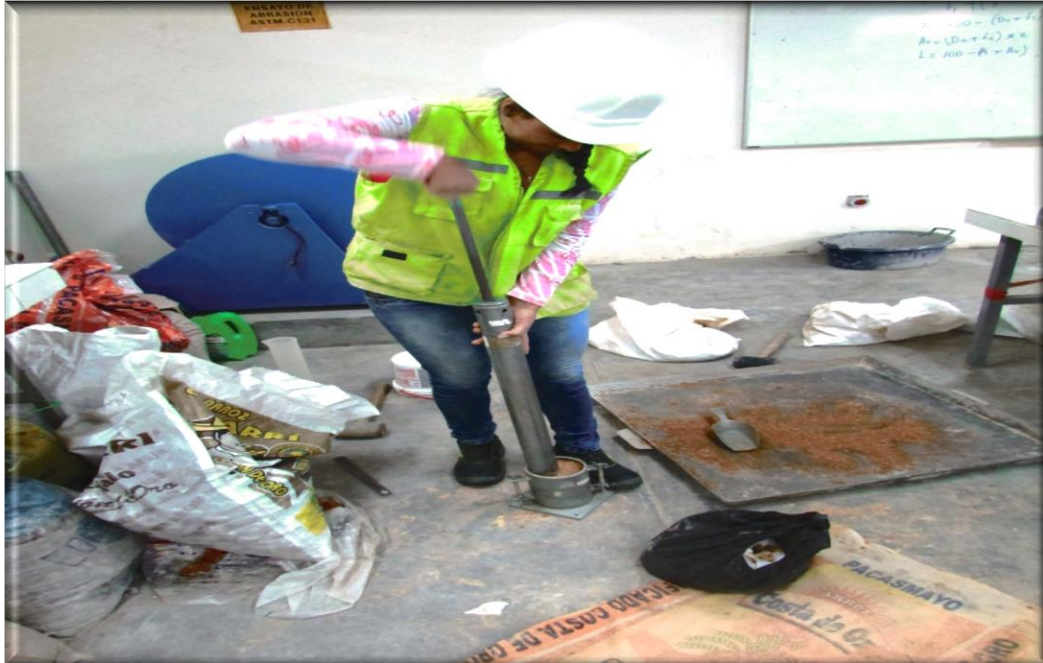
Figura n° 12: Ensayo de proctor modificado
