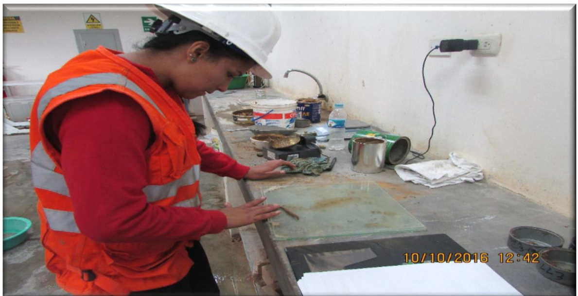
Figura n° 7: Realización de la muestra para el ensayo de limite plástico
