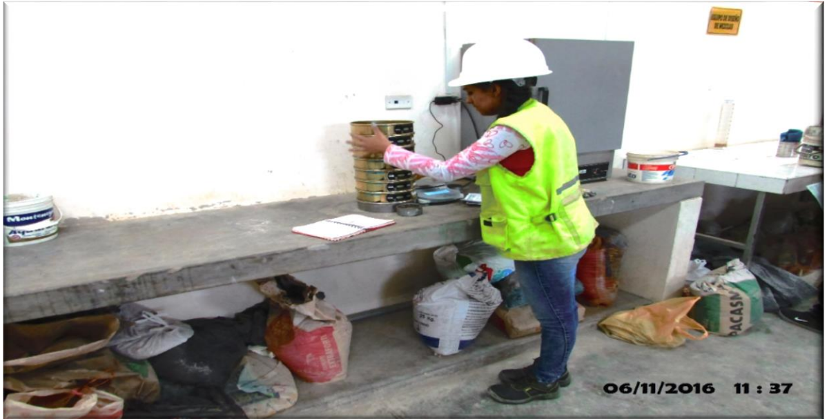
Figura n° 10: Realizando el ensayo de granulometría del material lavado
