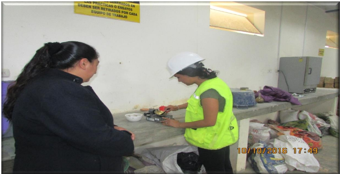
Figura n° 6: Colocación de muestra en la copa de casa grande (Límite líquido)
