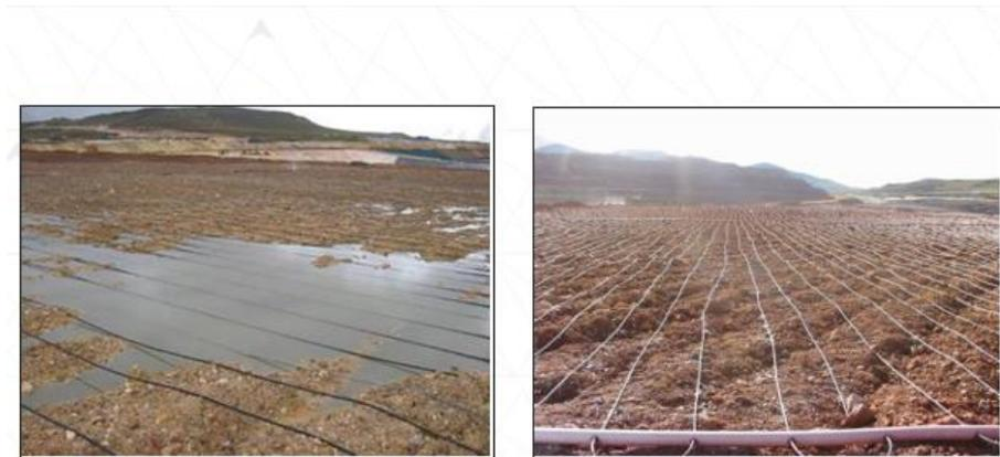
Fig. 07: Izquierda: Fotografía mostrando empozamientos de solución antes de la prueba.
