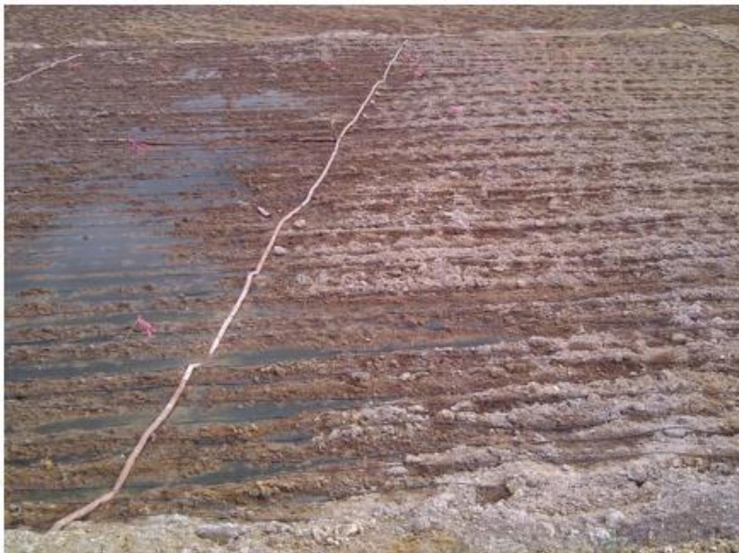
Fig. 11: Fotografía mostrando algunas acumulaciones de solución antes de las perforaciones
