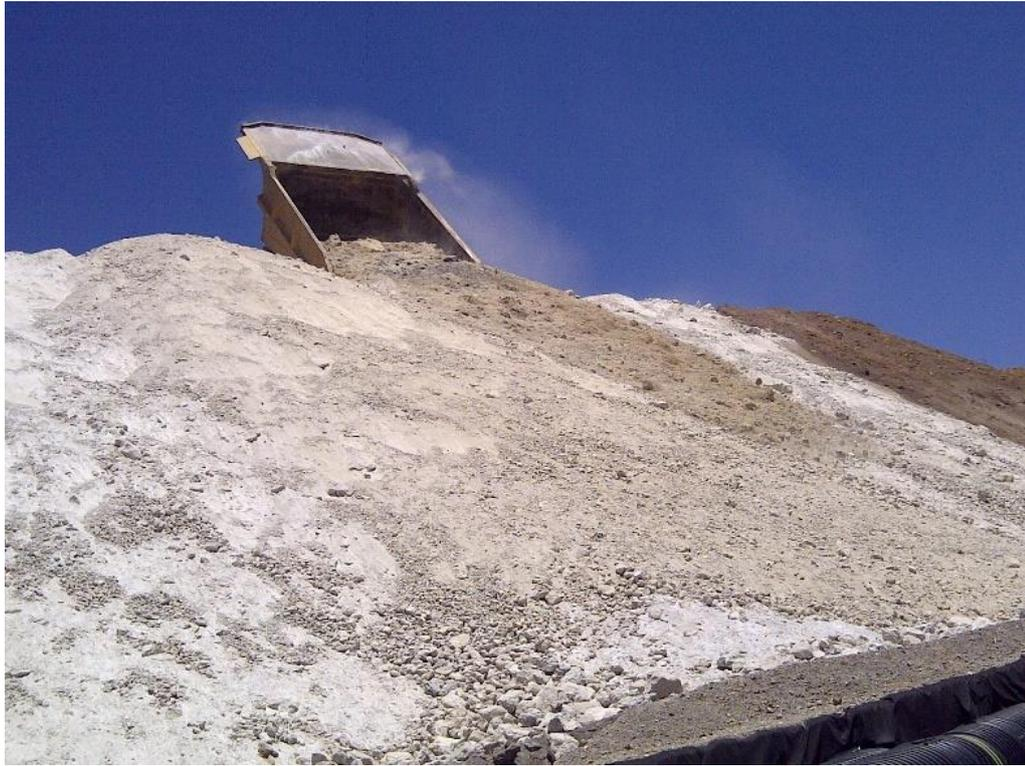
Fig. 15: Fotografía mostrando la descarga del mineral en bancos de 8m
