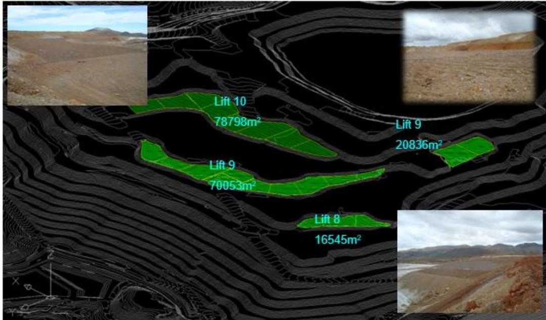
Fig. 04: fotografía mostrando las áreas puestas en riegos en bancos de 8 m.
