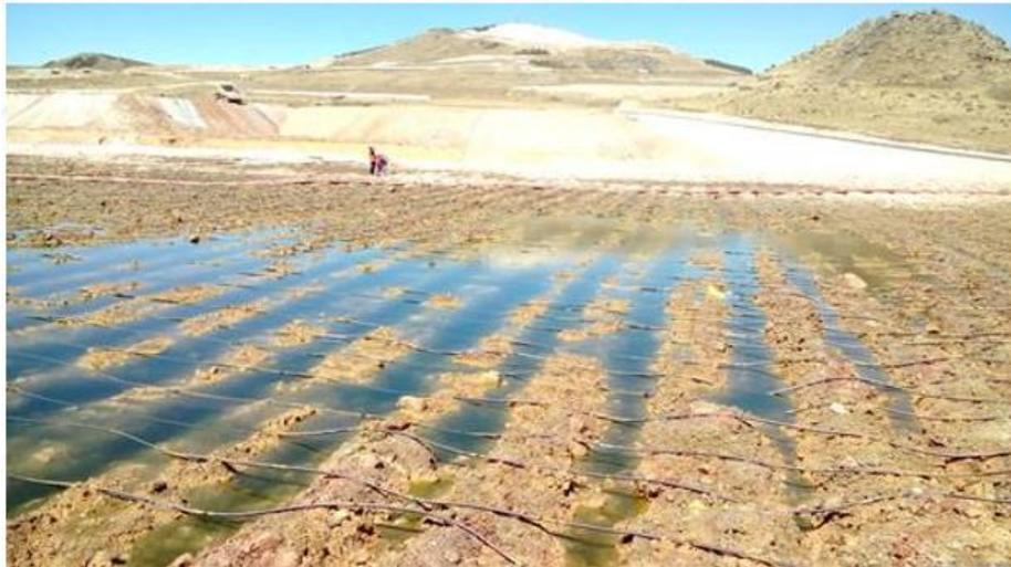
Fig. 06: Fotografía mostrando empozamientos de solución durante el lixiviado del material fino.
