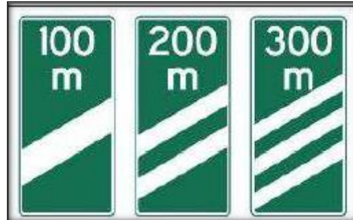
Figura N° 23: Balizas de acercamiento.
