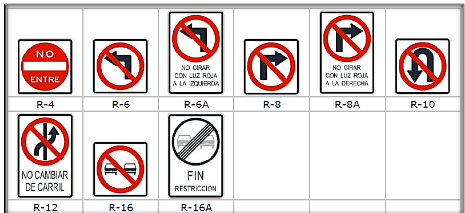
Figura N° 11: Señales de prohibición de maniobras y giros.
