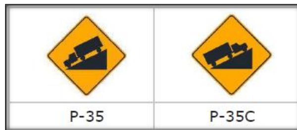
Figura N° 18: Señales preventivas – pendiente longitudinal.
