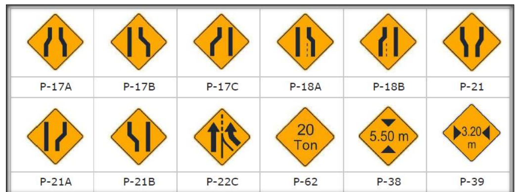
Figura N° 20: Señales preventivas por restricciones físicas de la vía.
