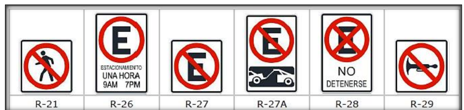
Figura N° 13: Otras señales de prohibición.
