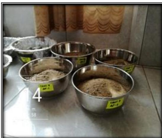
Figura N° 39: Contenido de humedad - Taras con muestra.
