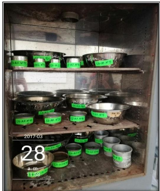
Figura N° 58: Durabilidad a los sulfatos - muestras en estufa.
