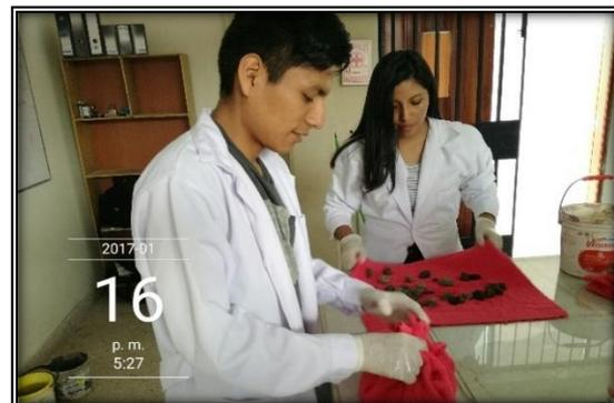
Figura N° 41: Peso específico del agregado grueso - secado superficial con franelas.
