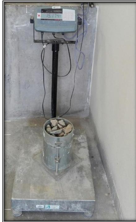
Figura N° 49: Peso unitario - peso del recipiente más agregado.
