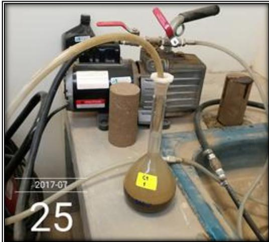
Figura N° 43: Succión de aire utilizando una bomba de vacíos.
