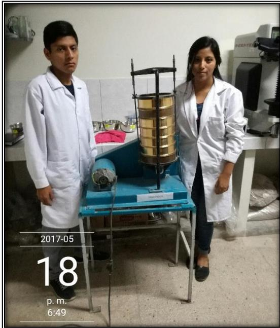
Figura N° 47: Granulometría - tamizador eléctrico.
