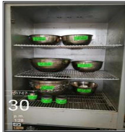
Figura N° 40: Contenido de humedad - Estufa.
