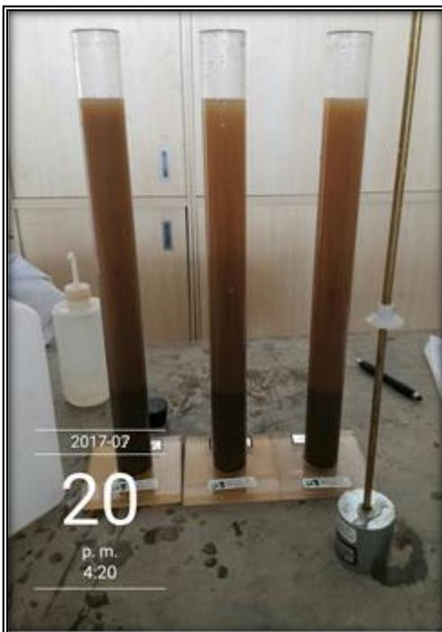
Figura N° 51: Arena equivalente - material ensayado en reposo por 20 min.
