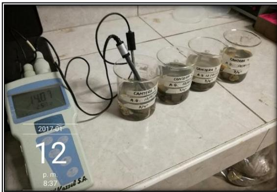
Figura N° 54: Cloruros - medición utilizando el conductímetro.
