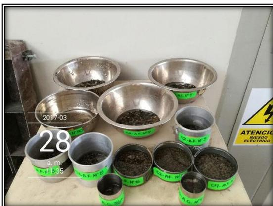
Figura N° 56: Durabilidad a los sulfatos - agregados sumergidos en solución de magnesio, tercer ciclo.
