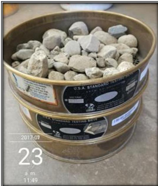
Figura N° 61: Resistencia a la abrasión - cantidad de muestra retenida superior al tamiz N°12.
