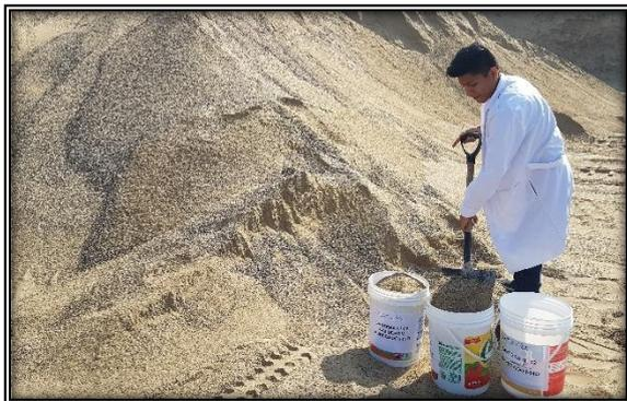
Figura N° 38: Almacenamiento de agregados para ensayarlos.
