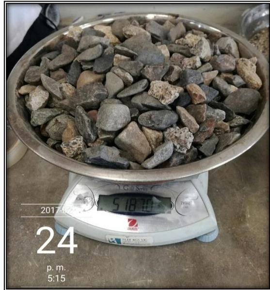
Figura N° 62: Resistencia a la abrasión - material para ensayar en la máquina de Los Ángeles.
