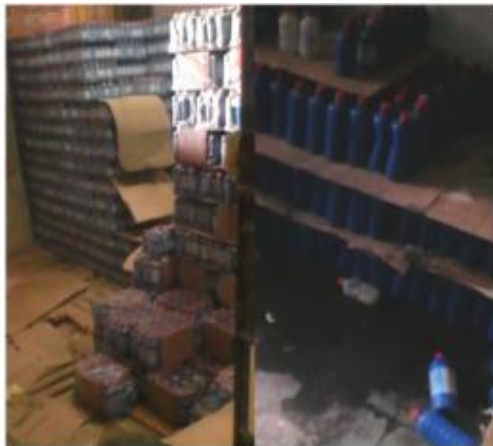
Imagen 1. Apilamiento incorrecto de Lejías. Fuente: Elaboración Propia.
