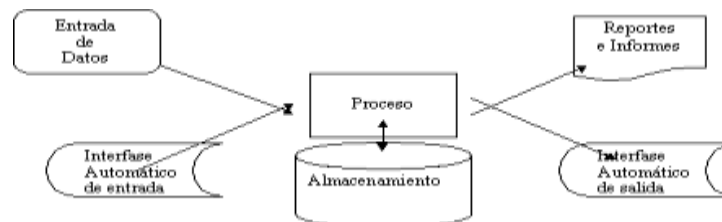
Figura 5: Diseño conceptual de las actividades de un sistema de información
