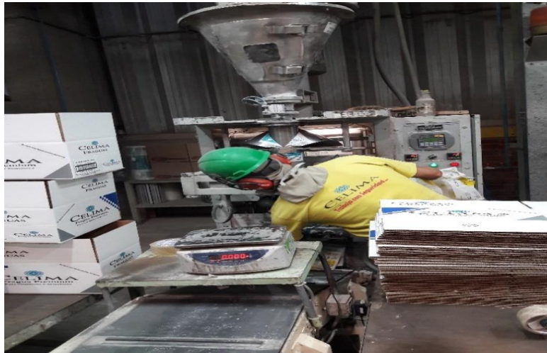
Figura N° 8. Maquinista de envasado de fragua.
