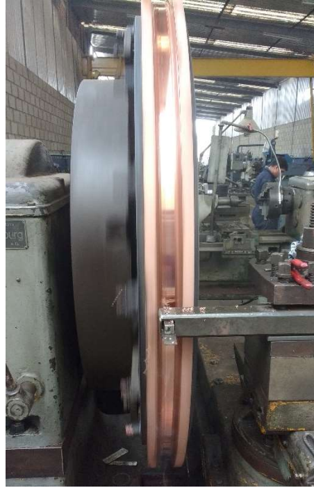
Canal en proceso de maquinado
