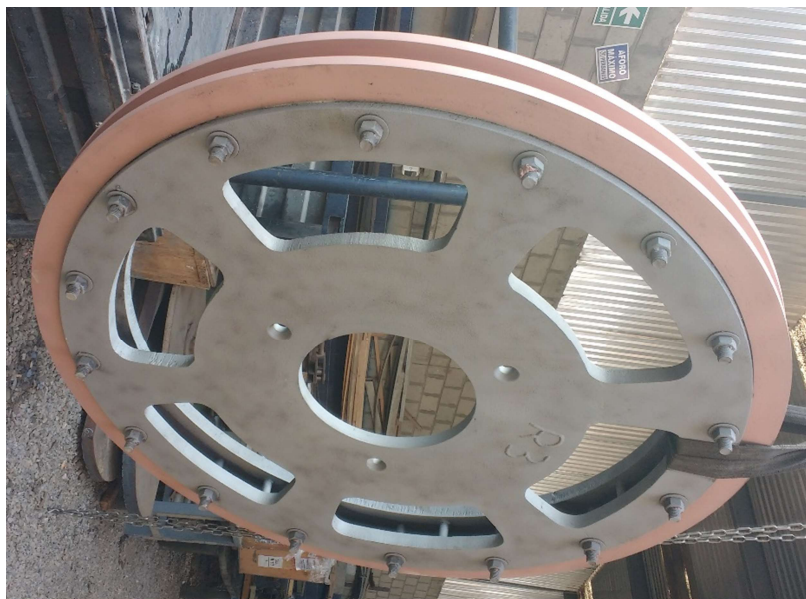
Rueda de colada arenada.
