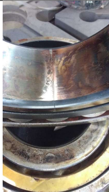
Rodamiento superior con la pista interior rota
