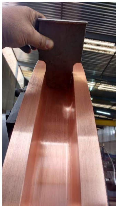
Detalle del canal rectificando
