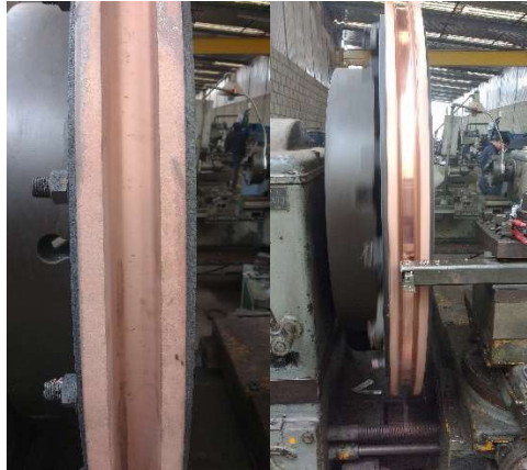
Figura 13 Rectificado de Canal de Rueda de Colada
