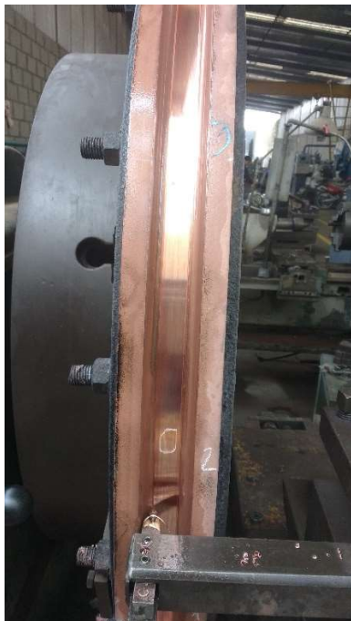
Canal a 3 mm de maquinado presenta rajaduras
