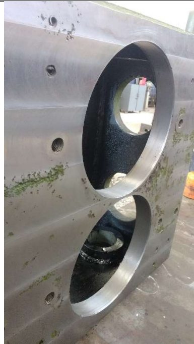
Alojamiento de cilindro en carcasa maquinado
