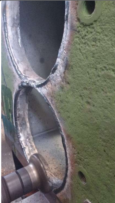
Alojamientos de cilindro en carcasa relleno
