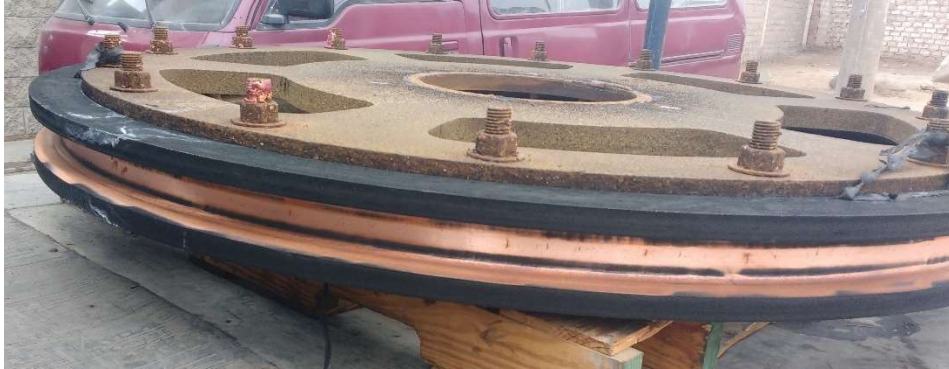
Recepcion de rueda #3, en el que se aprecian las diversas rajaduras profundas
