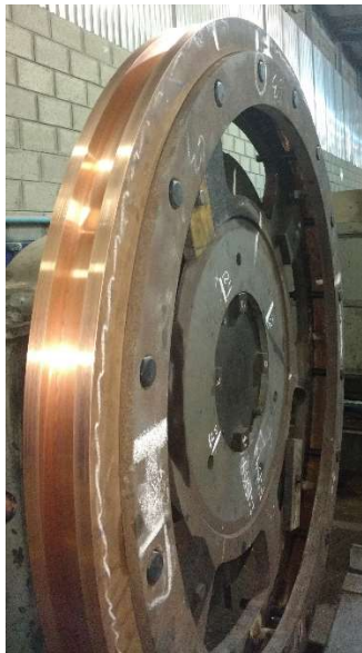
Rueda con canal rectificado
