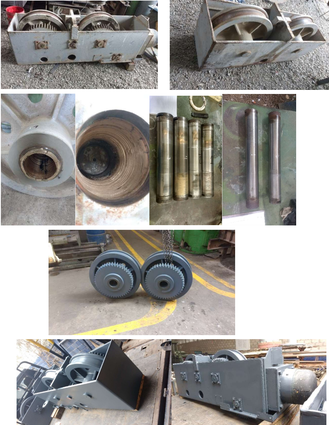
Figura 23 Trabajo de reparación de carretes Cementos Lima
