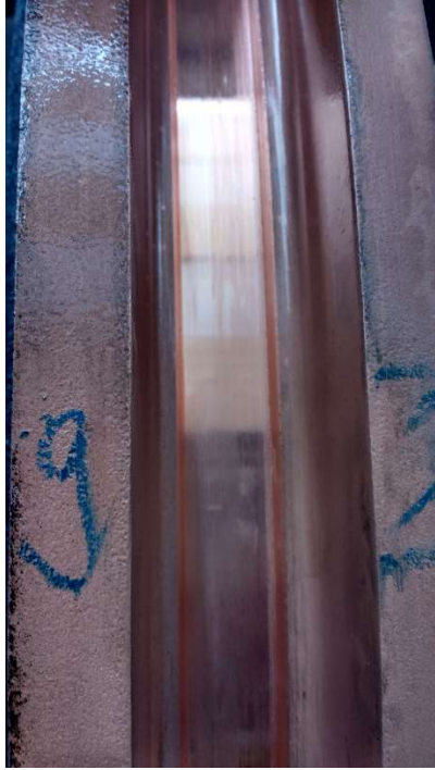
Canal a 9 mm de maquinado, ya no presenta rajaduras
