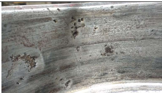
Otra vista del desgaste del alojamiento de cilindro en carcasa
