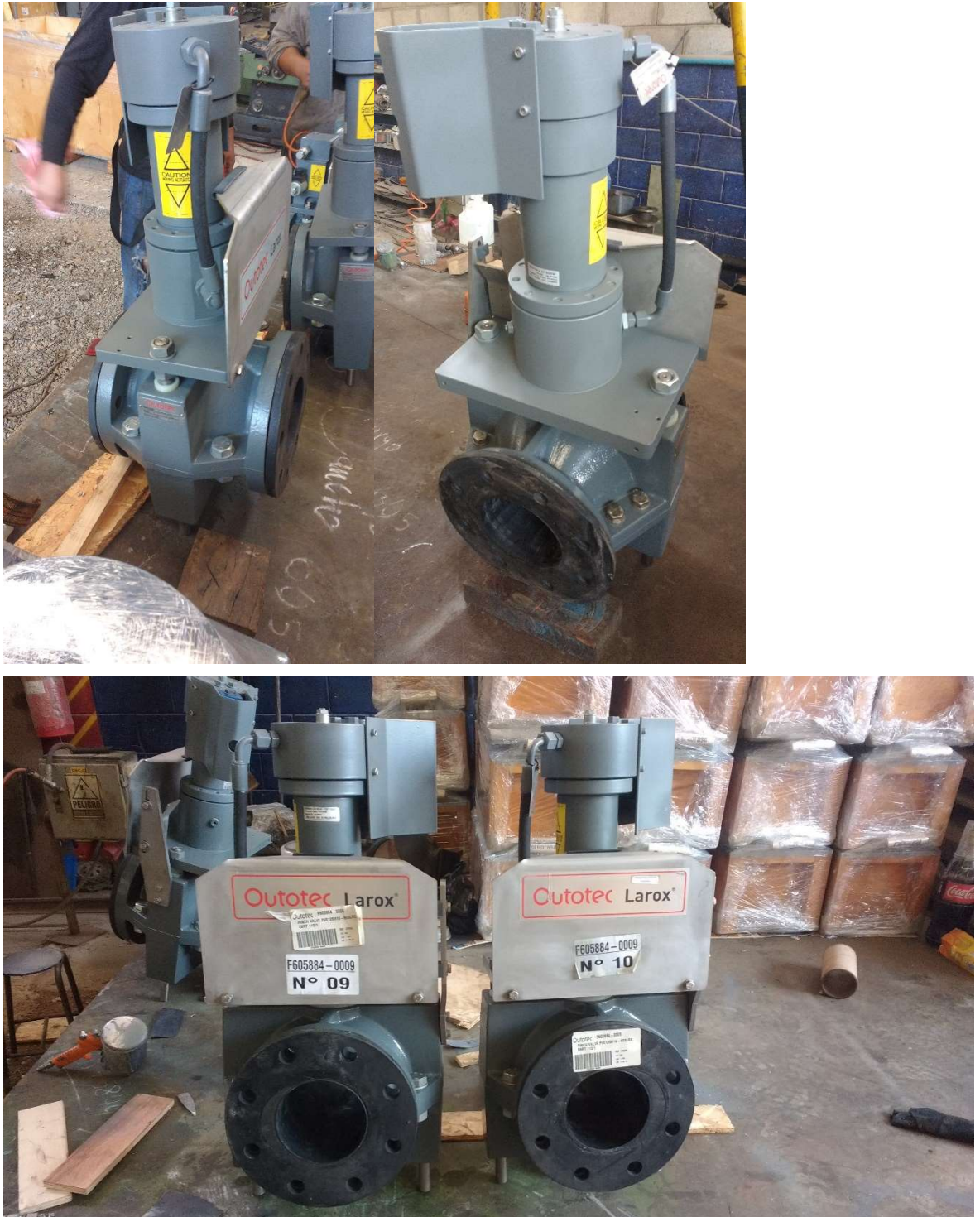
Figura 24 Reparación de válvulas piloteadas Outotec
