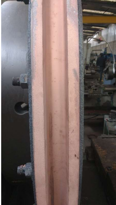
Detalle del canal arenado, antes del maquinado
