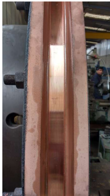
Canal a 6 mm de maquinado aun presenta rajaduras
