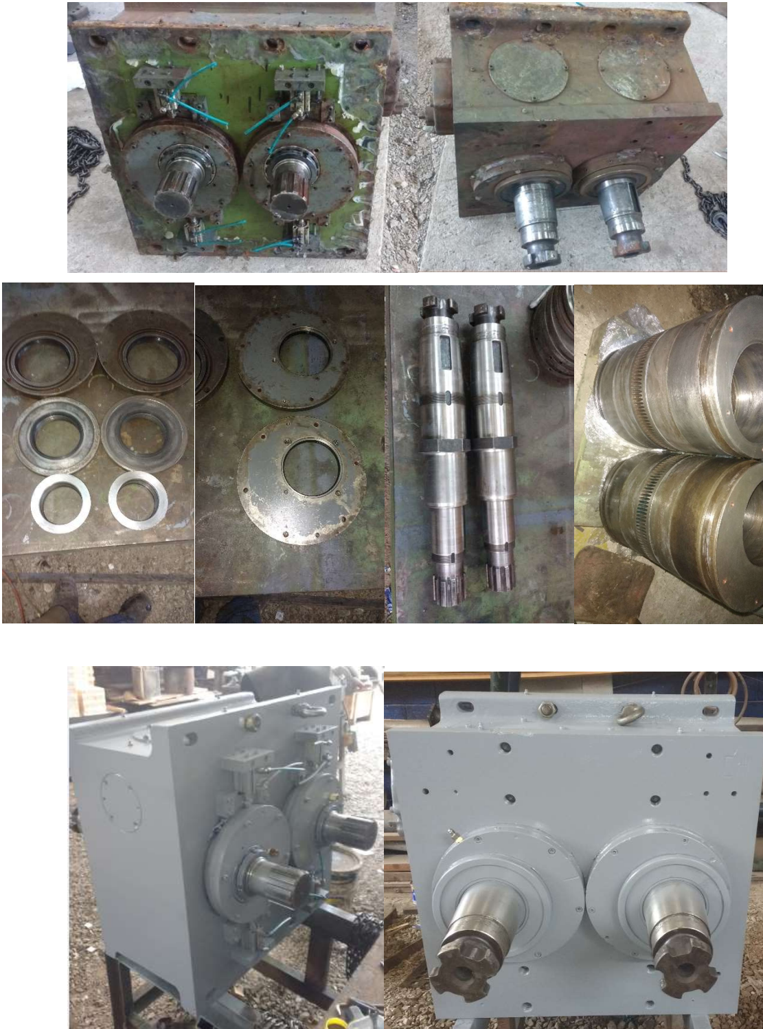
Figura 25 Reparación de Caja Laminadora Cobrecon SAC
