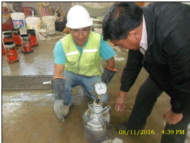
FOTO N° 14 Contenido de aire en el concreto patrón f'c = 210 kg/cm^2 .
