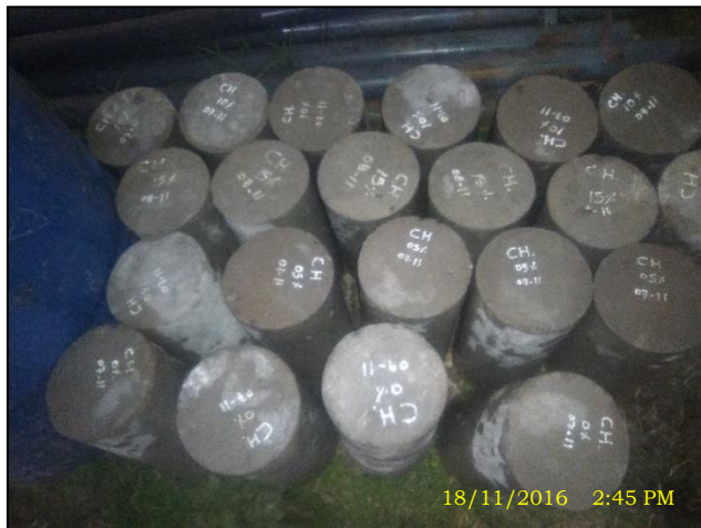
FOTO N° 19 Probetas elaboradas con y sin porcentaje de PET reciclado.
