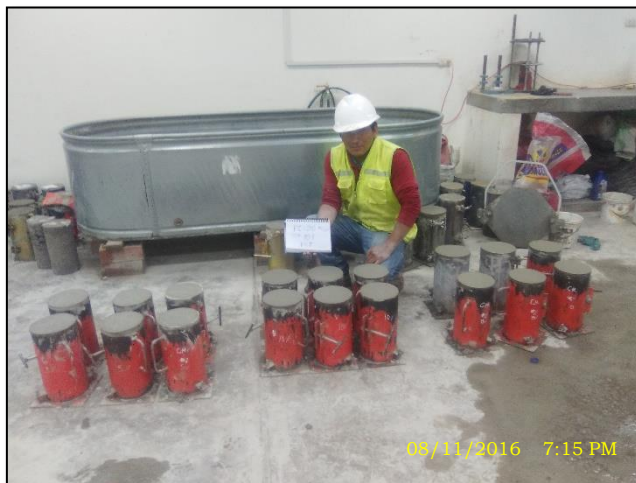
FOTO N° 17 Identificando cada tanda de las probetas elaboradas
