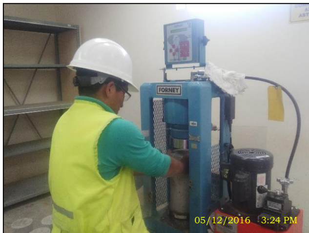
FOTO N° 20 Colocación de espécimen para hacer el ensayo a compresión axial
