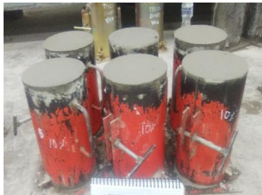
Figura n.º 1. Espécimen de concreto
