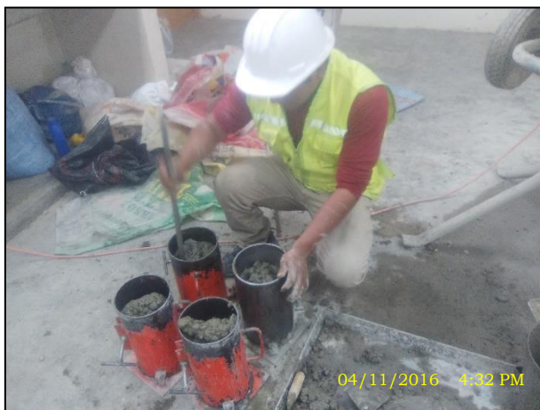
FOTO N° 15 Colocación del concreto en los moldes con tres capas y 25 golpes de chuseado
