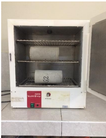
Figura 53: Ensayo de densidad para concreto, lab. de concreto UNT
