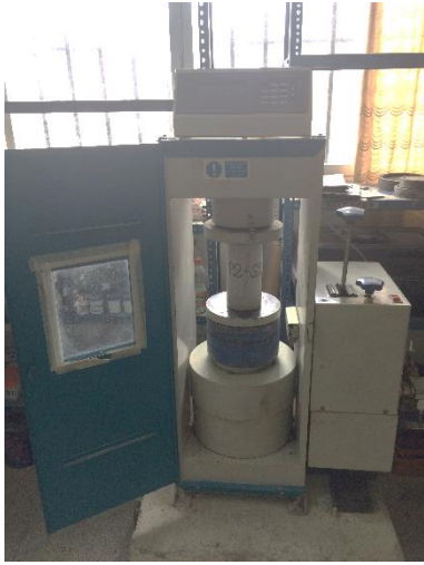
Figura 52: Ensayo de resistencia a la compresión, lab. de concreto UNT
