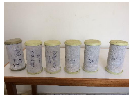
Figura 49: Capeado de probetas, lab. de concreto UNT
