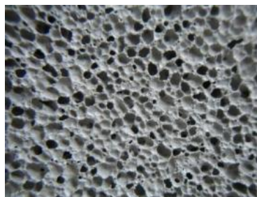
Figura 9: Porosidad de un concreto con aire incorporado
