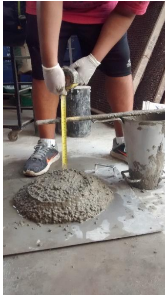
Figura 48: Asentamiento de mezcla de concreto
