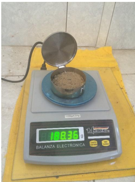
Figura 41: Arena para el contenido de humedad, lab. de concreto UNT
