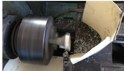
Figura 12: Torneado de pistón
