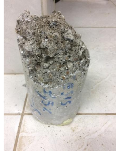
Figura 51: Reacción del aluminio en probetas de concreto, lab. de concreto UNT
