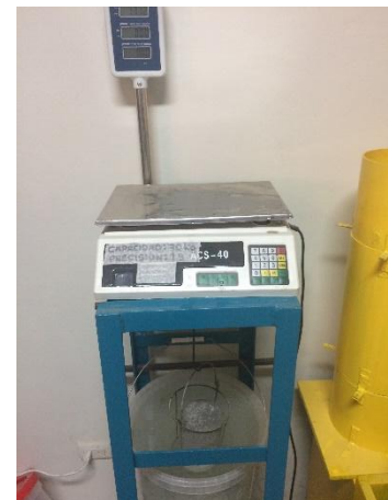
Figura 54: Ensayo de absorción, lab. de concreto UNT
