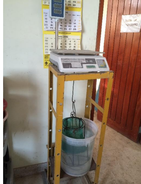
Figura 38: Absorción y peso específico de la piedra, lab. de concreto UNT
