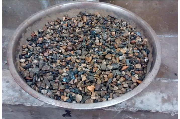
Figura 31: Piedra de 3/8", Lab. de concreto UNT
