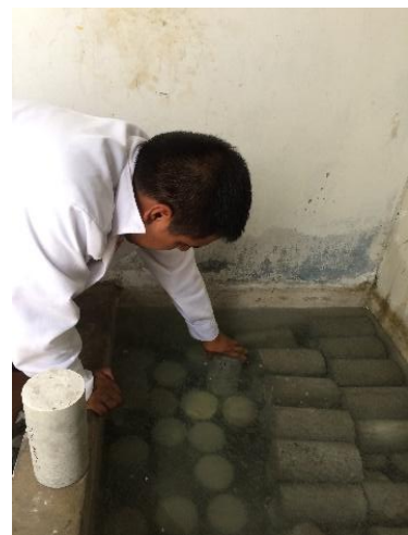
Figura 46: Poza de curado de probetas, lab. de concreto UNT
