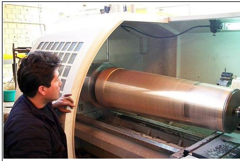
Figura n° 3.8 Mecanizado de bocina
