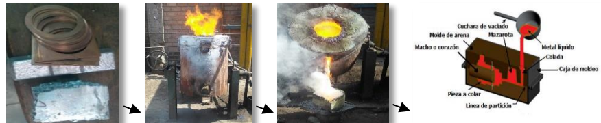
Figura n° 2.7 Proceso Básico de Fundición en molde de arena
