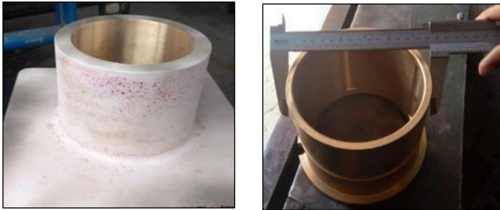
Figura n° 3.9 Prueba con tinta penetrante y control dimensional Elaboración Propia (2017)
