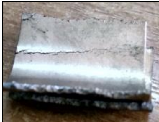
Figura n° 3.13 Pieza con fragilidad
