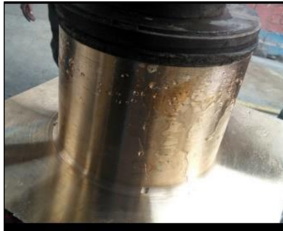
Figura n° 3.10 Porosidades resaltadas en prueba hidrostática Elaboración Propia (2017)
