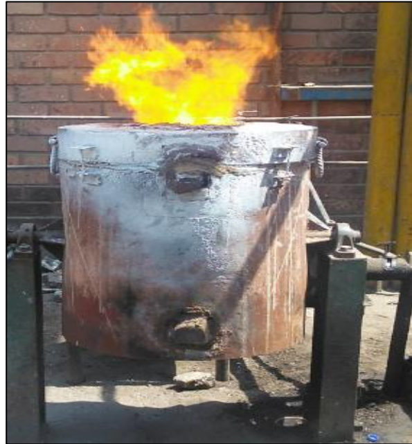
Figura n° 3.7 Horno de crisol en proceso de fusión Elaboración Propia (2017)
