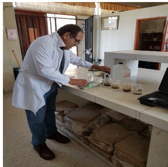
Figura N°A8. Medición de la conductividad de los agregados finos
