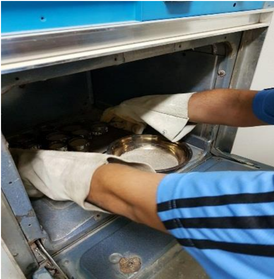
Figura N°A9. Determinación del contenido de humedad
