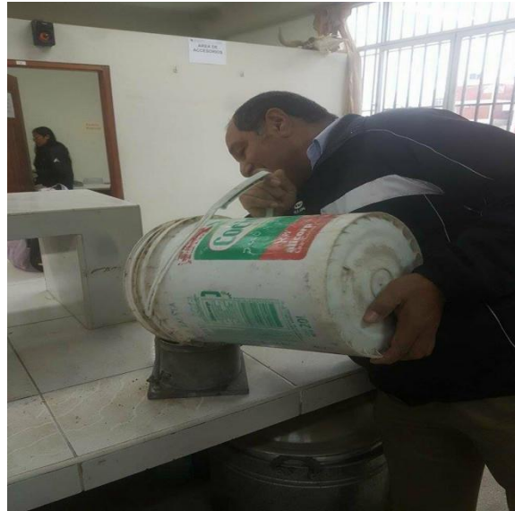
Figura N°A6. Ejecución de ensayo de Peso Unitario
