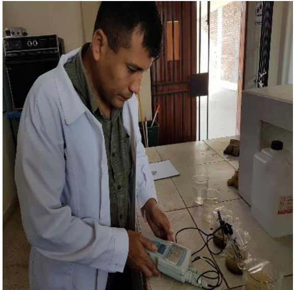
Figura N°A5. Medición de TDS de los agregados finos
