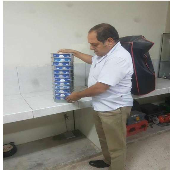
Figura N°A14. Granulometría manual de los agregados finos
