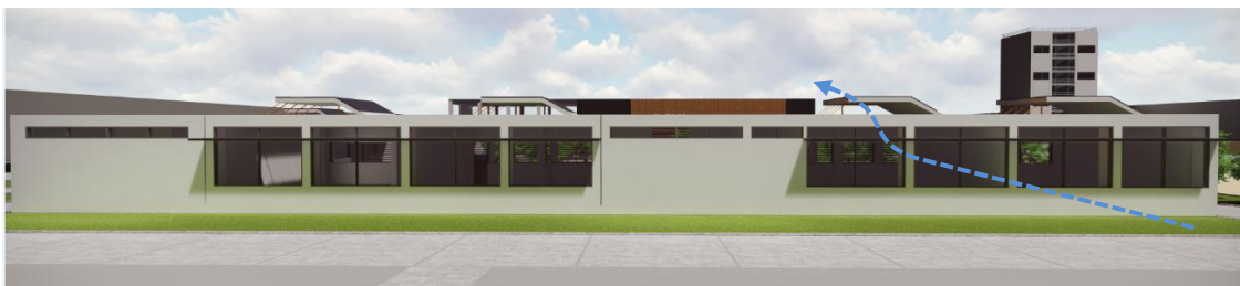
Ventilación cruzada en aulas de la escuela de bombero
