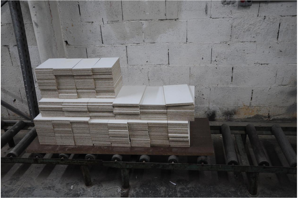
Foto N° 12: Carril para transporte de piezas (borde)
