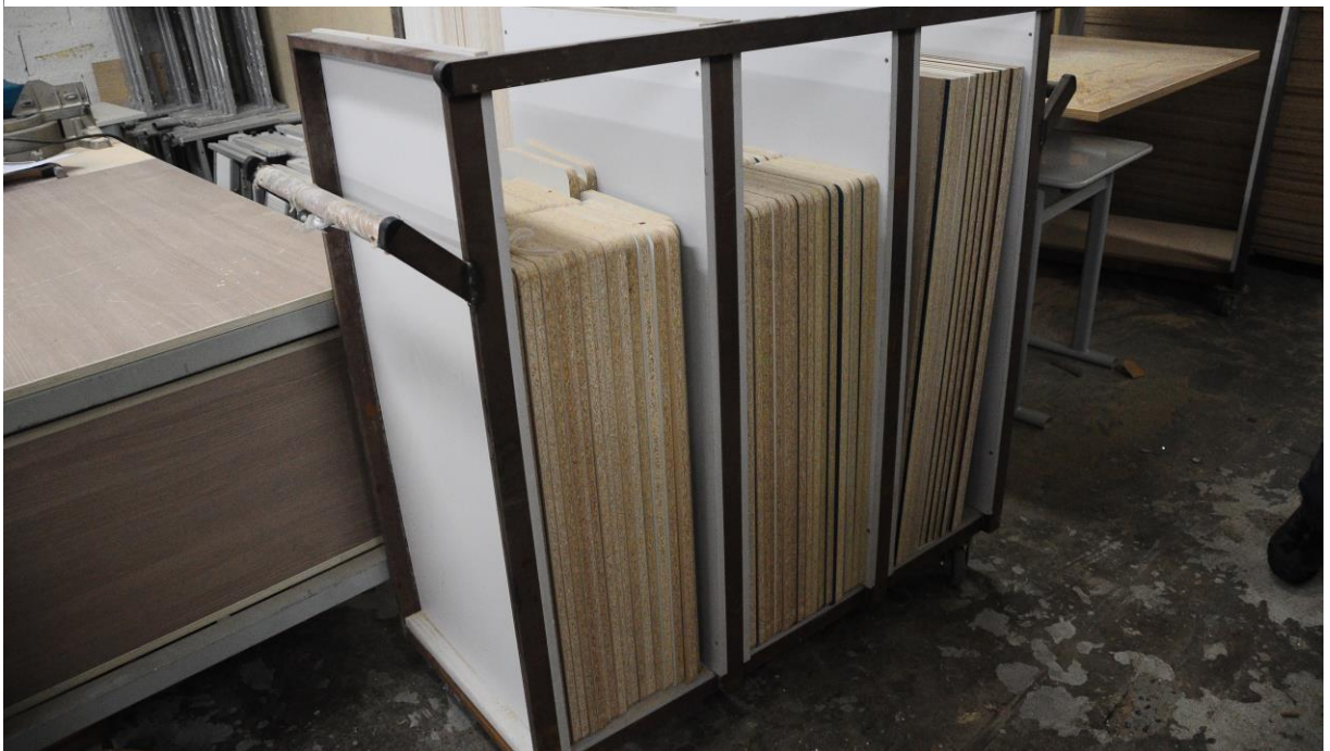
Foto N° 13: Carrito para transporte de piezas (perforación)
