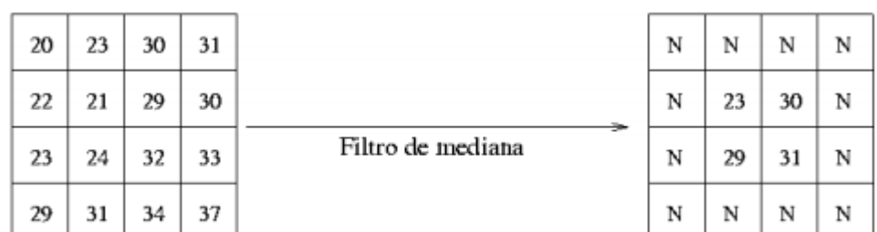
Ilustración 7 - Mecanismo de aplicación del filtro de mediana.
