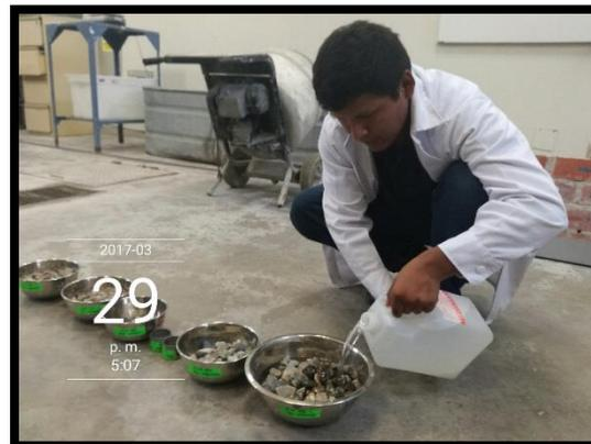
Figura N° 26: Durabilidad a los sulfatos - agregados sumergidos en solución de magnesio.
