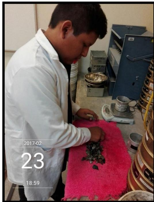
Figura N° 21: Peso específico del agregado grueso - secado superficial con franelas. (Propia)
