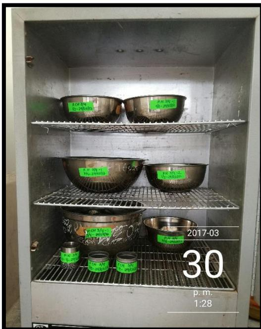
Figura N°28: Durabilidad a los sulfatos - muestras en estufa. (Propia)
