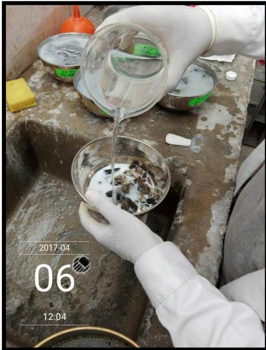
Figura N° 27: Durabilidad a los sulfatos - agregados lavados con cloruro de bario.
