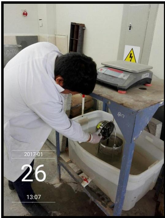
Figura N° 22: Peso específico del agregado grueso - peso sumergido. (Propia)
