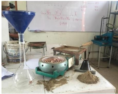
Figura 23: Absorción y peso específico del agregado fino - Laboratorio de concreto UPN
