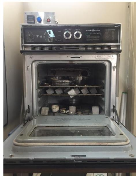
Figura 30: Probetas secando en estufa
