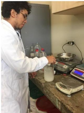
Figura 24: Preparación de solución para ensayo de equivalente de arena - Laboratorio de concreto UPN
