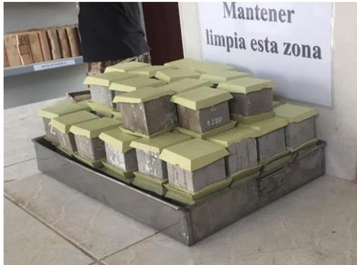
Figura 32: Probetas capiadas con azufre – Laboratorio de Universidad Nacional de Trujillo
