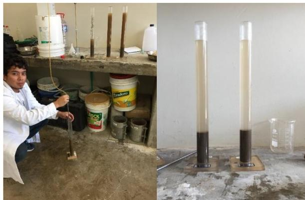
Figura 25: Equivalente de arena - Laboratorio de concreto UPN
