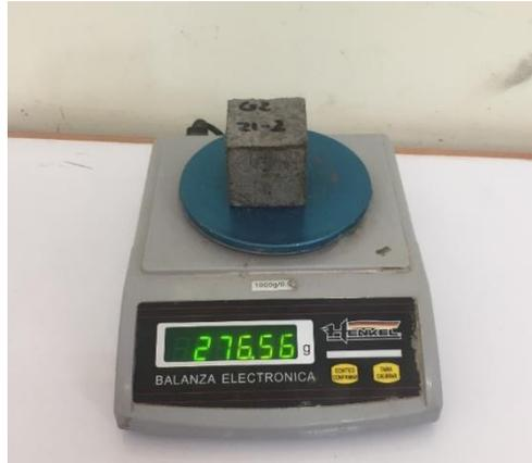
Figura 29: Peso en estado superficialmente seco -
