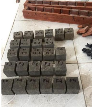
Figura 27: Desmoldado de probetas - Laboratorio de concreto UNT
