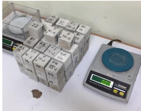
Figura 26: Lote de probetas secas - Laboratorio de concreto UNT
