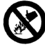
Prohibido apagar con agua
