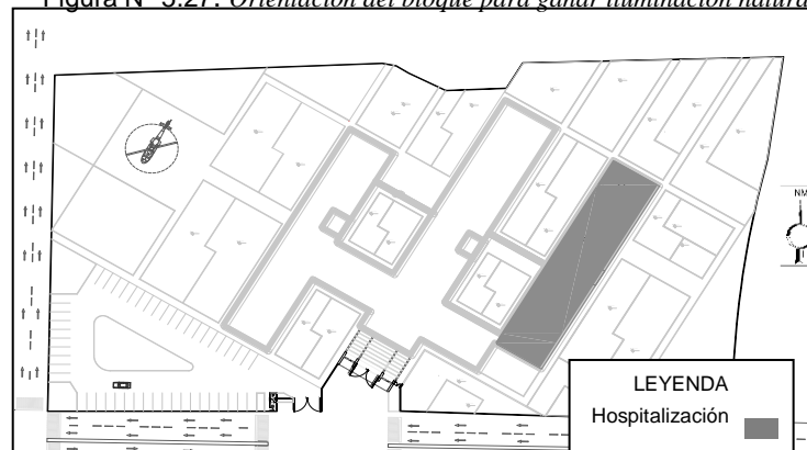
Figura N° 5.27. Orientación del bloque para ganar iluminación natural
