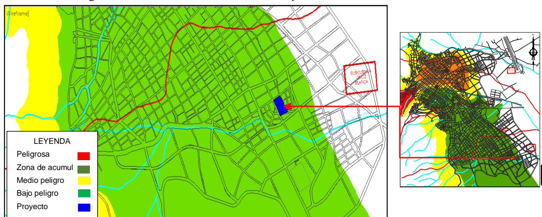
Figura N° 5.13 Plano de deslizamiento - Cajamarca
