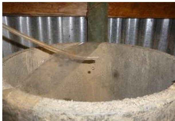
Fotografía 6. Riego de la columna con un flujo constante de 12.2 ml/minuto en cada una de las pruebas de percolación.
