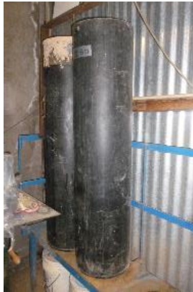
Fotografía 5. Tubo de HDP de 28 cm Ø x 80 cm altura utilizadas en las pruebas de percolación.
