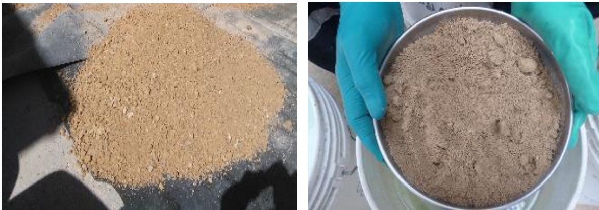
Fotografía 4. Análisis granulométrico en tamiz de la malla 200M con la alteración SGC.
