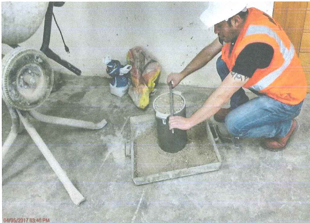
Fotografía N° 10: Enrazado con la varillas de 5/8" el material fino ya compactado
