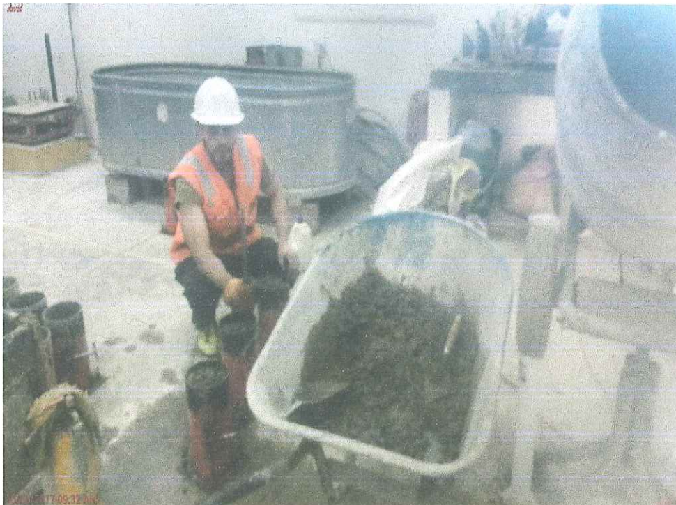
Fotografía N° 28: Vaciando el concreto en los moldes cilíndricos.
