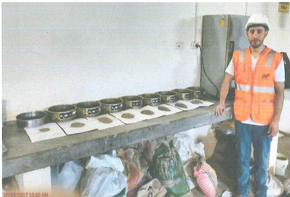
Fotografía N° 4: Material ya tamizando del agregado fino
