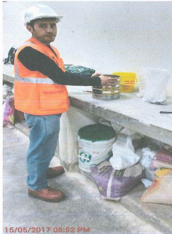
Fotografía N° 17: Tamizando el material por la malla N°4, para realizar el ensayo de abrasión
