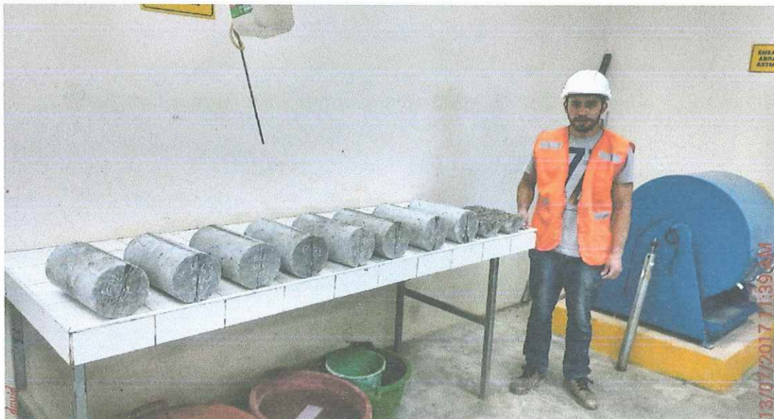
Fotografía N° 36 Probetas a tracción ya ensayadas
