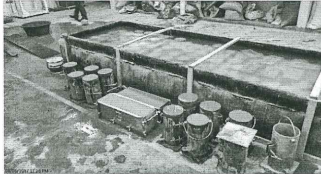
Figura N° 21: Especímenes de concreto ya encofrados durante 24 horas.
