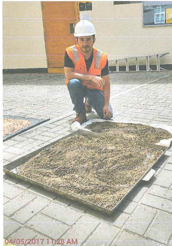
Fotografía N° 7: Secando material fino 23.000 kg para realizar el ensayo de peso unitario
