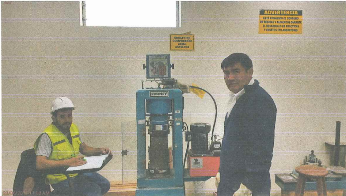
Fotografía N° 31: Realizando el ensayo a compresión de las probetas.
