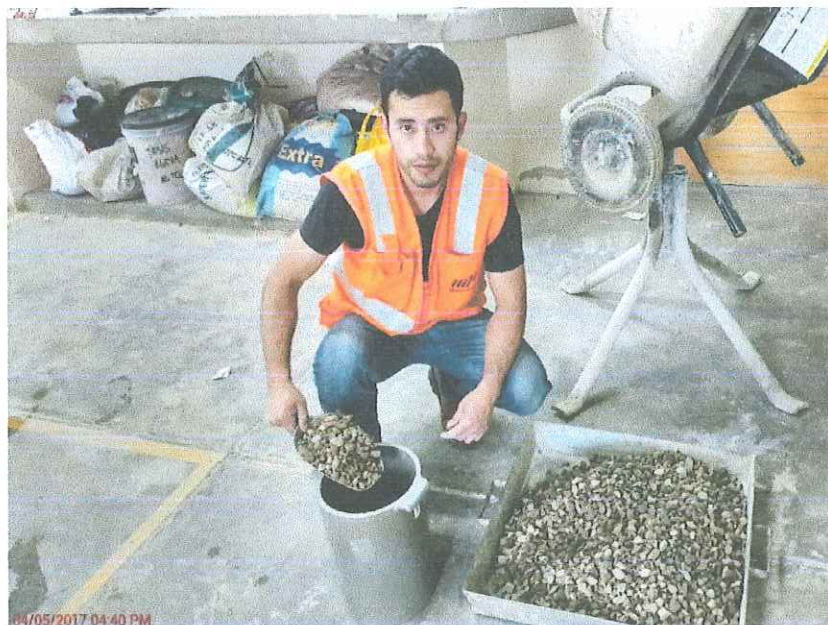
Fotografía N° 12: Agregando material al molde para luego ser compactadas con una varilla de 5/8"
