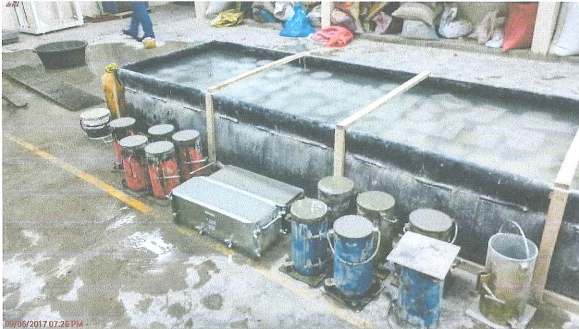
Fotografía N° 29: Moldes llenos de concreto durante 24 horas.
