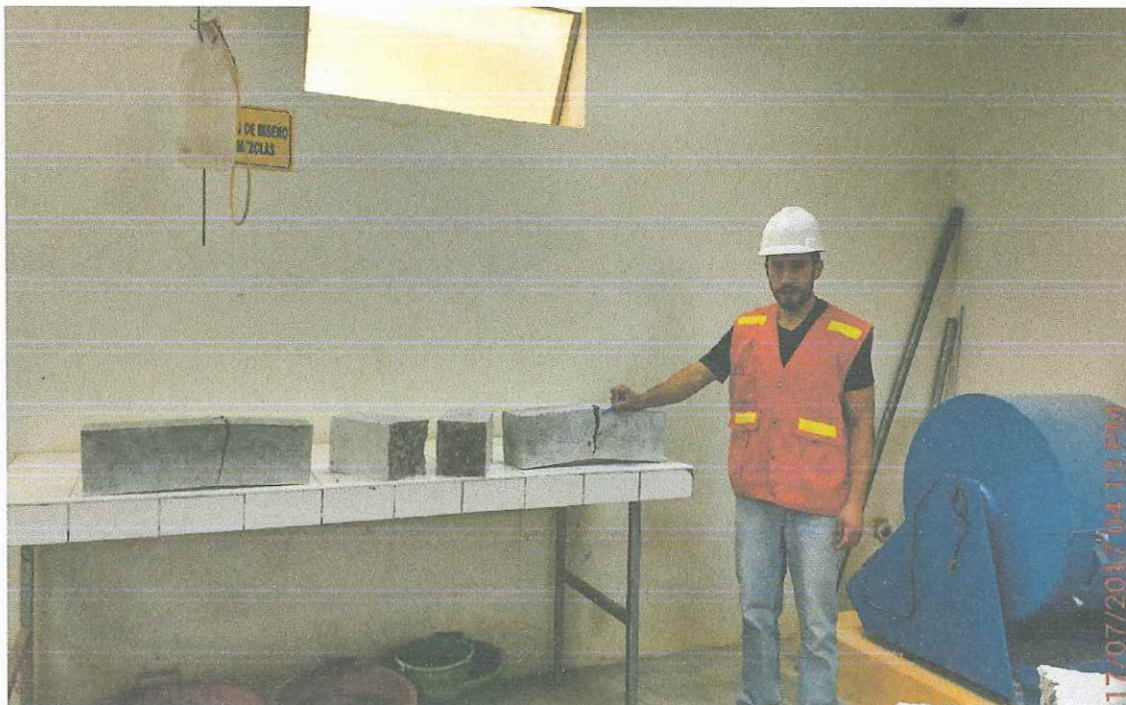
Fotografía N° 34: Realizando el ensayo a flexión de las vigas
