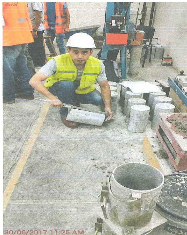
Fotografía N° 30: Medición de las probetas antes de ser ensayadas.
