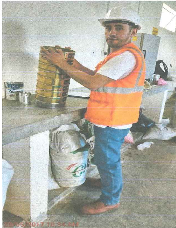
Fotografía N° 3: Tamizando muestra del agregado fino
