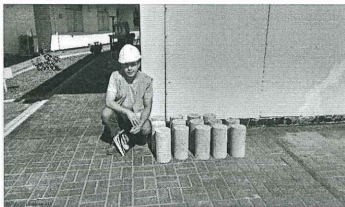
Figura N° 22: Desencofrado de los especímenes para luego curarse en la poza.
