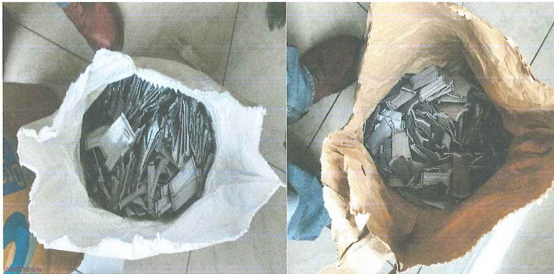
Fotografía N° 22: Bolsas de Sika y Dramix conteniendo las fibras metálicas
