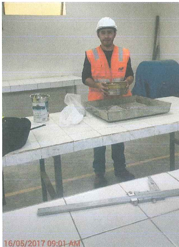
Fotografía N° 20: Tamizando el material luego de realizar el ensayo en la máquina de los ángeles.
