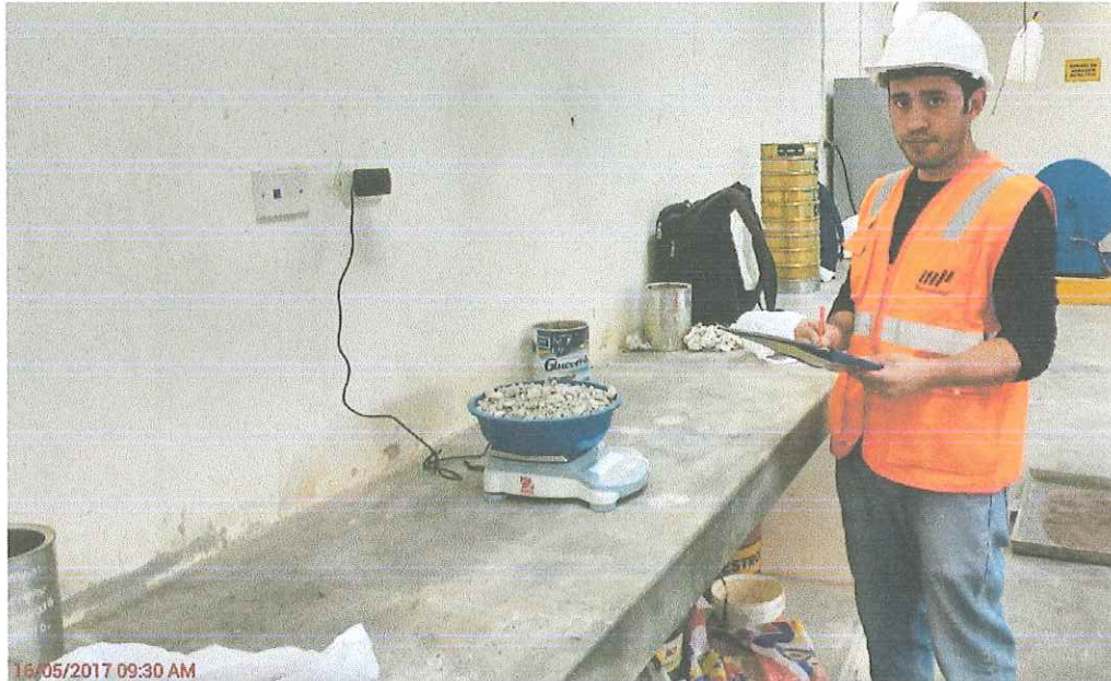
Fotografía N° 21: Material pesado luego de ser tamizado y ver su porcentaje de desgaste.
