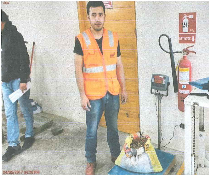
Fotografía N° 11: Pesando material grueso que se utilizara en el ensayo de peso unitario.
