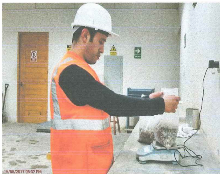
Fotografía N° 18: Pesando el material según el método B, un peso de 2.500 kg.
