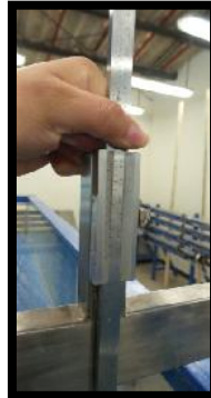
Fotografía 50. Vernier para medición de carga hidráulica
