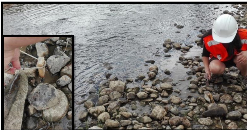
Fotografía 52. Cordel Marcado cada 0.50 m. y tensado en las estacas
