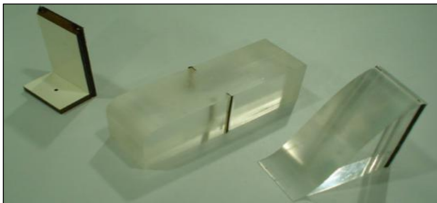
Figura 2. De izquierda a derecha, vertedero de pared delgada, de pared gruesa y vertedero de pared gruesa tipo cimacio (aliviadero)
