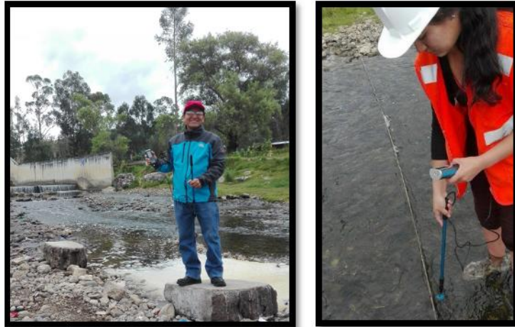
Fotografía 57. Toma de velocidades con correntómetro en la sección del río
