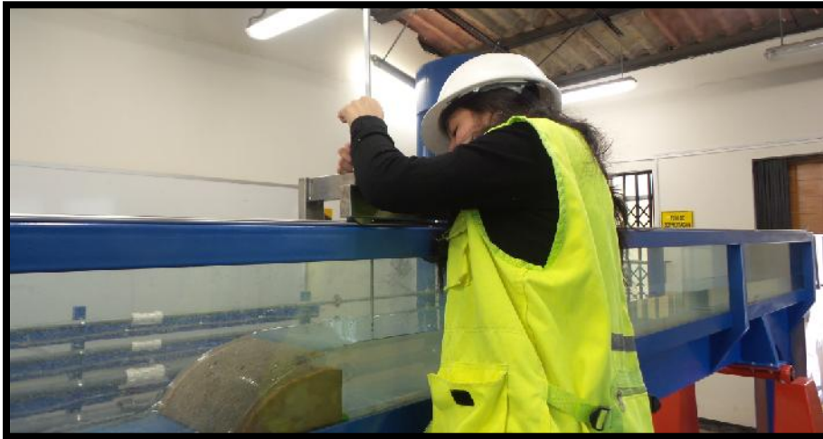
Fotografía 43. Ajuste del tornillo del vernier para la lectura de la carga hidráulica
