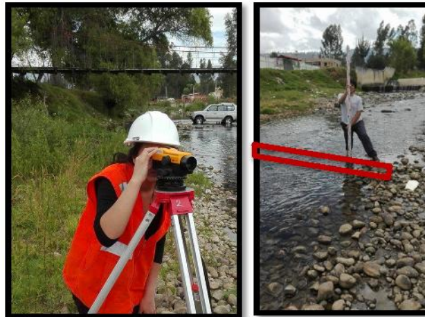
Fotografía 56. Toma de puntos de la sección del río
