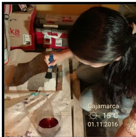
Fotografía 38. Impermeabilización de modelo de vertedero 7 (Primera capa)
