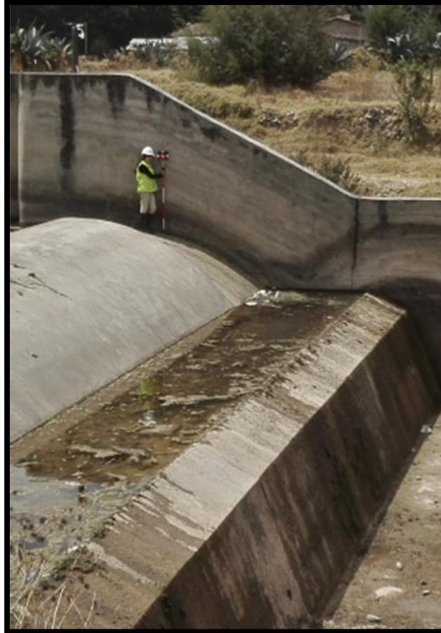
Fotografía 29. Puntos tomados para determinar la forma de la estructura
