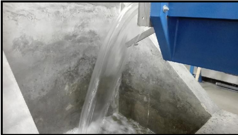
Fotografía 49. Alimentación de caudal por tubería hacia el canal de pendiente variable
