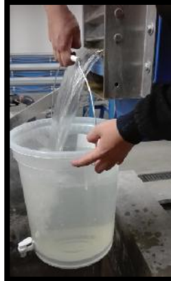
Fotografía 45. Aforo volumétrico volumen/ tiempo
