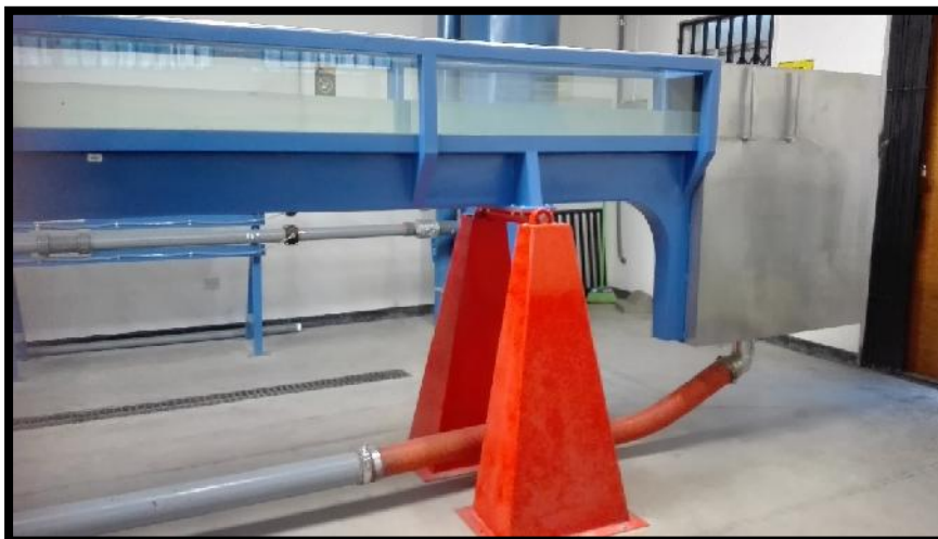
Fotografía 49. Alimentación de caudal por tubería hacia el canal de pendiente variable
