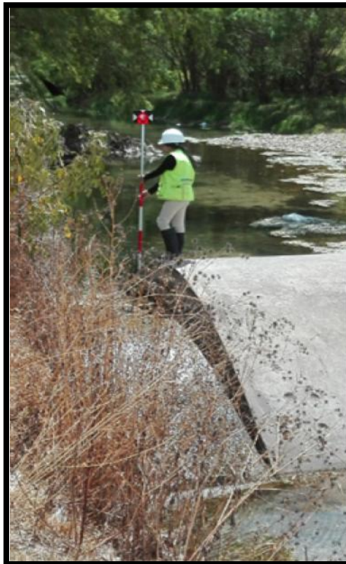
Fotografía 25. Puntos tomados para determinar la forma de la cresta del vertedero
