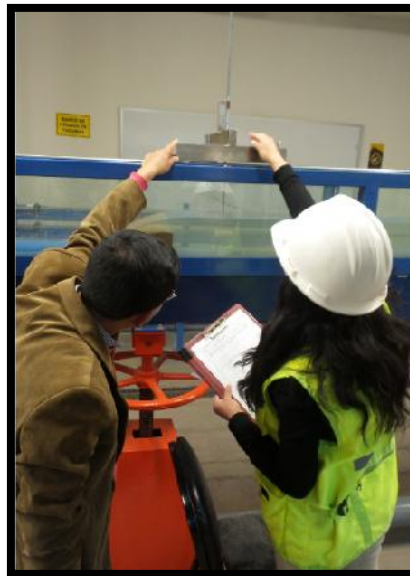
Fotografía 44. Ubicación del vernier para la lectura de la carga hidráulica
