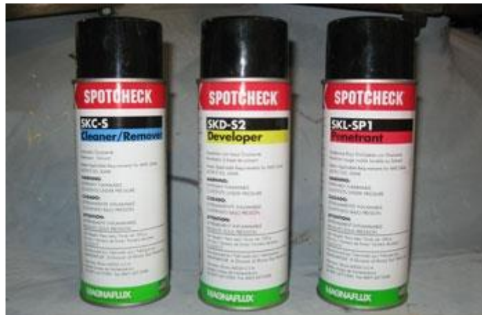
Figura n.º 53: Líquido penetrante, limpiador y revelador. Fuente: Solitec Peru
