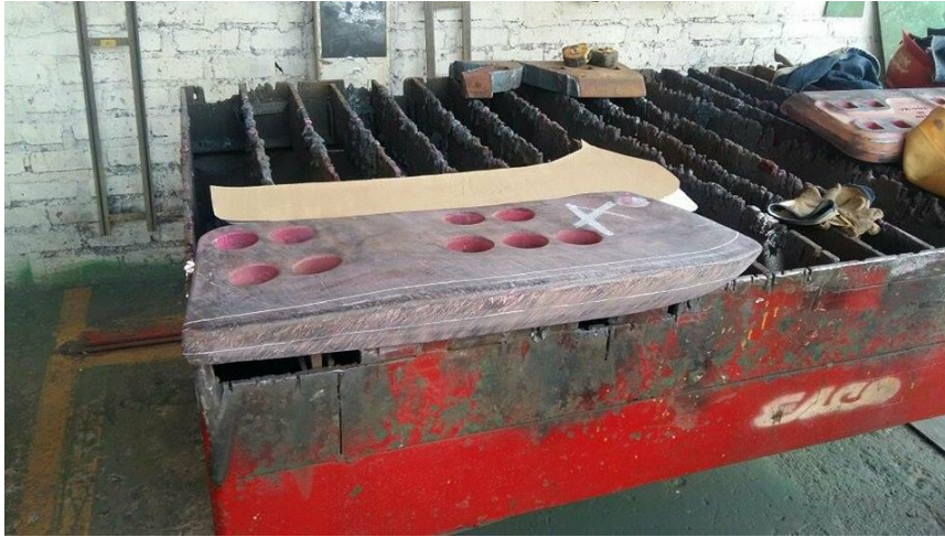
Figura n.º 46: Colocación de cantonera en mesa de habilitado.
