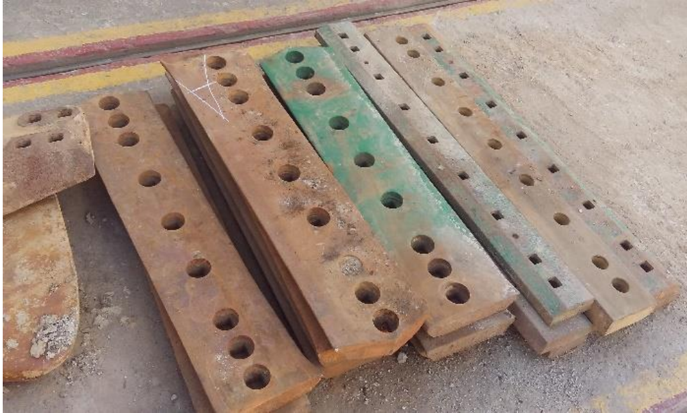
Anexo n.º 1: Cuchillas 24H antes de ser recuperadas
