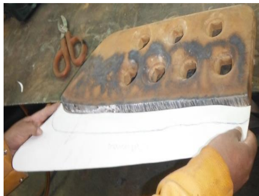
Figura n.º 11: Imagen de medición del nivel de desgaste de una cantonera Fuente: Esco Perú S.R.L.
