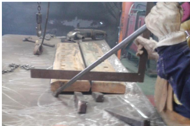
Figura n.º 20: Imagen de la medición de una cuchilla luego de ser biselada Fuente: Esco Perú S.R.L.
