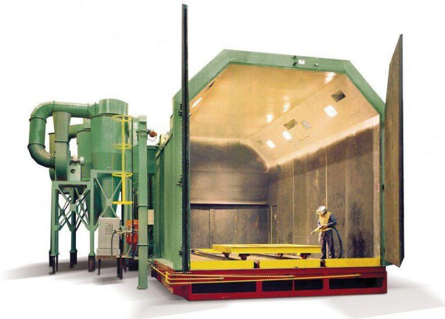
Figura n°13. Granallado Semiautomático
