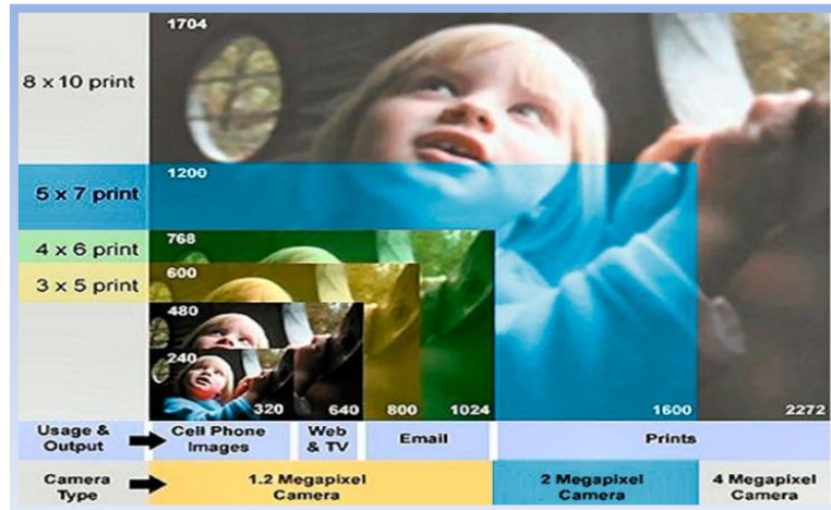
Figura N° 23: Resolución de la cámara en megapíxel Fuente: [URL 41]
