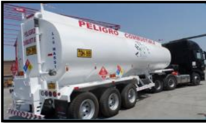
Figura 5. cisterna , una de las muchas variedades de camión, sirve tanto para transporte de elementos en estado líquido y gaseoso. Su mayor uso se da para transportar agua y combustibles como gasolina, queroseno, gas LP y otros.
