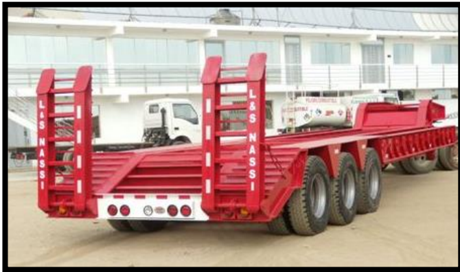
Figura 6. Cama baja , Plataforma no motorizada con una o más ejes, que se apoya en el tracto camión, acoplándose a éste por medio de la quina rueda o tornamesa, utilizados para transporte de carga larga con capacidad de 35 a 50 Tn.
