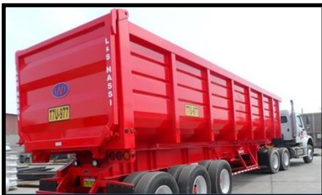
Figura 7. Tolva , Mayormente utilizado en la construcción destinada al transporte de materiales ligeros, su descarga puede ser posterior o lateral dependiendo de la gravedad.
