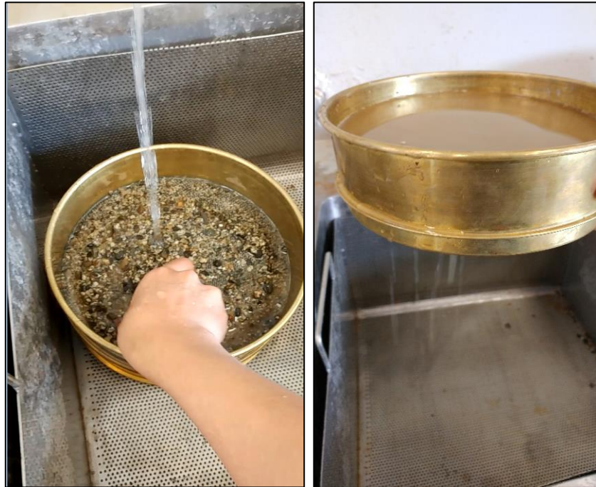
Figura N° 29: Materiales más finos que pasan por el tamiz N°200 por lavado.
