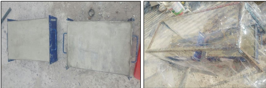
Figura N° 44: Cámara de ambiente controlado para el ensayo de contracción plástica
