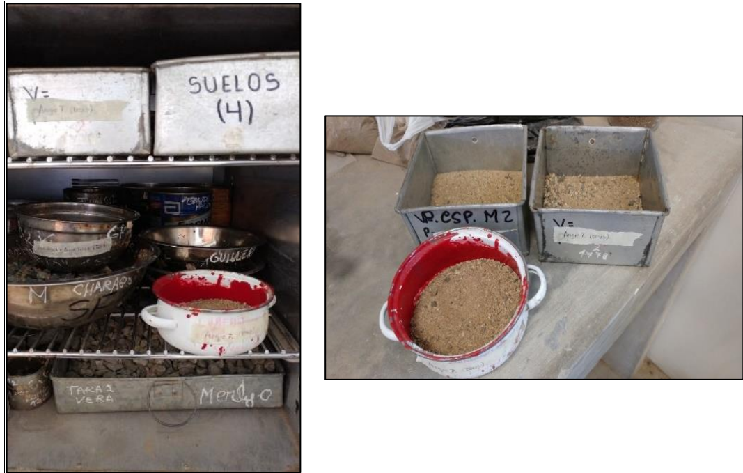
Figura N° 31: Contenido de humedad del agregado fino.
