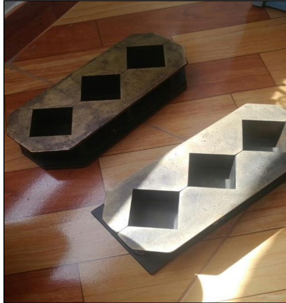
Figura N° 38: Moldes cúbicos de 50x50x50 mm para resistencia a la compresión
