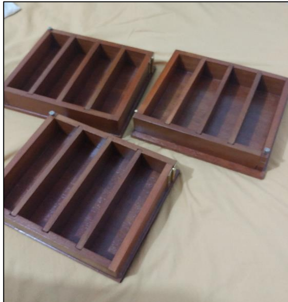
Figura N° 39: Probetas rectangulares de 40mmx40x160mm para resistencia a la flexión.
