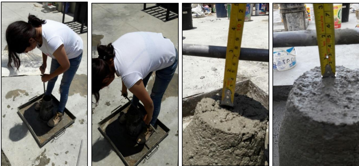
Figura N° 41: Ensayo de asentamiento del mortero mediante el cono de Abrahams.
