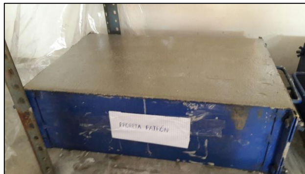
Figura N° 42: Conformación de paneles de mortero para ensayo de contracción plástica
