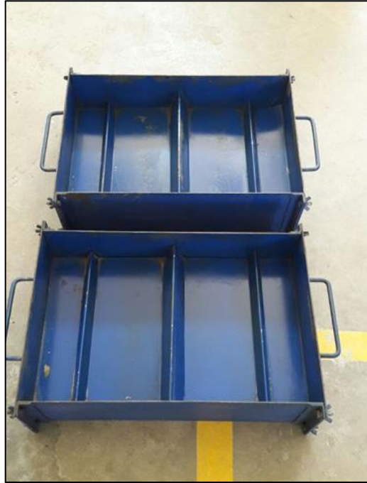
Figura N° 40: Paneles rectangulares de 56cmx36cmx11 cm para contracción plástica
