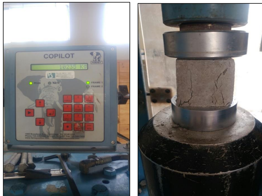
Figura N° 47: Ensayo de resistencia a compresión de los morteros a los 7 y 28 días
