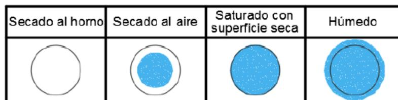
**Figura 9:** Condición de humedad del agregado fino. (Villarroel, 2017)
