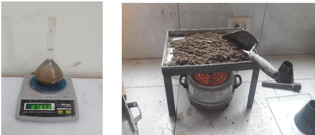
**Figura 28:** Peso específico y absorción por método de la fiola.
