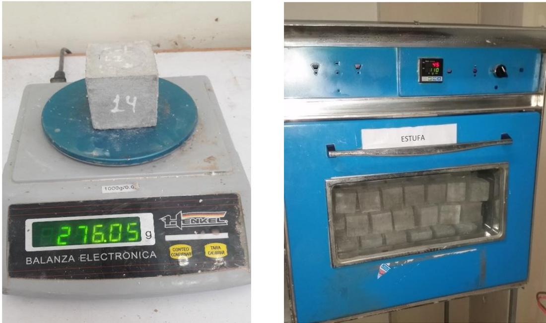
**Figura 31:** Peso seco para ensayo de absorción.
