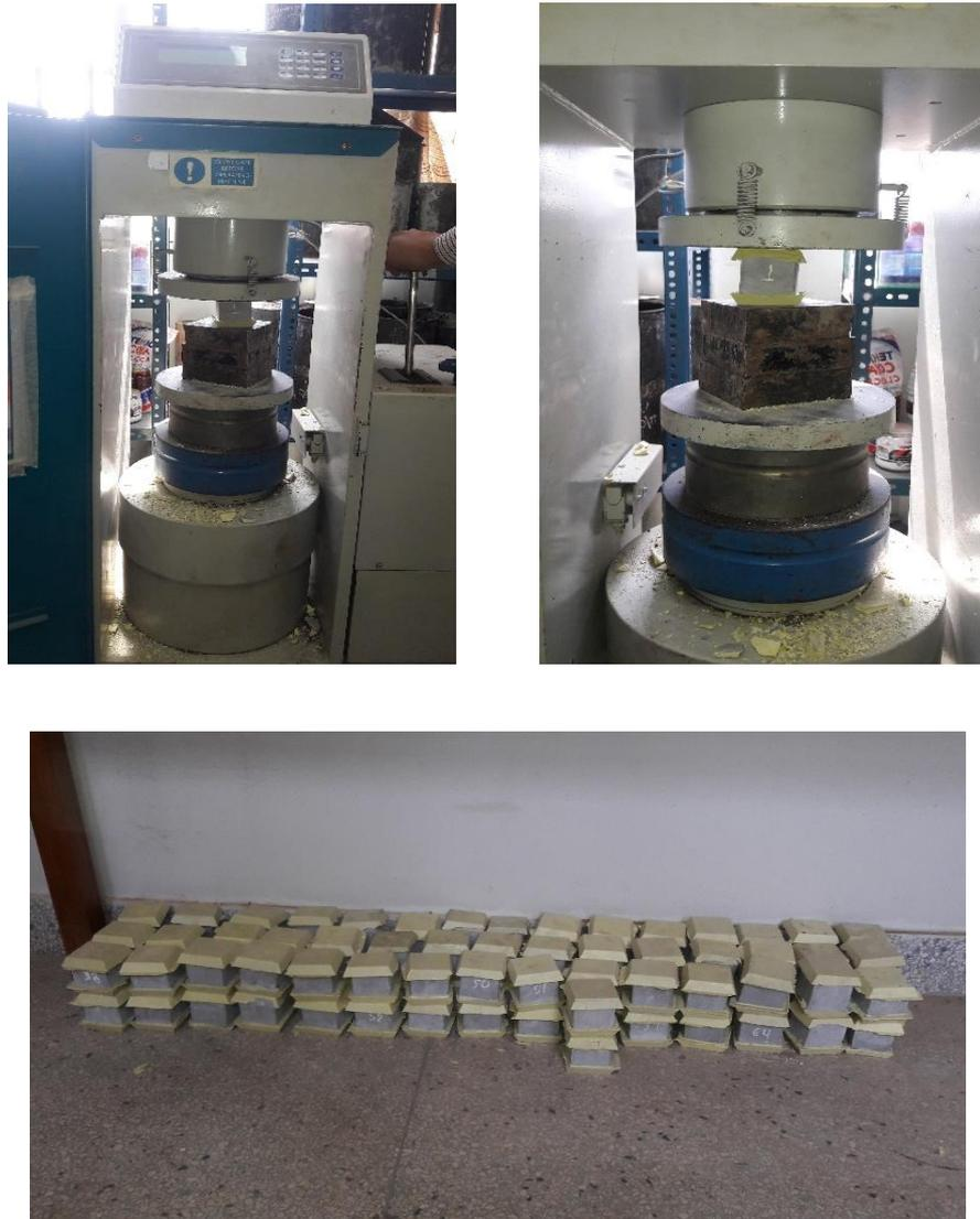
**Figura 33:** Ensayo de resistencia a la compresión.
