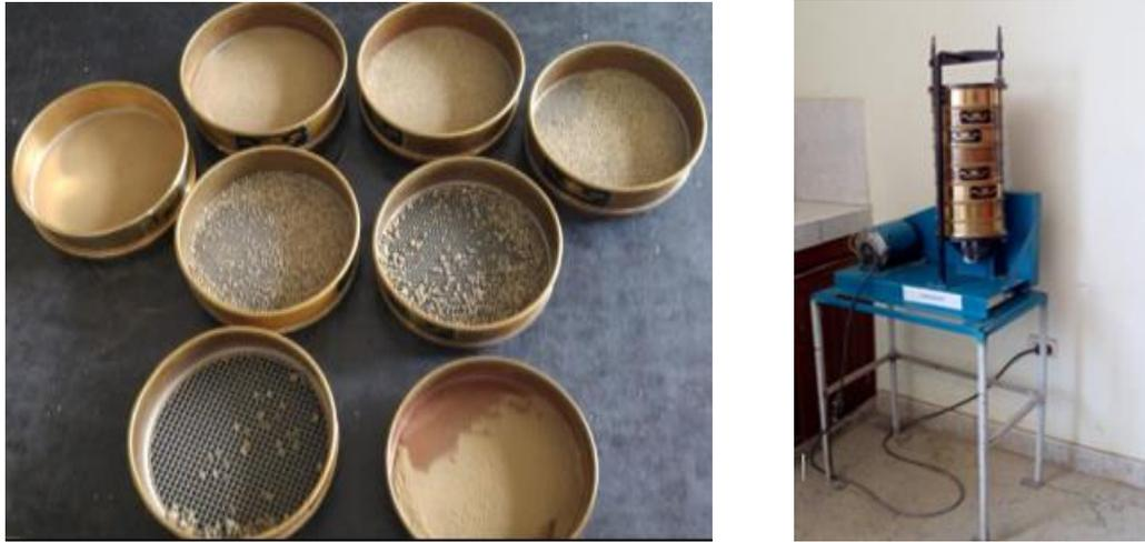
**Figura 27:** Análisis granulométrico del agregado fino, tamices en la mesa vibradora.
