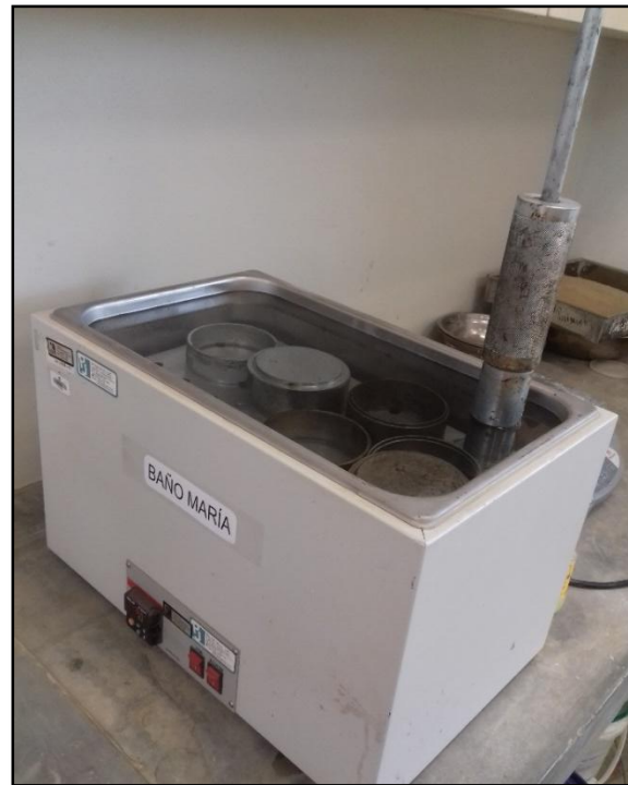
Figura 6.19: Colocación de moldes y martillo Marshall en baño María Fuente: Elaboración propia
