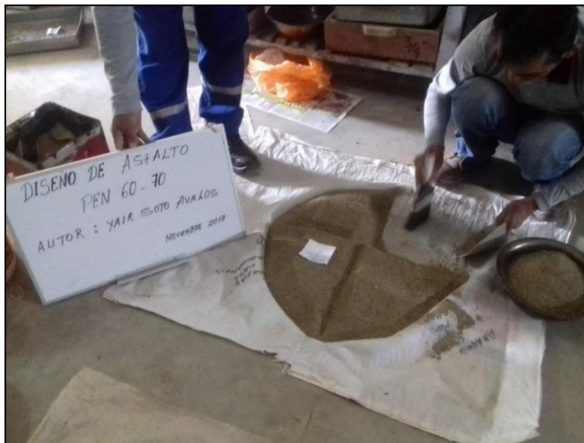
Figura 6.4: Cuarteo del agregado fino Fuente: Elaboración propia
