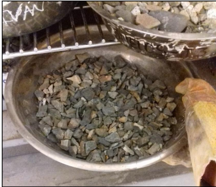
Figura 6.7: Muestra en el horno de agregado grueso para Contenido de Humedad Fuente: Elaboración propia
