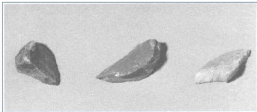
Figura 3.6: Partículas fracturadas Fuente: Manual de Ensayos de materiales MTC E 210
