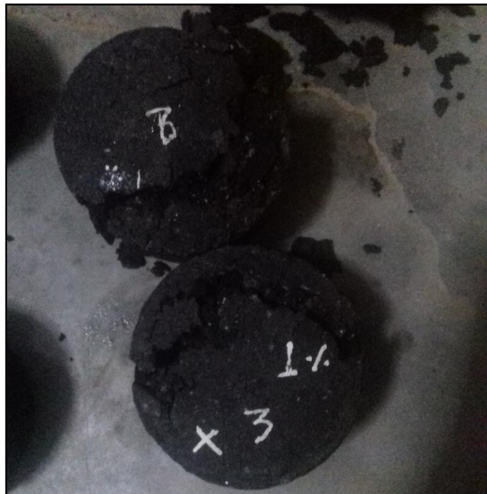
Figura 6.36: Probetas de mezcla asfáltica con caucho después de la Prensa Marshall Fuente: Elaboración propia
