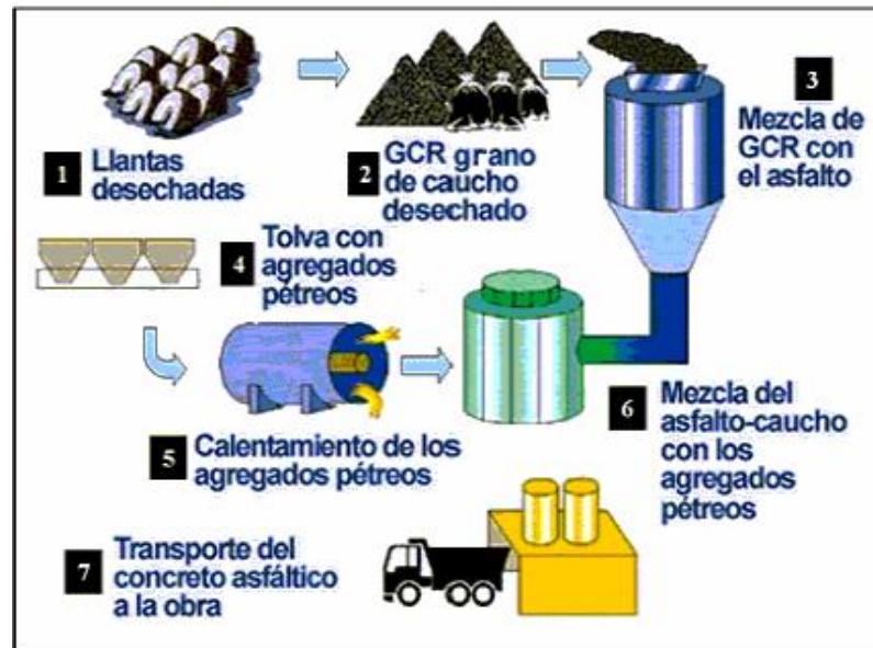
Figura 2.14: Esquema de fabricación de asfalto modificado con caucho mediante el proceso por vía húmeda
