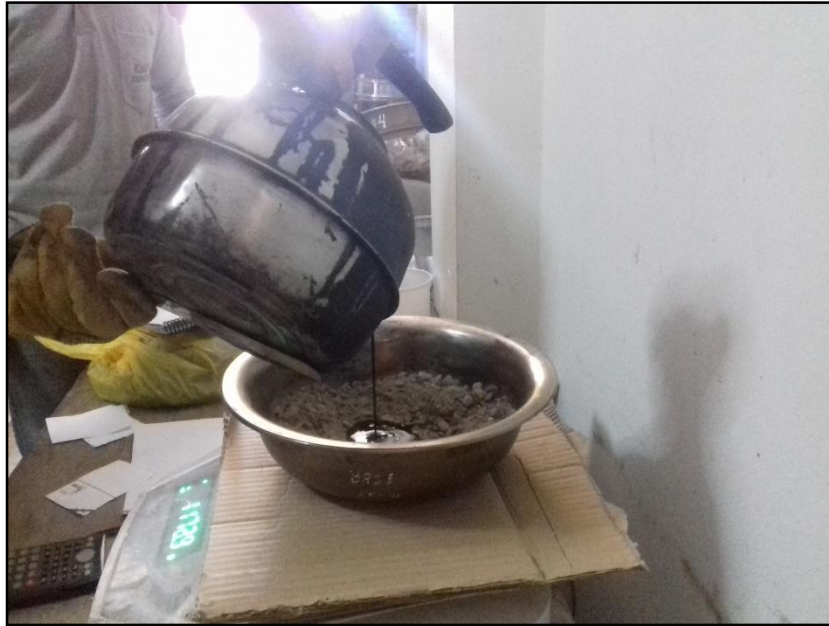
Figura 6.27: Adición de cemento asfáltico a la mezcla de agregados y caucho Fuente: Elaboración propia
