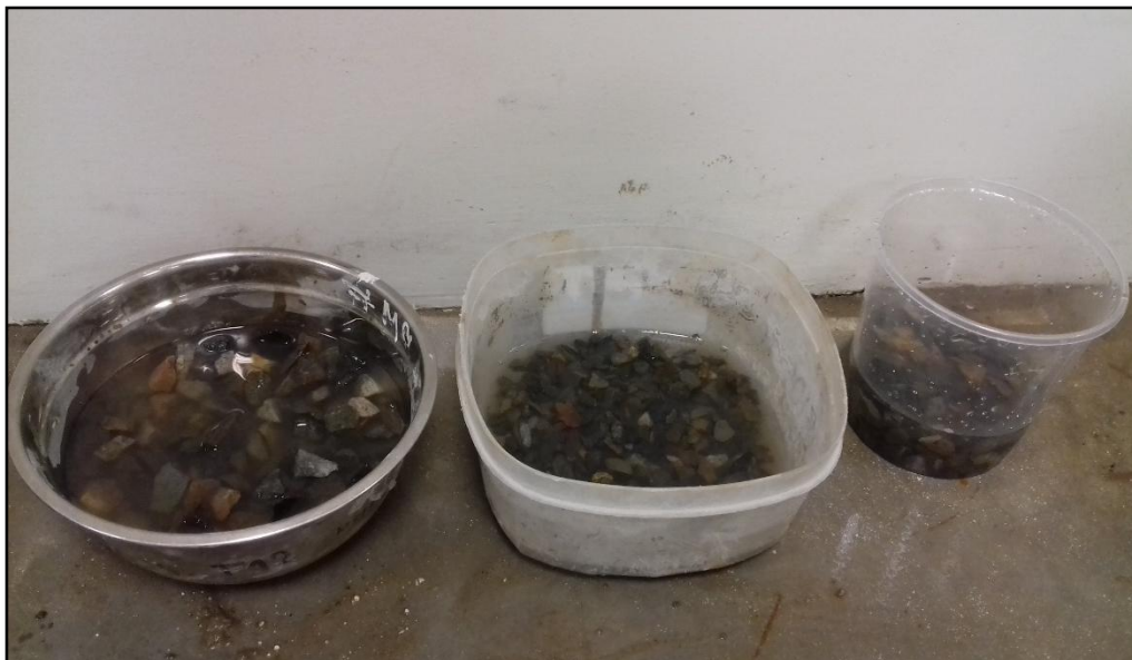
Figura 6.14: Inmersión de las muestras en la solución de Sulfato de Magnesio
