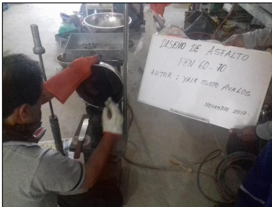
Figura 6.20: Vaciado de mezcla asfáltica en moldes pre-calentados Marshall Fuente: Elaboración propia
