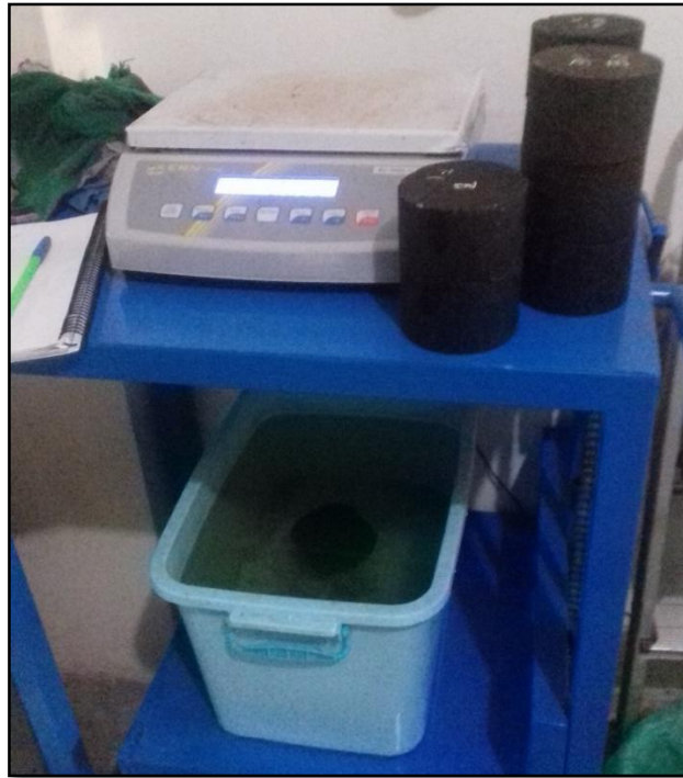
Figura 6.33: Peso unitario de probetas de mezcla asfáltica con caucho Fuente: Elaboración propia
