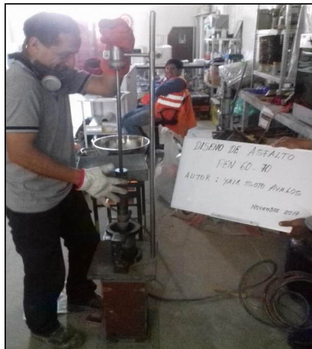
Figura 6.22: Compactación de probetas con martillo Marshall Fuente: Elaboración propia
