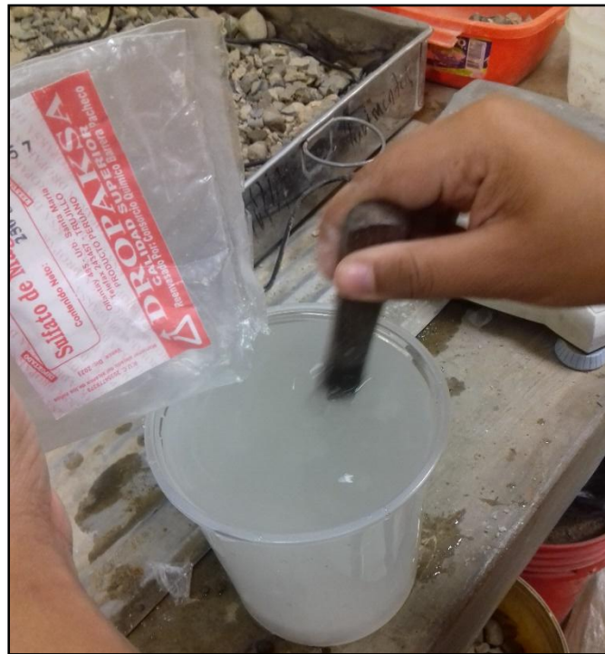
Figura 6.13: Preparación de solución para Durabilidad al Sulfato de Magnesio
