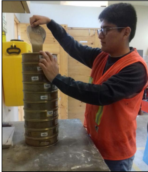
Figura 6.5: Análisis granulométrico para el agregado fino Fuente: Elaboración propia
