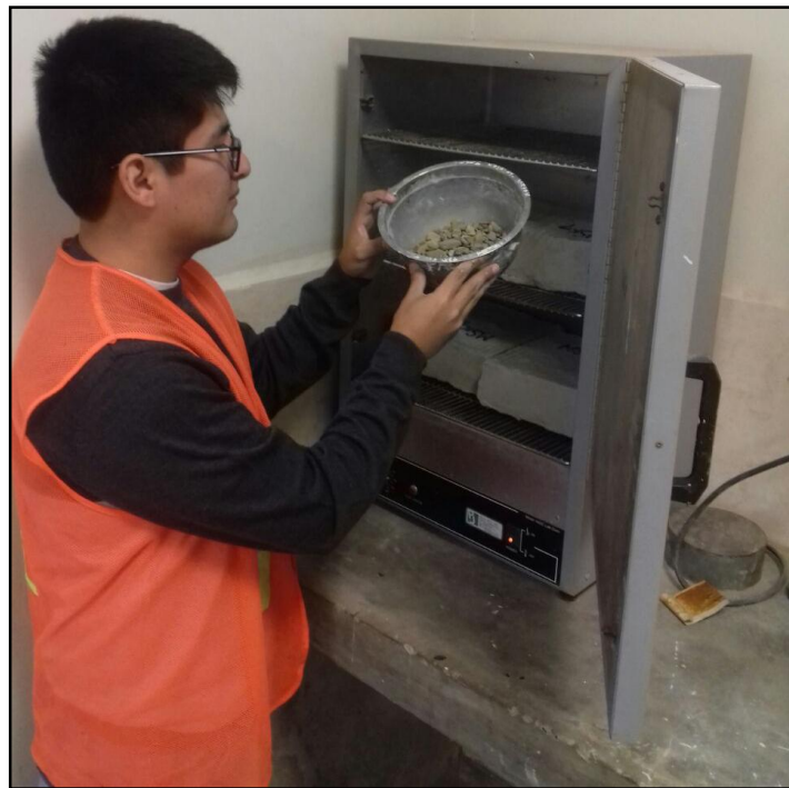
Figura 6.8: Muestra en el horno de agregado fino para Contenido de Humedad Fuente: Elaboración propia
