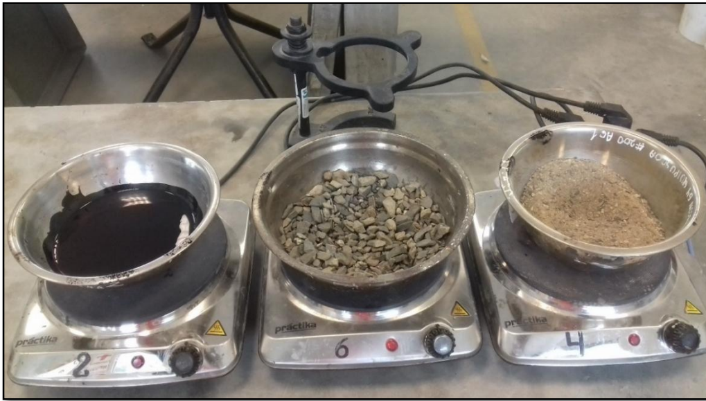
Figura 6.17: Calentamiento de materiales para elaboración de probetas Fuente: Elaboración propia
