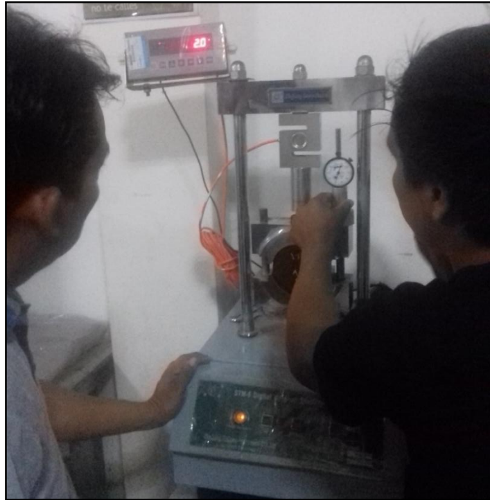
Figura 6.35: Estabilidad y flujo a través de prensa Marshall de probetas de mezclas asfálticas con caucho Fuente: Elaboración propia
