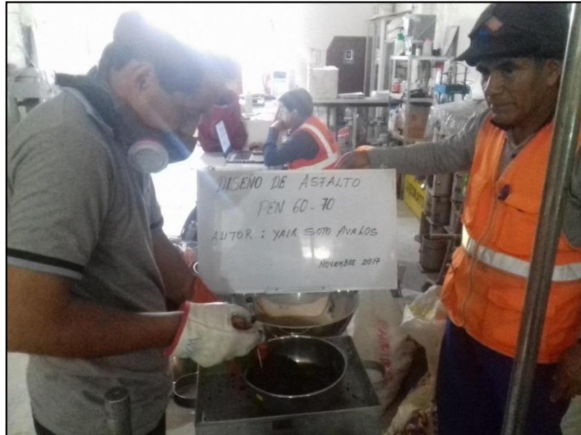
Figura 6.18: Mezcla de materiales para elaboración de probetas Fuente: Elaboración propia
