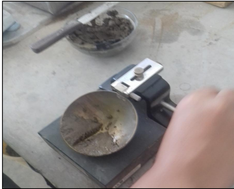
Figura 6.9: Límite de Consistencia – Limite Líquido Fuente: Elaboración propia
