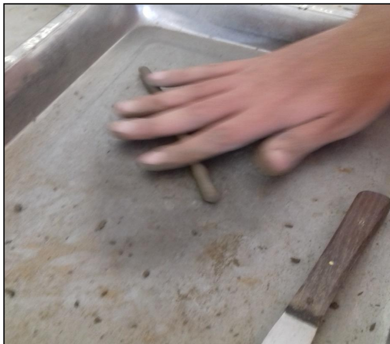
Figura 6.10: Límite de Consistencia – Limite Plástico Fuente: Elaboración propia
