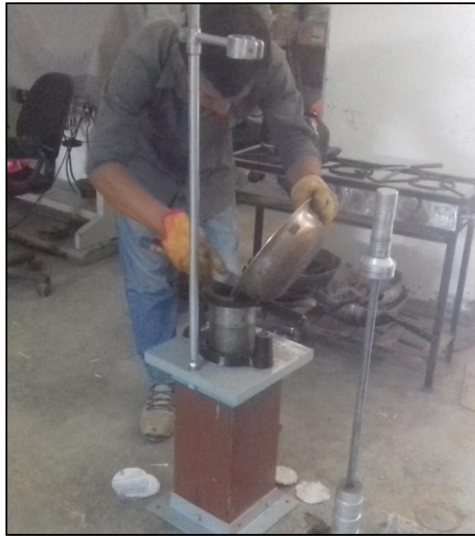
Figura 6.29: Vaciado de mezcla con caucho en moldes pre-calentados Marshall Fuente: Elaboración propia
