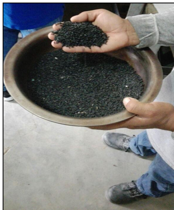
Figura 6.24: Caucho utilizado en la mezcla asfáltica Fuente: Elaboración propia
