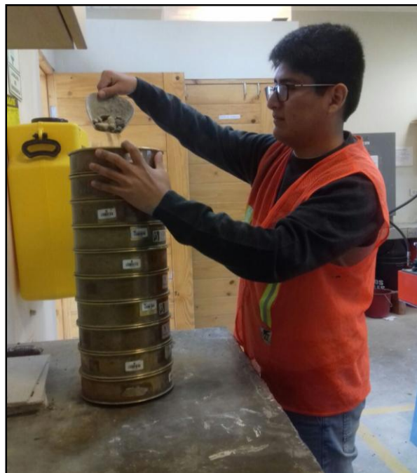
Figura 6.6: Análisis granulométrico para el agregado grueso Fuente: Elaboración propia
