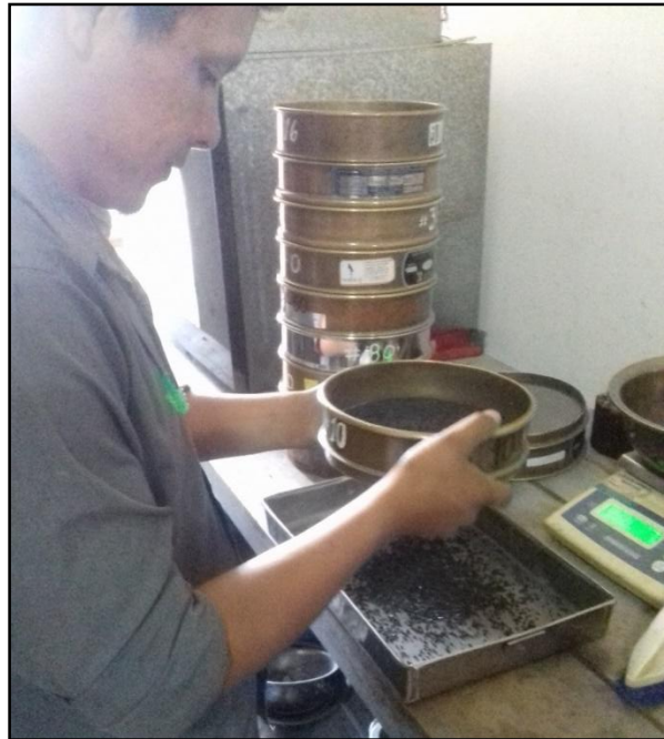
Figura 6.25: Ensayo granulométrico del caucho a utilizar Fuente: Elaboración propia
