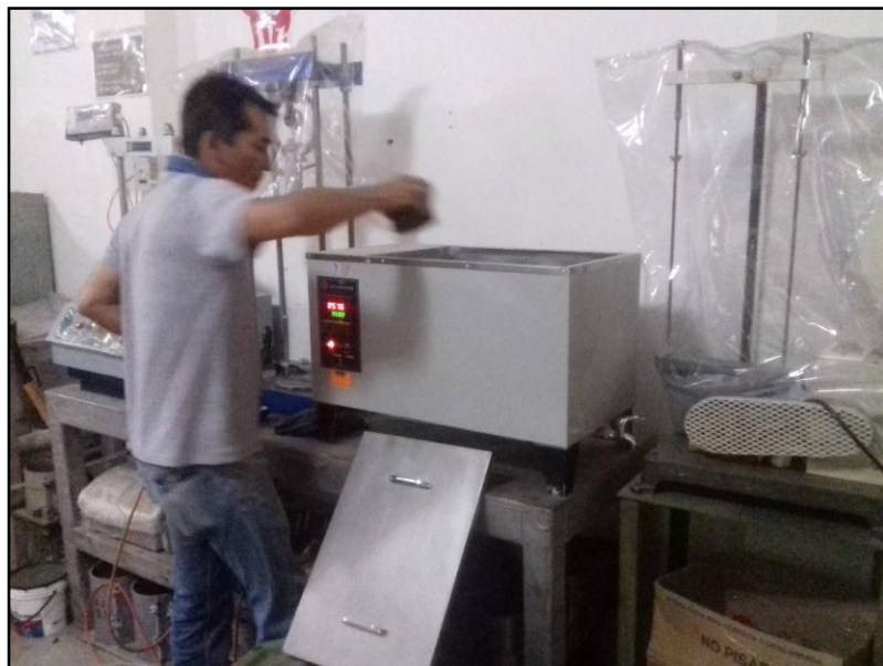
Figura 6.34: Colocación de probetas en baño maría Fuente: Elaboración propia
