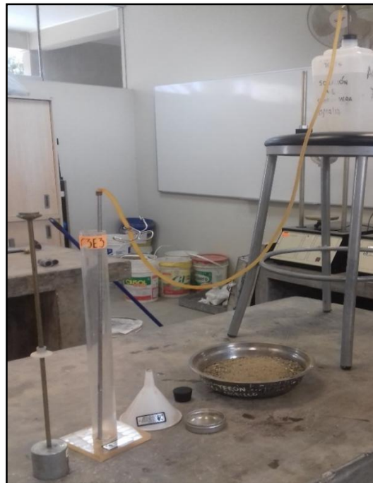
Figura 6.15: Equipos, materiales e insumos para Equivalente de arena Fuente: Elaboración propia
