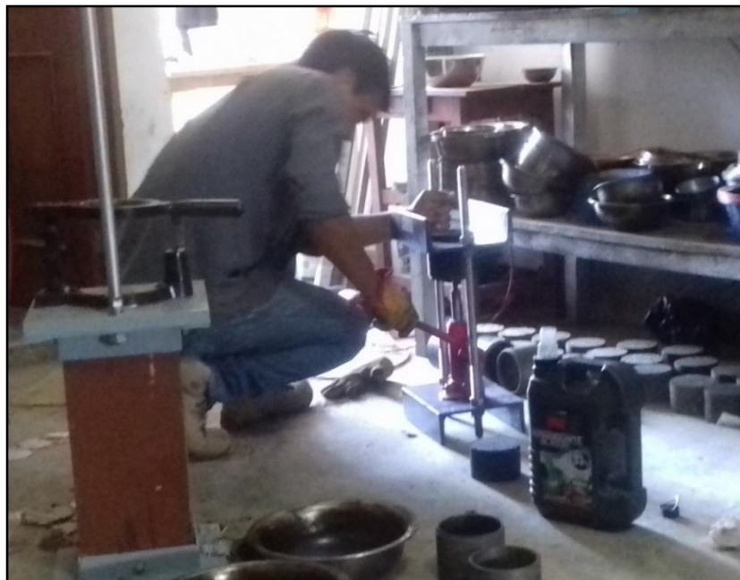
Figura 6.32: Extracción de probetas de mezcla asfáltica con caucho Fuente: Elaboración propia
