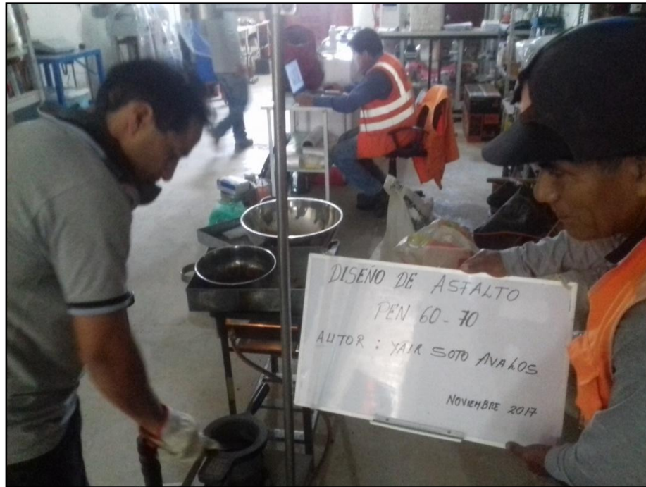
Figura 6.21: Chuseo de la mezcla asfáltica en caliente Fuente: Elaboración propia
