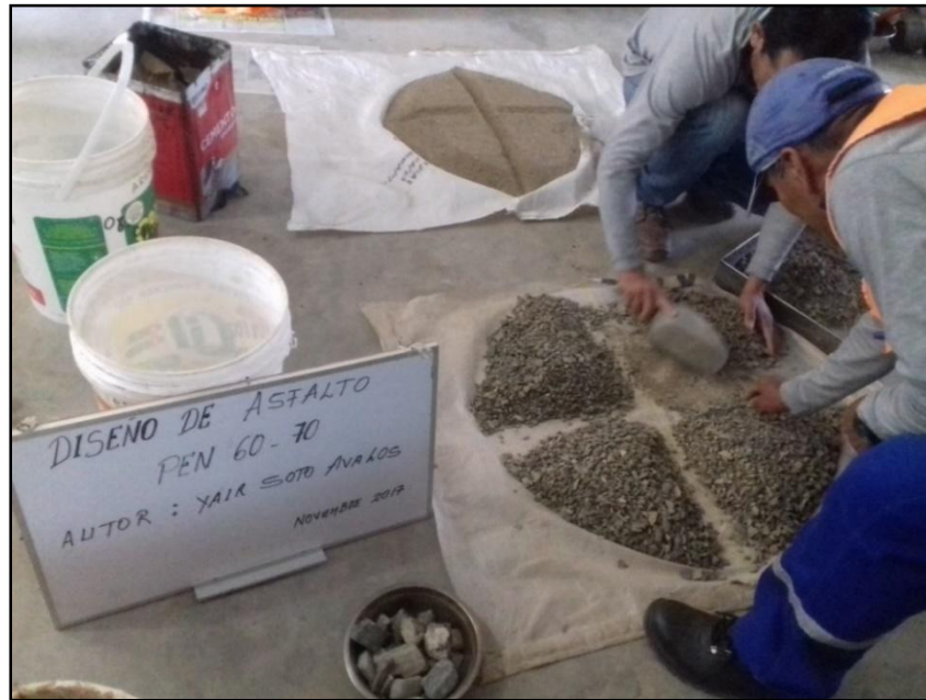
Figura 6.3: Cuarteo del agregado grueso Fuente: Elaboración propia
