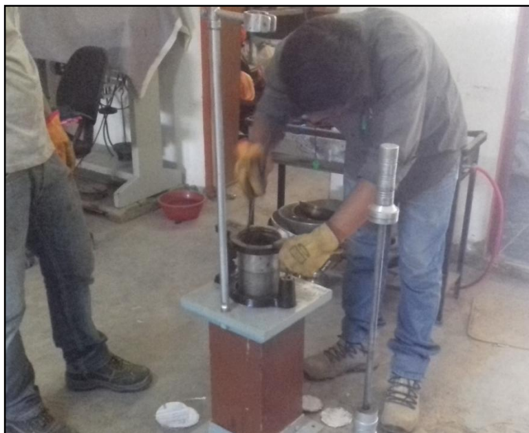
Figura 6.30: Chuseo de la mezcla asfáltica con caucho Fuente: Elaboración propia
