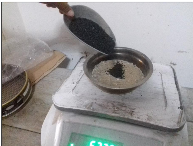
Figura 6.26: Incorporación de caucho a los agregados pétreos Fuente: Elaboración propia
