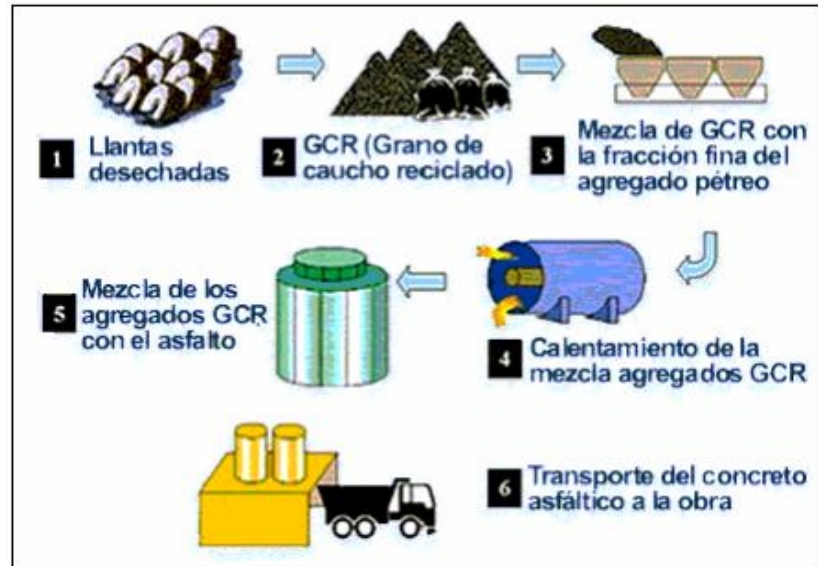
Figura 2.15: Esquema de fabricación de la mezcla asfáltica con caucho por vía seca.
