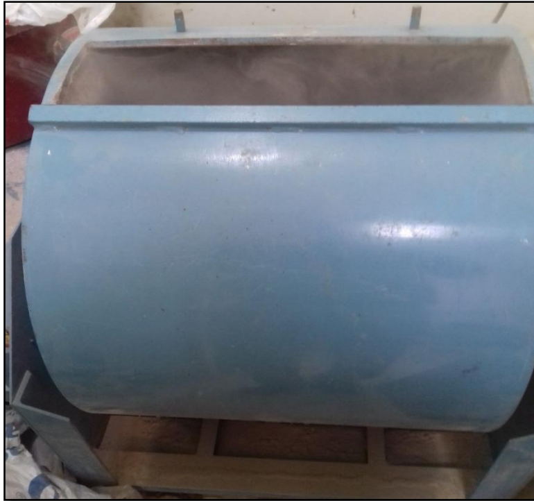
Figura 6.11: Ensayo Abrasión Los Ángeles Fuente: Elaboración propia
