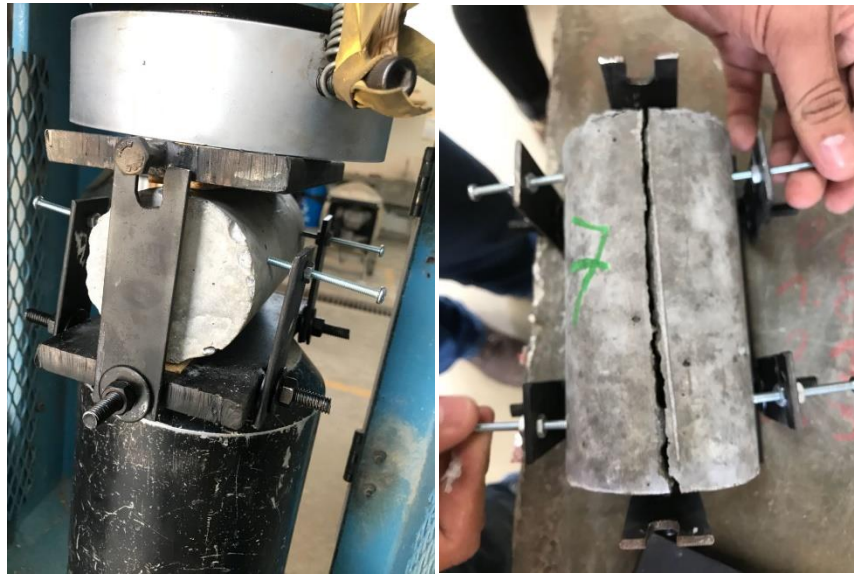
Figura N°44 Ensayo de resistencia a tracción
