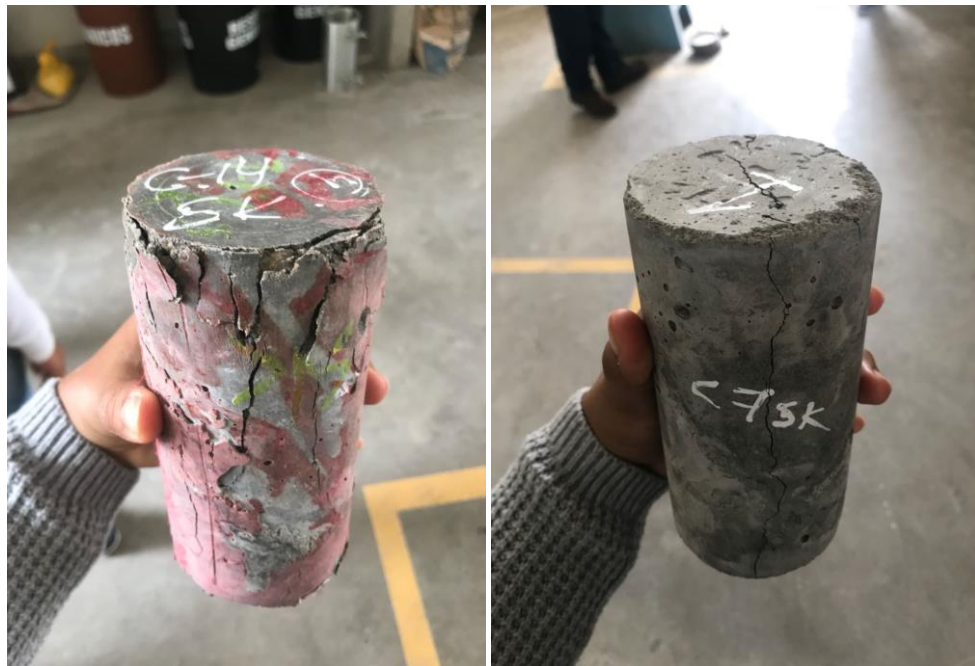
Figura N°45 Análisis de probetas después de ensayos
