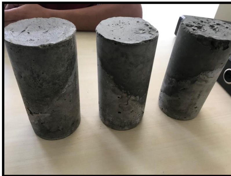
Figura N°41 Probetas de concreto para ensayos
