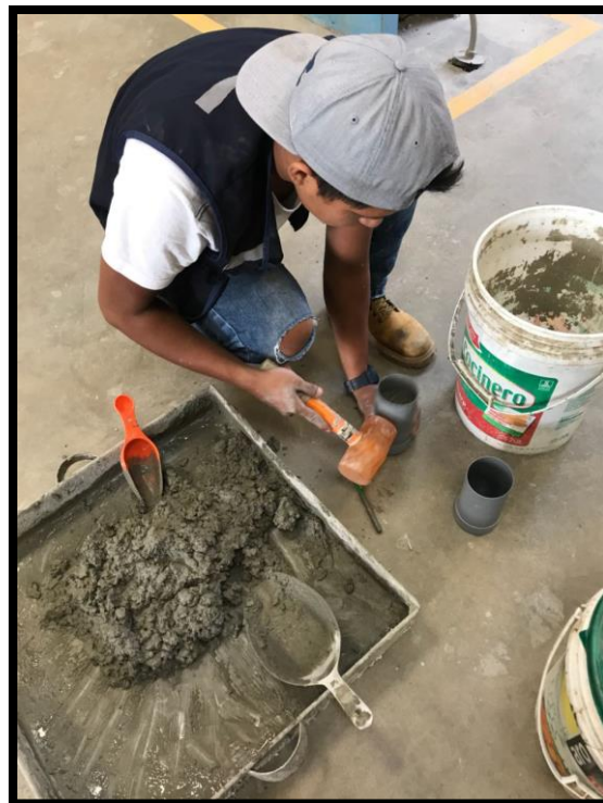
Figura N°37 Elaboración de mezcla de concreto para muestras
