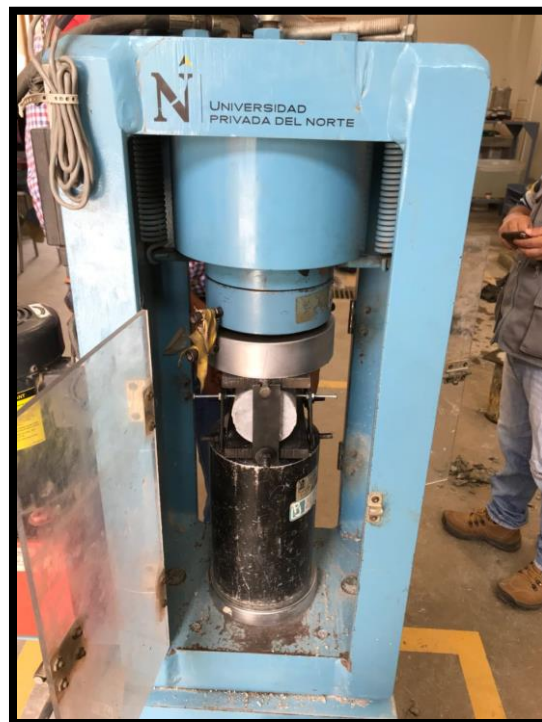
Figura N°43 Ensayo de resistencia a la tracción
