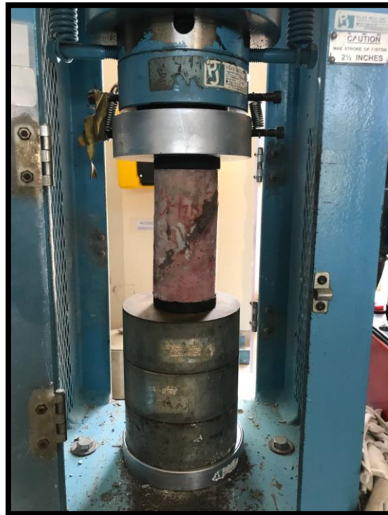
Figura N°42 Ensayo de resistencia a la compresión
