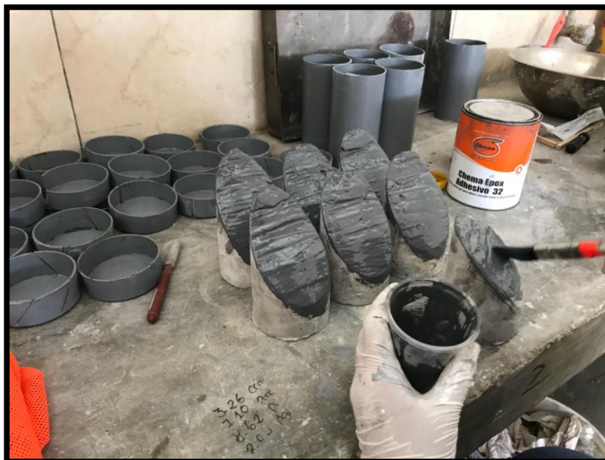
Figura N°39 Productos adherentes aplicados en la mitad del concreto a 28 días
