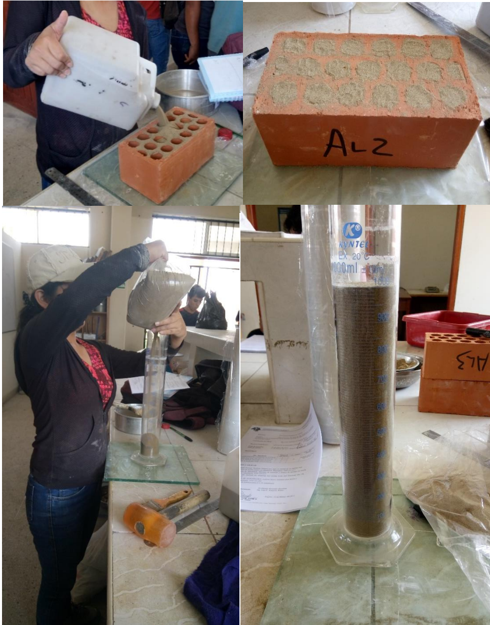
Figura 41: Ensayo de porcentaje de vacíos.
