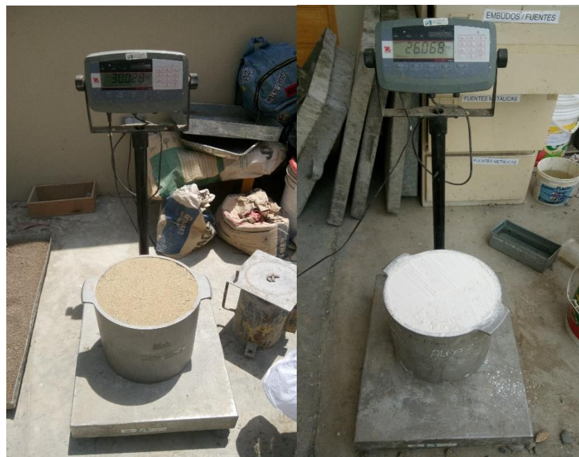
Figura 33: Determinación del peso unitario suelto y compactado de arena y mármol.
