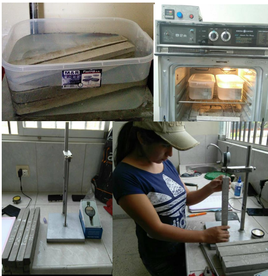
Figura 36: Ensayo de reactividad.
