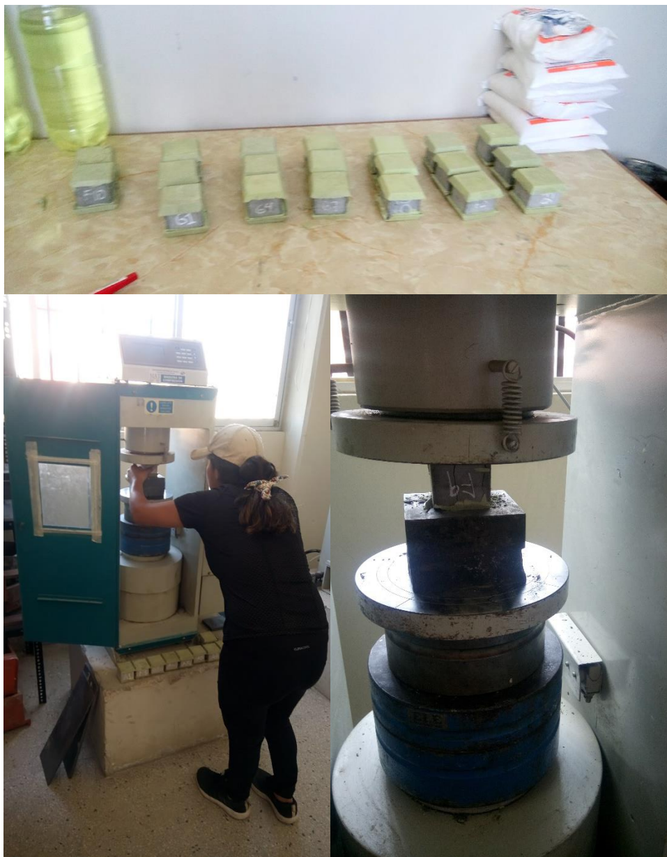
Figura 38: Ensayo de resistencia a compresión de probetas de mortero.
