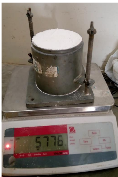
Figura 31: Determinación del peso específico del mármol.
