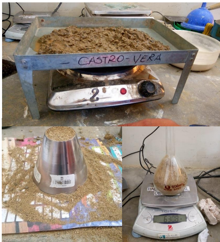
Figura 30: Determinación del peso específico y absorción de la arena.
