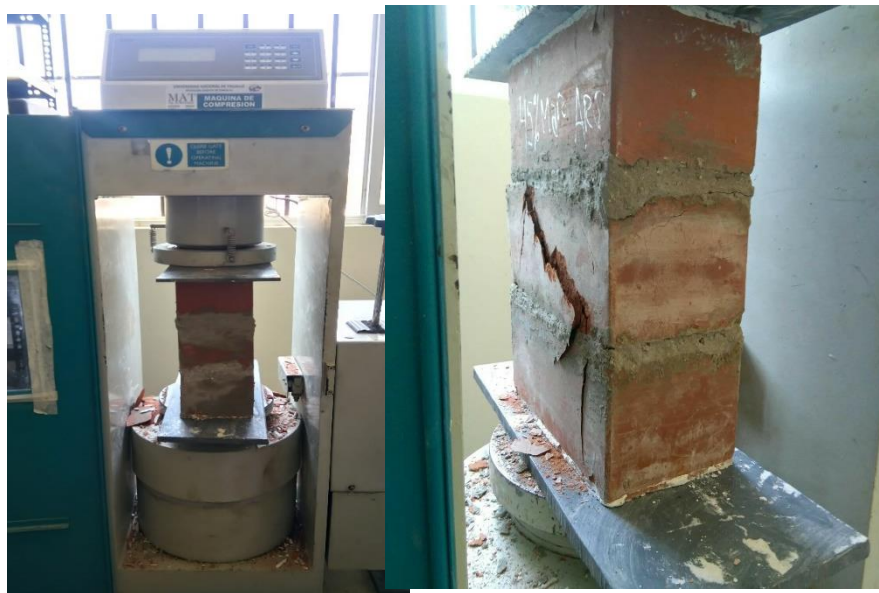
Figura 45: Ensayo de resistencia a compresión de pilas.
