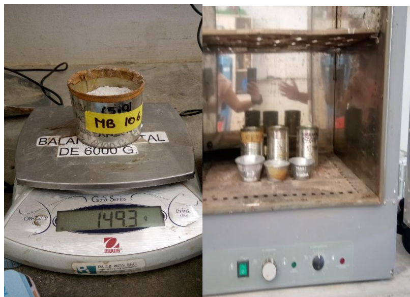
Figura 29: Determinación del contenido de humedad de arena y mármol.
