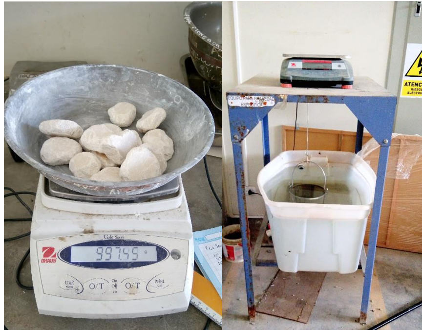
Figura 32: Determinación de la absorción del mármol.
