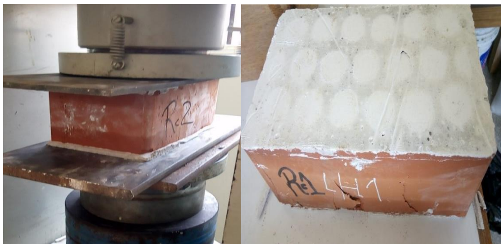
Figura 43: Ensayo de resistencia a compresión de unidades.
