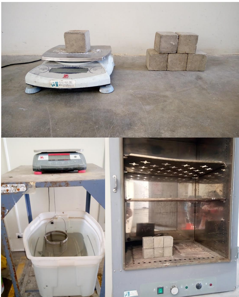
Figura 37: Ensayo de densidad de probetas de mortero.
