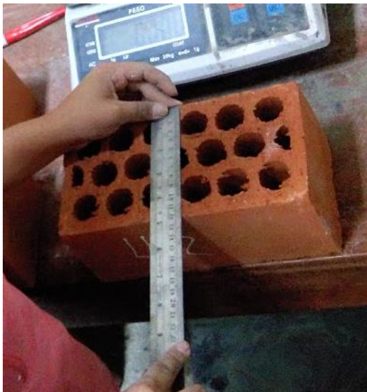
Figura 39: Ensayo de variación dimensional.
