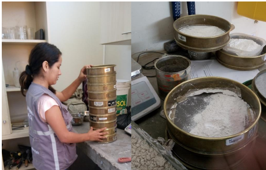
Figura 28: Determinación de la granulometría de arena y mármol.
