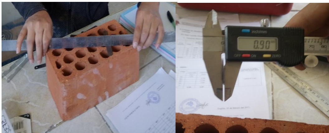
Figura 40: Ensayo de alabeo.
