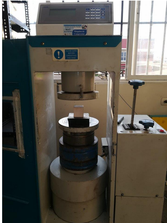
Figura N° 57: Ensayo de resistencia a la compresión.
