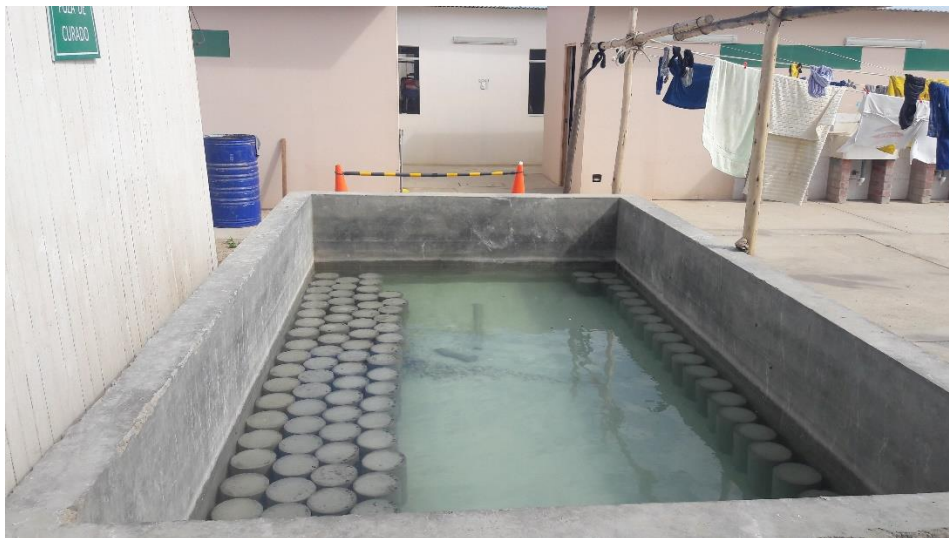
Figura 23: Colocación de Probetas en Poza de Curado Fuente: Autor de Tesis
