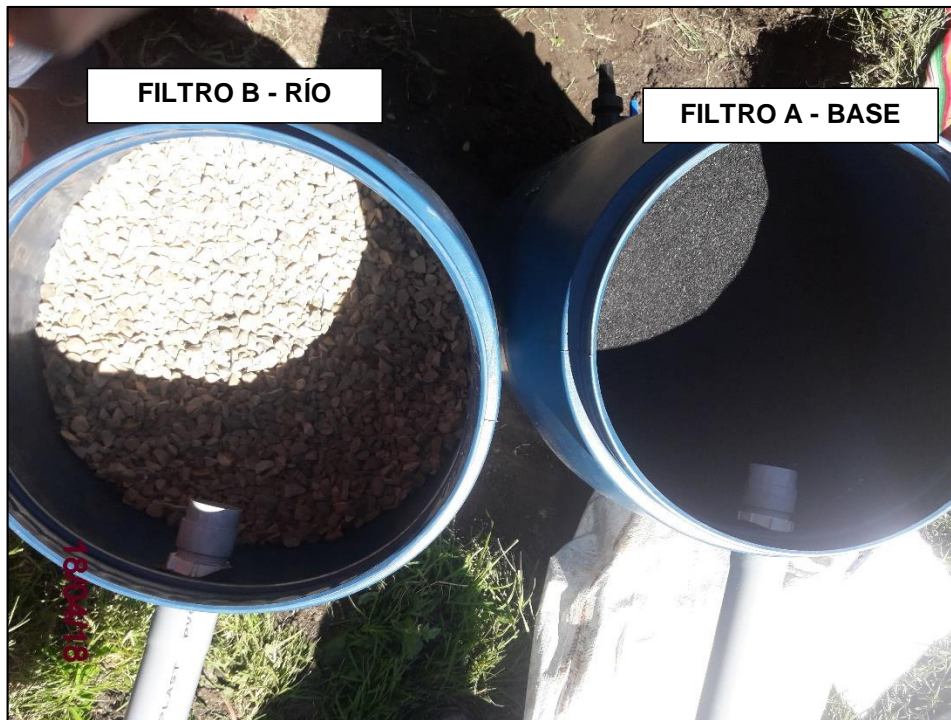
Fotografía N° 20: Filtro A (Capa de carbón activado) - Filtro B (Gravilla)
