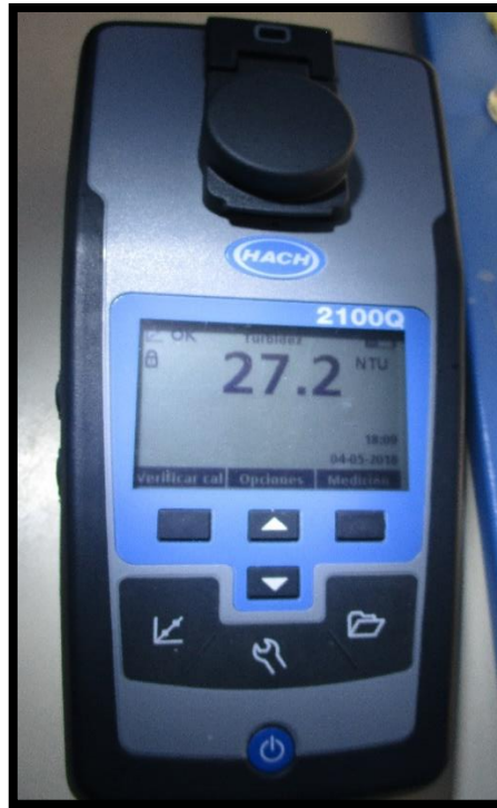
Foto N° 21. Turbidez final del agua en la primera prueba del primer ensayo haciendo uso del ECOPOL CS 600 floculante comercial.
