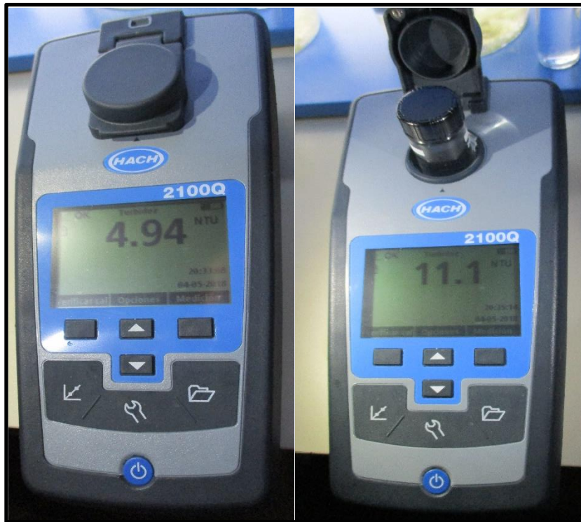
Foto N° 17. Turbidez final del agua en las 2 pruebas del segundo ensayo haciendo uso la Paleta de Tuna como floculante natural.
