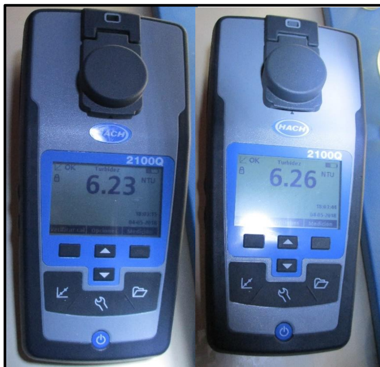
Foto N° 15. Turbidez final del agua en las 3 pruebas del primer ensayo haciendo uso la Paleta de Tuna como floculante natural.
