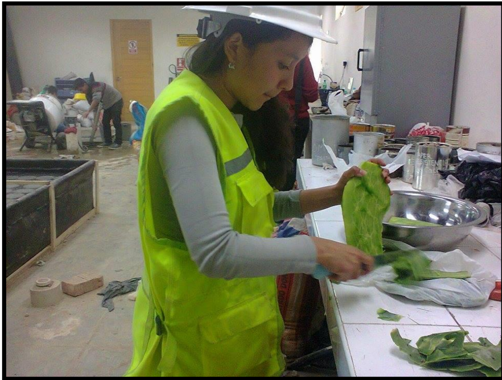
Foto N° 05. Proceso de obtención del floculante natural.
