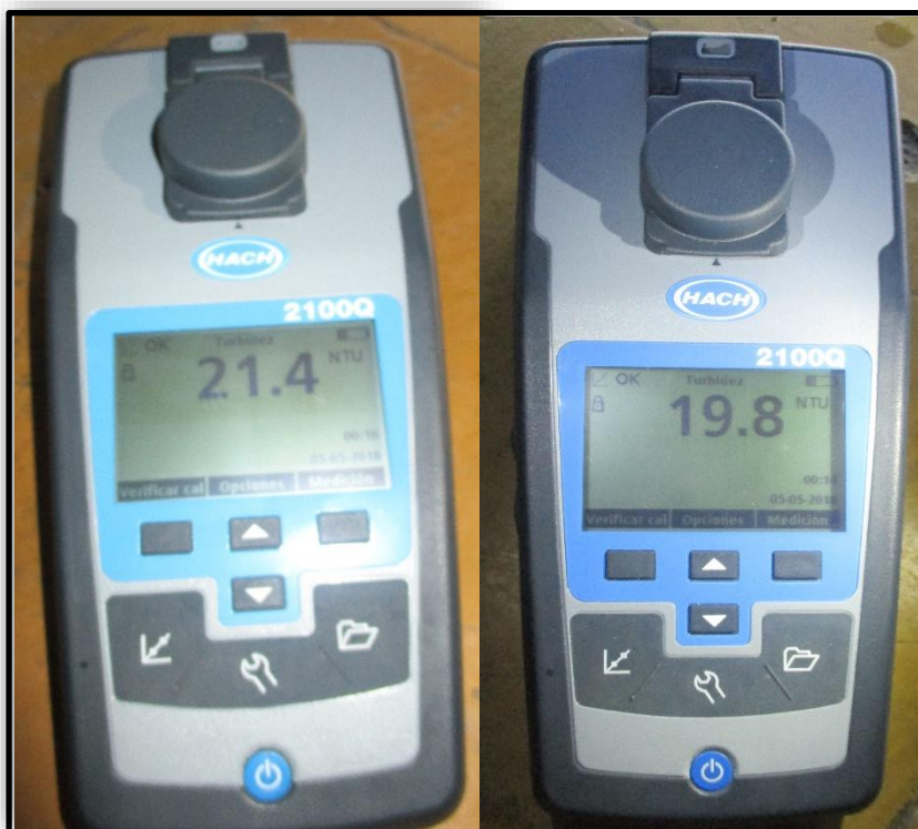
Foto N° 24. Turbidez final del agua en las 2 pruebas del tercer ensayo haciendo uso del ECOPOL CS 600 floculante comercial.
