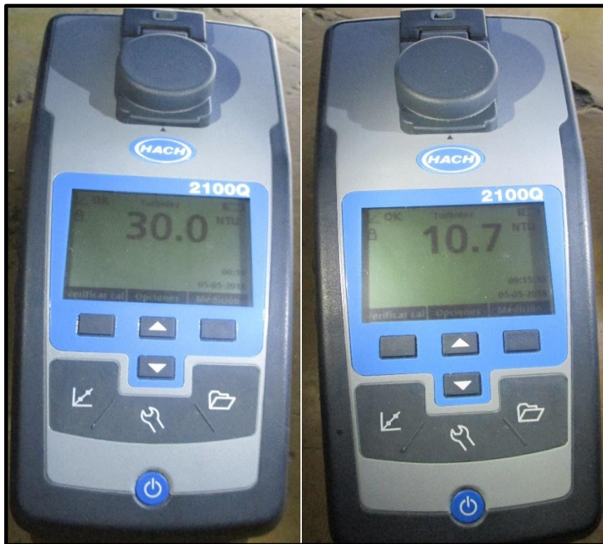
Foto N° 19. Turbidez final del agua en las 2 pruebas del tercer ensayo haciendo uso la Paleta de Tuna como floculante natural.
