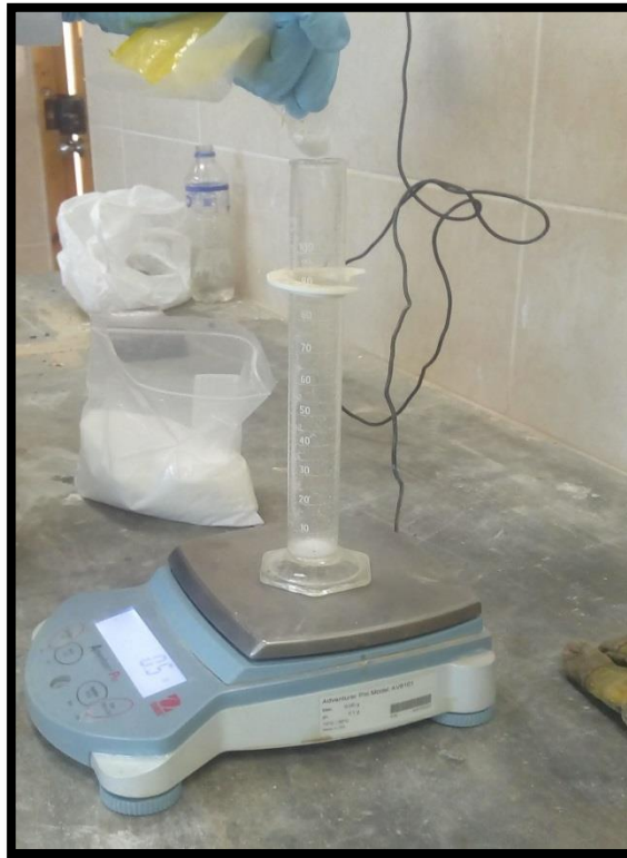
Foto N° 09. Medición del peso del floculante comercial (ECOPOL CS 600).
