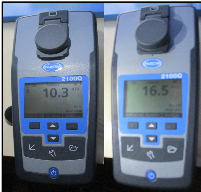
Foto N° 22. Turbidez final del agua en las 2 pruebas del segundo ensayo haciendo uso del ECOPOL CS 600 floculante comercial.
