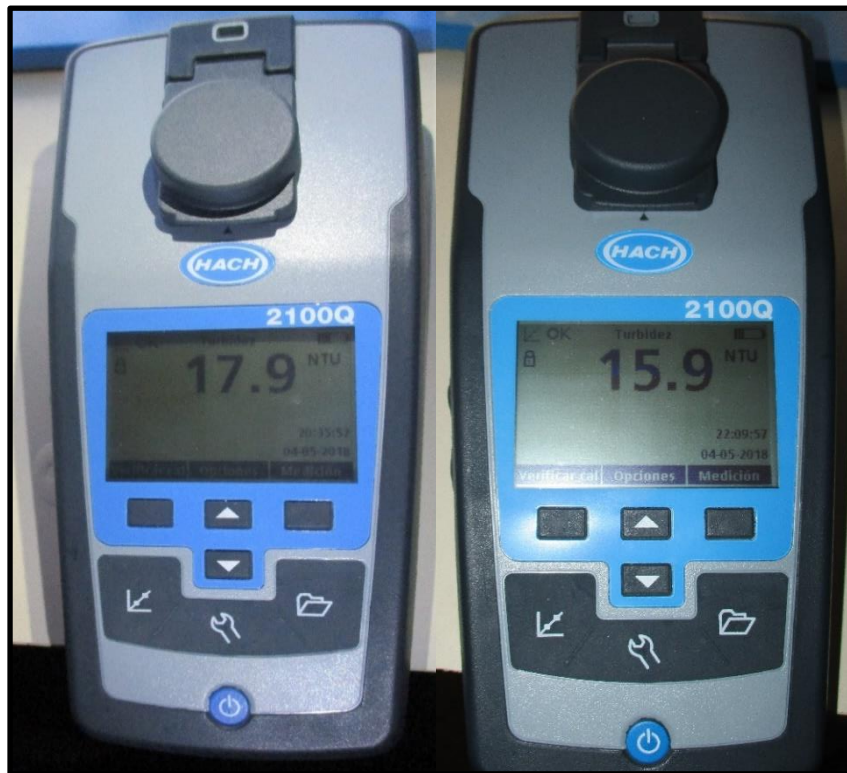
Foto N° 23. Turbidez final del agua en las 2 pruebas restantes del segundo ensayo haciendo uso del ECOPOL CS 600 floculante comercial.
