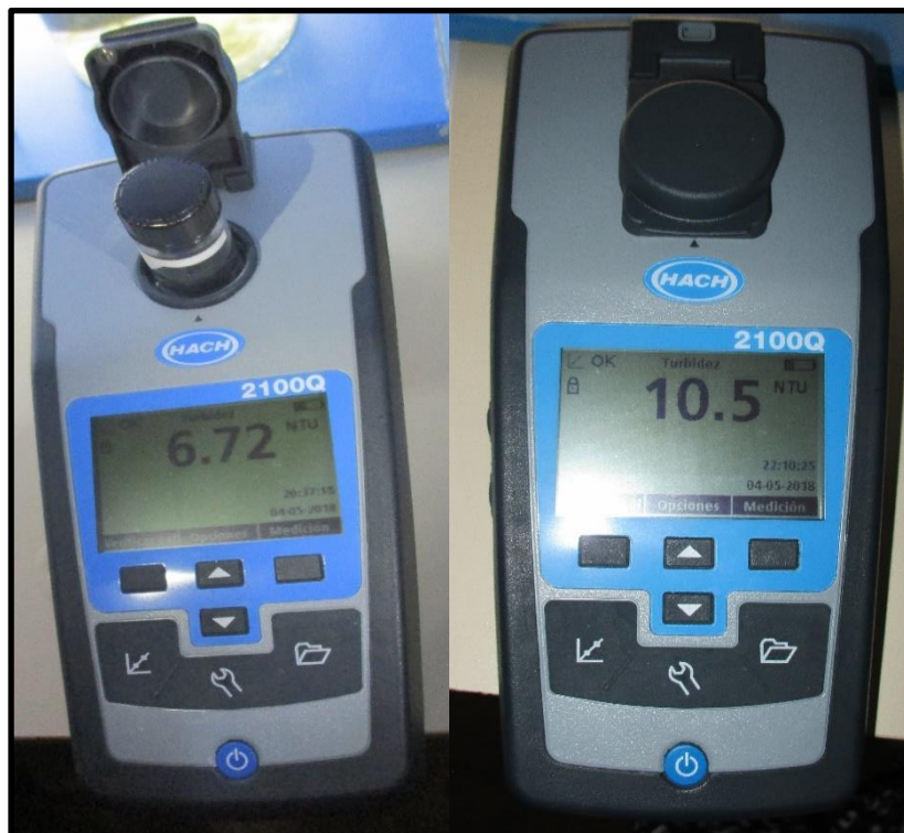
Foto N° 18. Turbidez final del agua en las 2 pruebas restantes del segundo ensayo haciendo uso la Paleta de Tuna como floculante natural.
