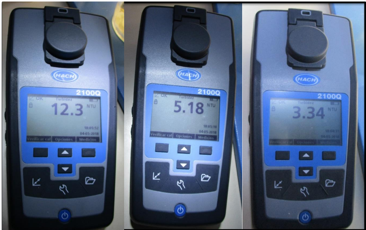
Foto N° 15. Turbidez final del agua en las 3 pruebas del primer ensayo haciendo uso la Paleta de Tuna como floculante natural.
