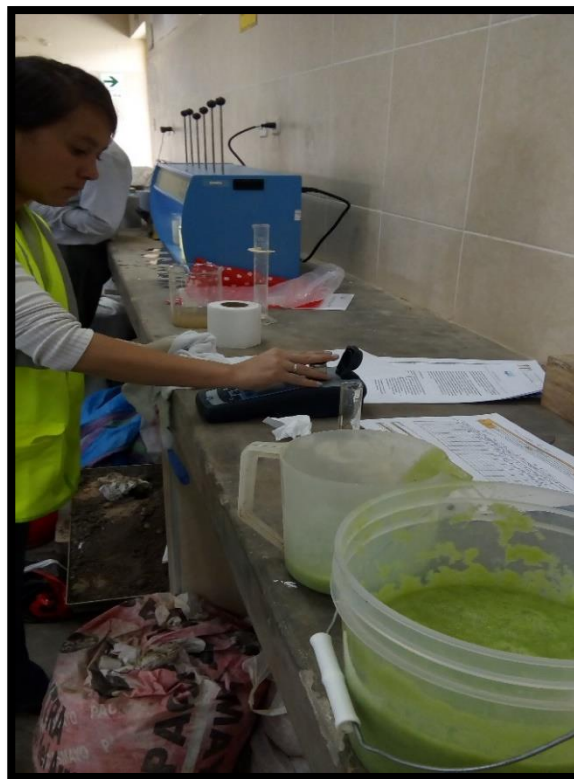
Foto N° 14. Medición de las Unidades Nefelométricas de Turbidez en el Turbidímetro (Equipo)
