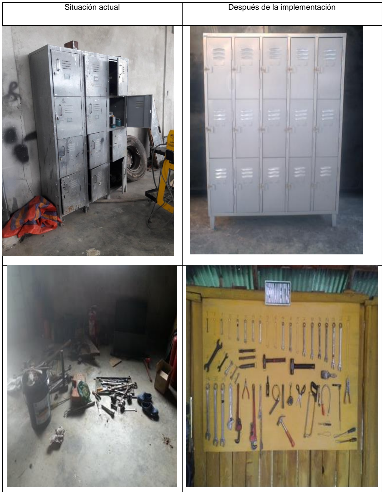
Figura n° 59: Antes y después de implementar la segunda "S"
