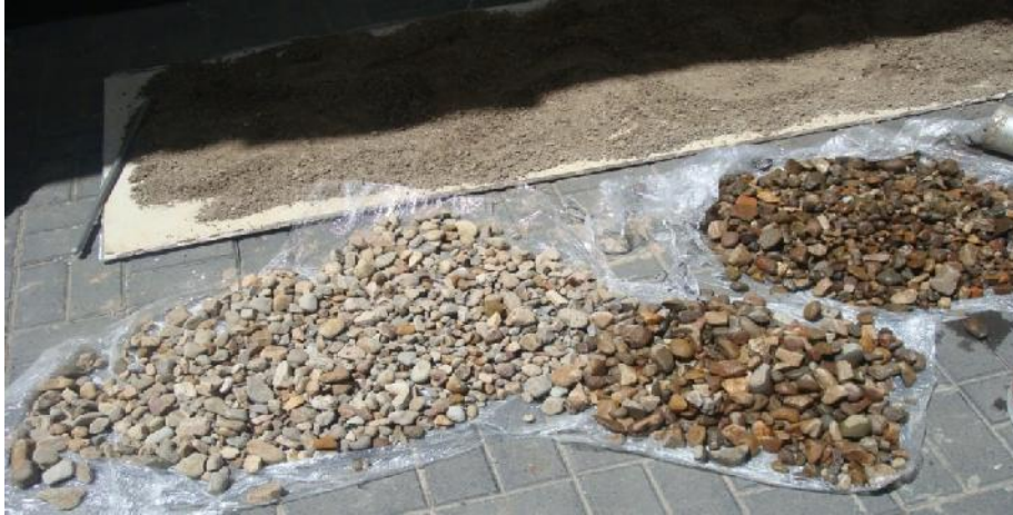
Figura N° 18: Agregado de cantera río, preparación para ensayos
