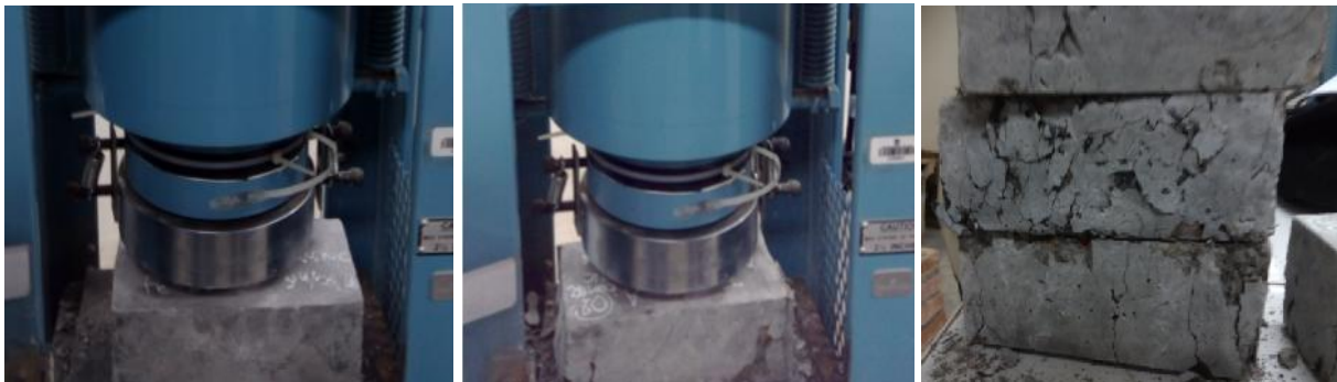
Figura N° 94, 95 y 96: Ensayo a Compresión realizados
