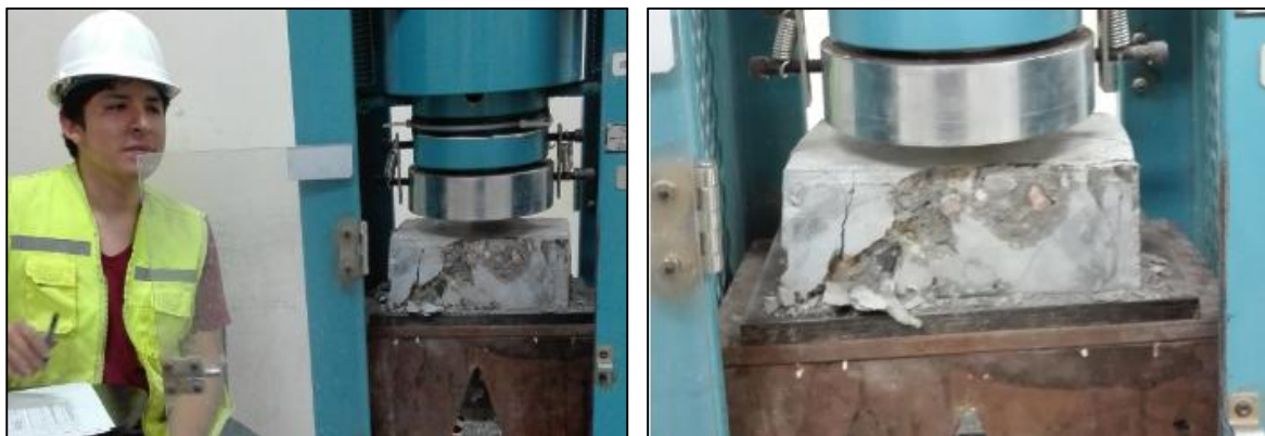
Figura N° 90 y 91: Ensayo de Compresión a los 3 Adoquín patrón F'c = 7 días
