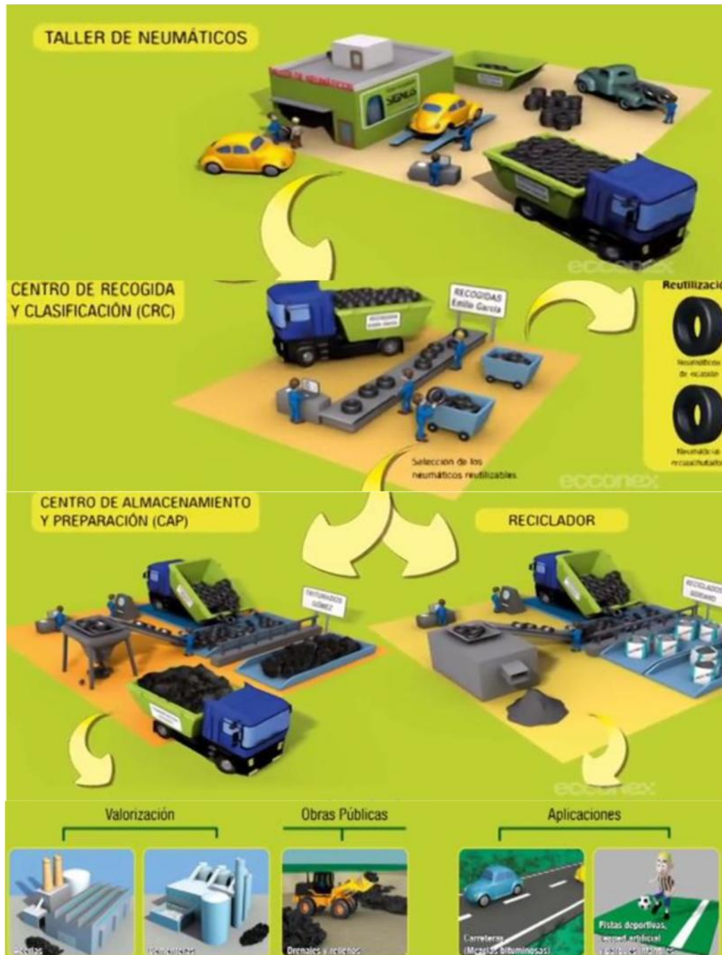
Figura N° 11. Proceso del reciclado del neumático.
