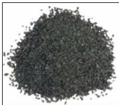
Figura N° 13: Granulometría 2,5 a 4 mm a utilizar en investigación
