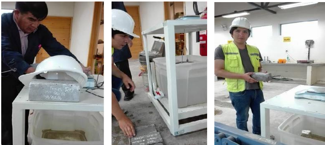
Figura N° 101, 102 y 103: Ensayo de absorción de los adoquines
