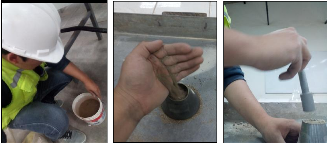
Figura N° 55, 56 y 57: Preparación de muestra y compactación de material
