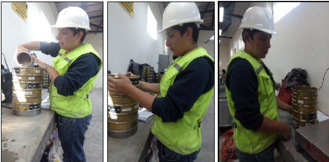
Figura N° 46, 47 y 48: Colocación, agitación y pesado de agregado fino
