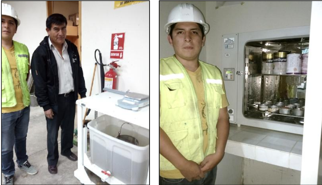
Figura N° 32 y 33: Proceso de secado y pesado en aire a condición
