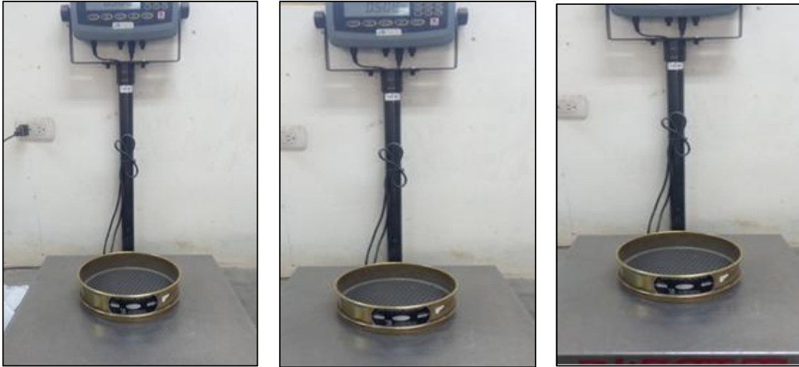
Figura N° 21, 22 y 23: Pesado de los mallas del ensayo granulométrica
