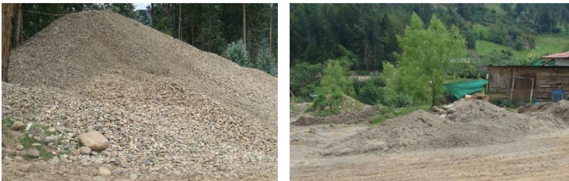
Figura N° 16 y 17: Agregado grueso y fino respectivamente
