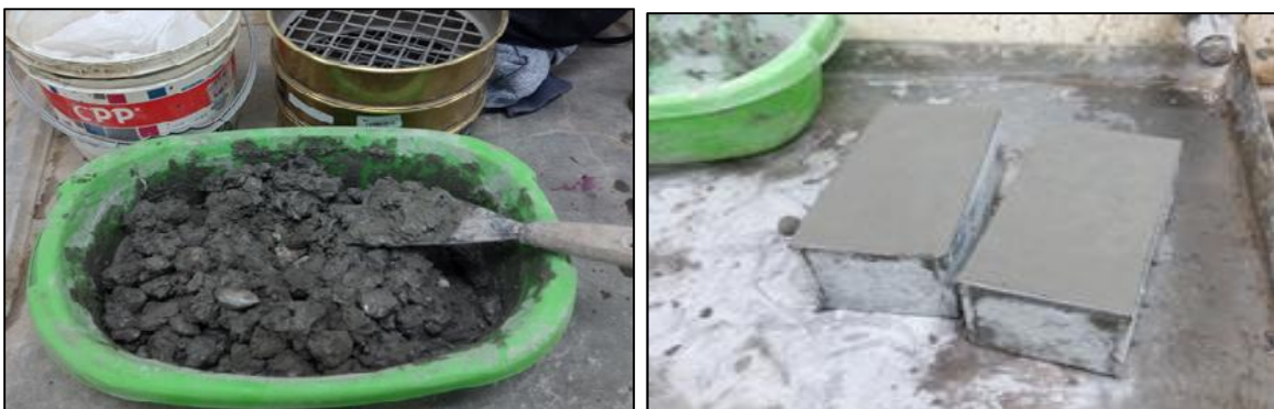
Figura N° 69 y 70: Elaboración de adoquines Patrón f'c = 7 días
