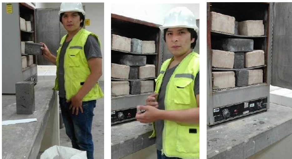
Figura N° 104, 105 y 106: Ensayo de absorción de los adoquines
