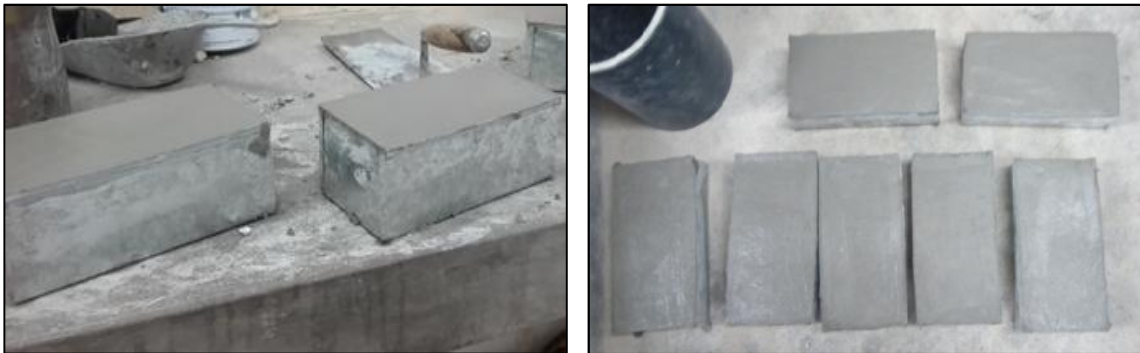
Figura N° 73 y 74: Realización de adoquines patrón f'c = 28 días
