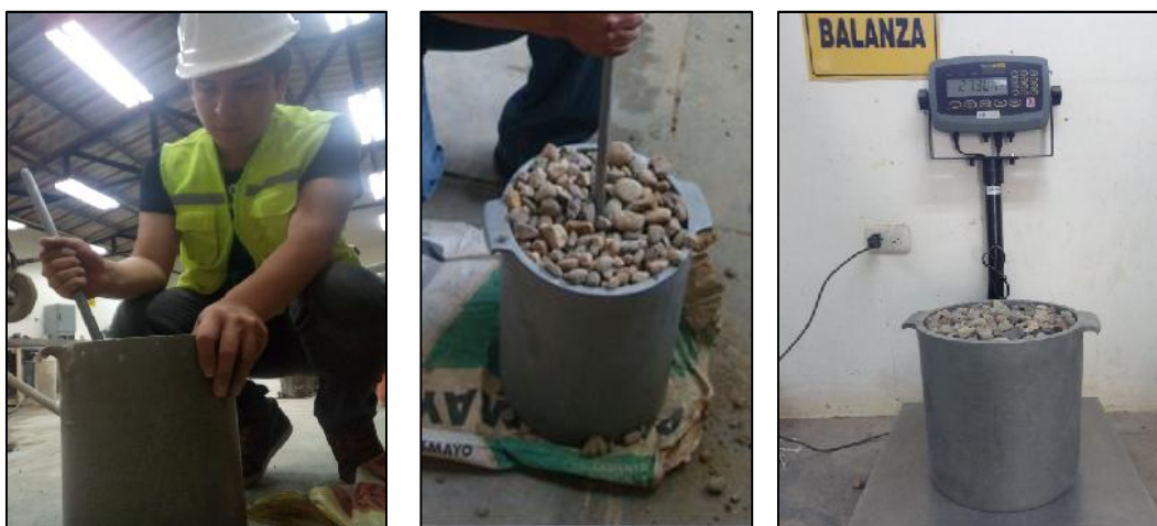
Figura N° 39, 40 y 41: Compactación y pesado del molde con muestra
