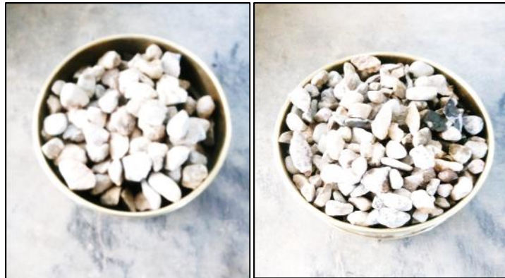
Figura N° 24, 25: Agregado Retenido en las mallas de, 1/2" y 3/8" respectivamente.
