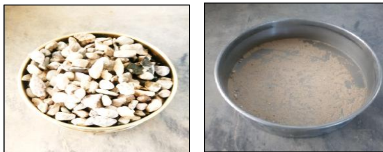
Figura N° 26 y 27: Agregado Retenido en las mallas de N°04 y cazoleta respectivamente.
