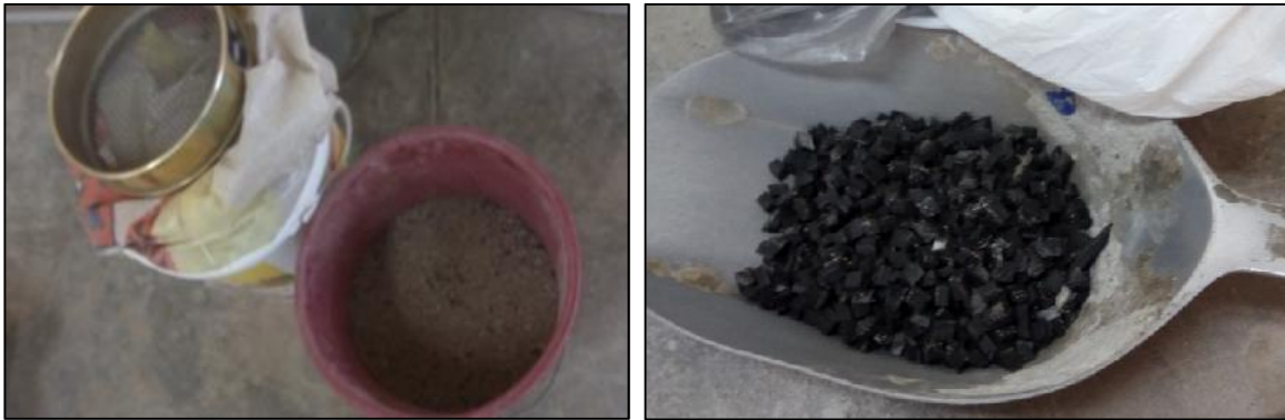
Figura N° 81 y 82: Proporciones a utilizar para adoquines con caucho
