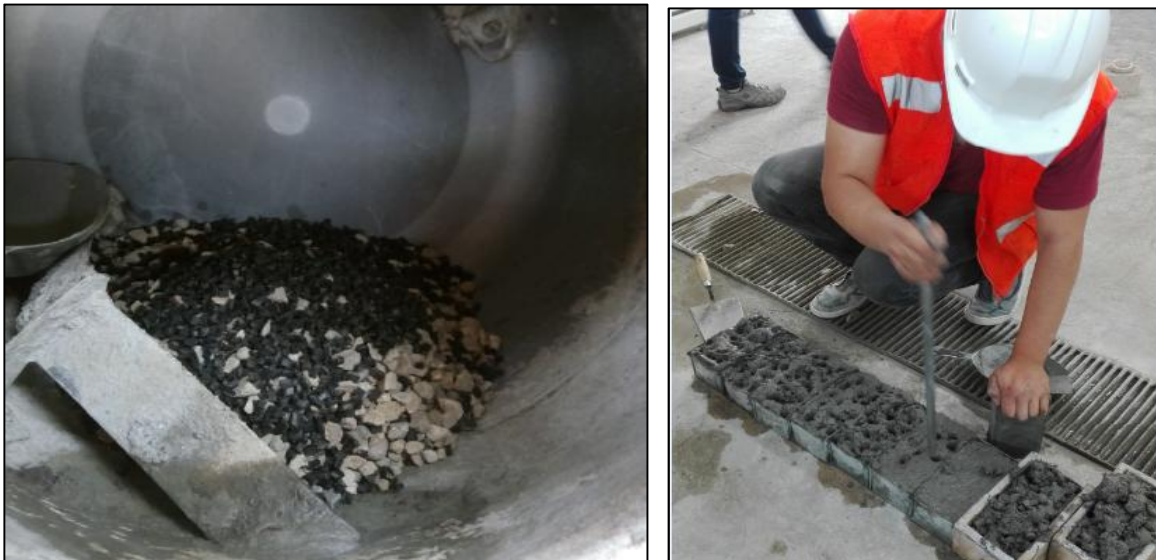
Figura N° 83 y 84: Mezcla y colocación en moldes para adoquines
