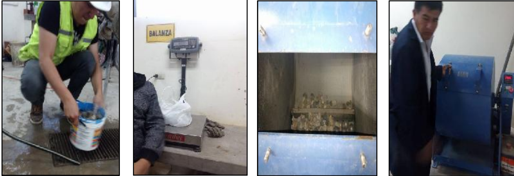
Figura N° 42, 43, 44 y 45: Preparación para Ensayo de abrasión de los ángeles
