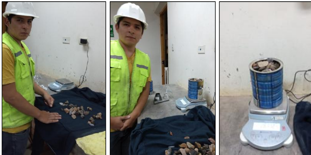
Figura N° 29, 30 Y 31: Proceso de secado y pesado en aire a condición
