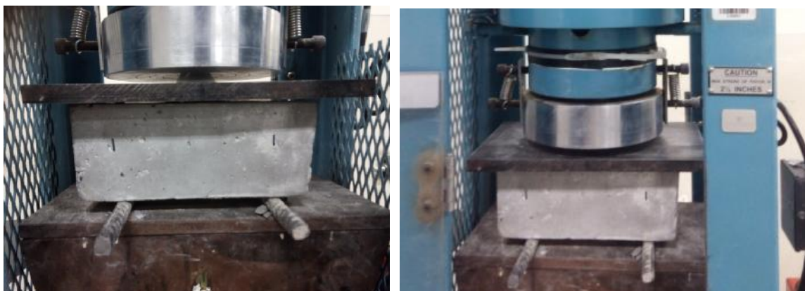
Figura N° 97 y 98: Ensayo a flexión realizada
