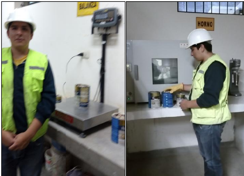
Figura N° 34 y 35: Pesado del agregado y secado en el horno
