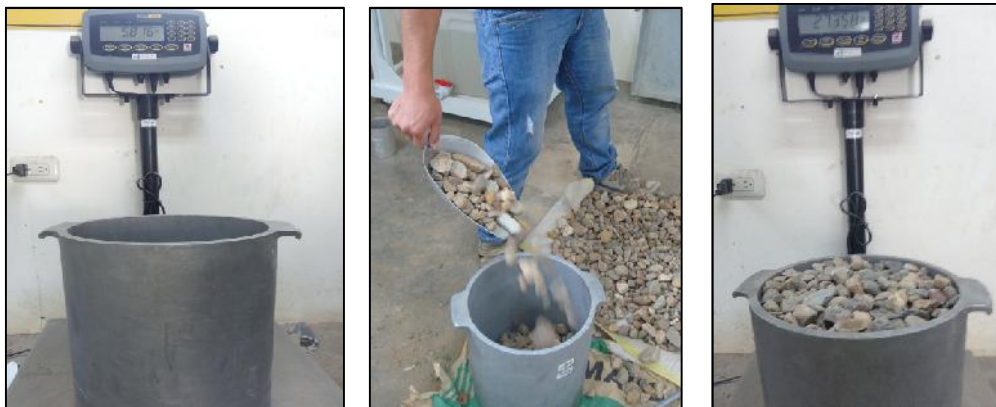
Figura N° 36, 37 y 38: Pesado del molde vacío, y peso con muestra
