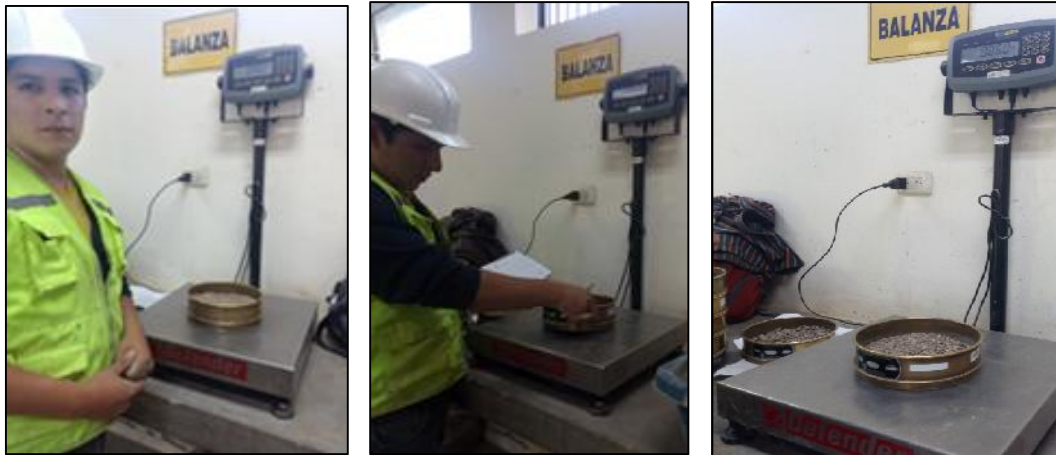
Figura N° 49, 50 y 51: Pesado de las mallas con agregado fino
