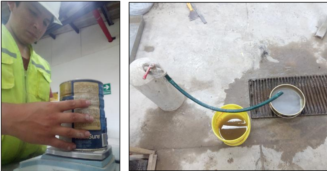
Figura N° 64 y 65: Preparación de muestra para lavado de material
