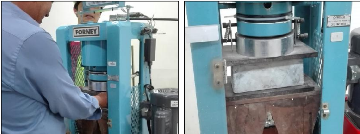
Figura N° 87, 88 y 89: Resultados de ensayo a compresión de adoquines Patrón f'c = 07 días
