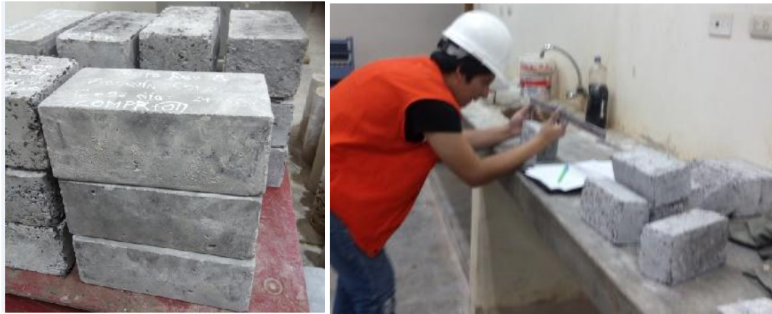
Figura N° 92 y 93: Preparación y medición de adoquines
