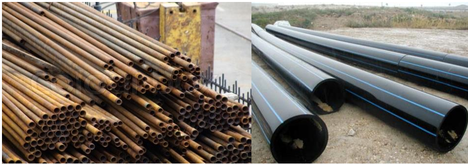
Figura 25. Fotografías de tuberías oxidadas y tuberías de pvc en el exterior del almacén Fuente: Área de almacén de Camposol S.A
