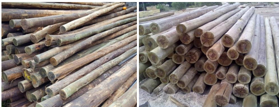
Figura 26. Fotografías de postes de eucalipto deteriorados Fuente: Área de almacén de Camposol S.A
