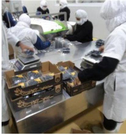
Figura 28. Fotografía del proceso del control del peso de cada clamshell Fuente: Área de sistema de gestión de la calidad de Camposol S.A.
