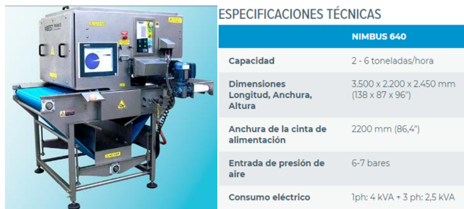
Figura 39. Fotografía de la clasificadora automática Nimbus 640 Tomra y de sus especificaciones Fuente: Tomra
