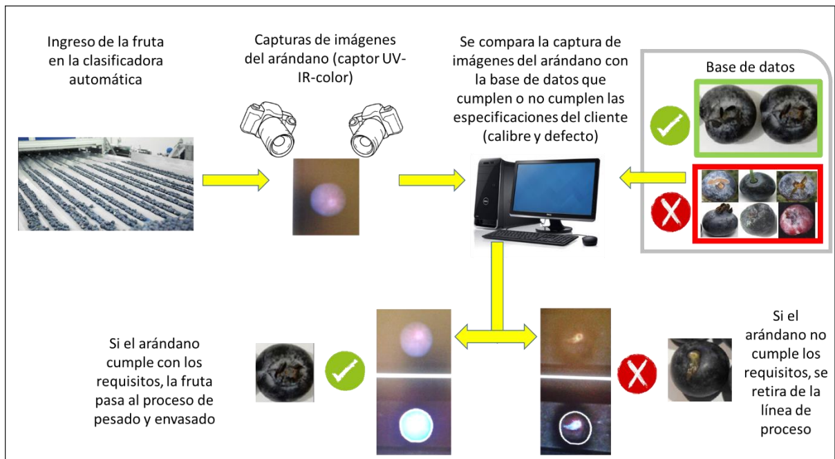
Figura 37. Esquema del proceso de clasificación e calibración automatizado
